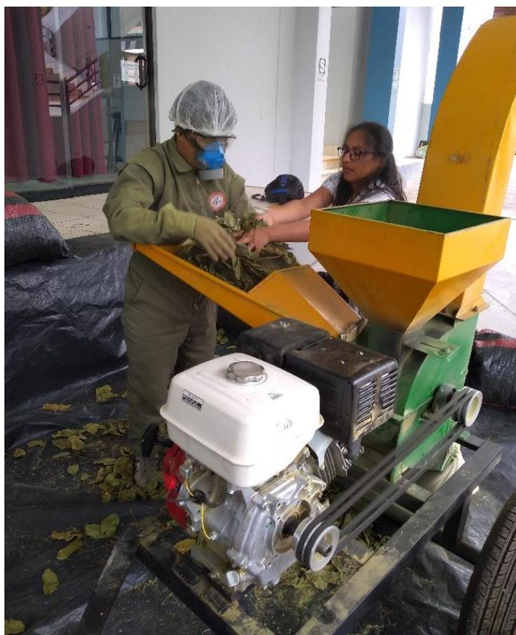
Figura 6. Picadora desintegradora de martillo para la molienda de forrajes
