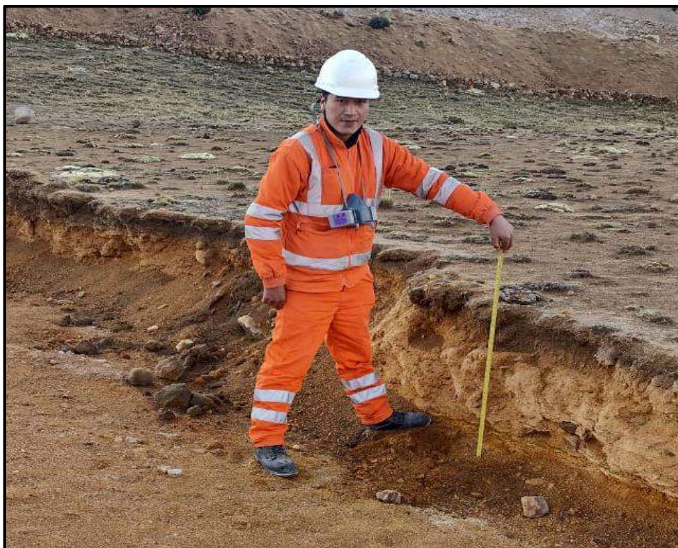
Figura 18 — Medición de la estratigrafía del suelo
