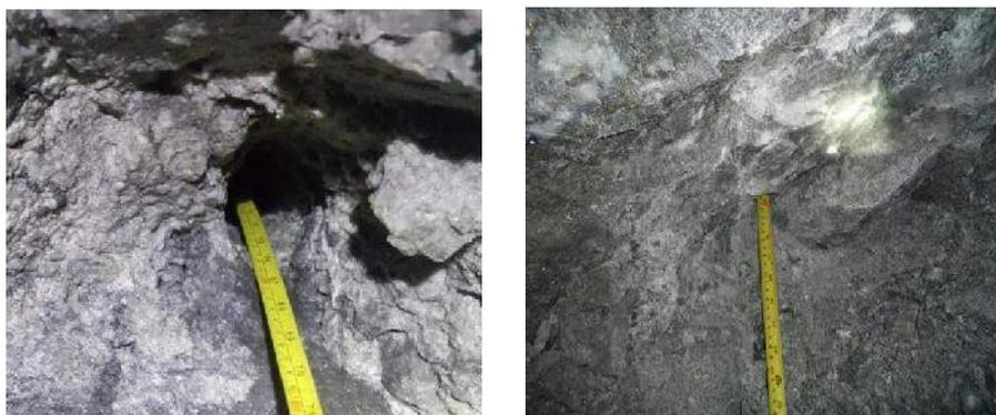
Figura 37 — Control de Longitud de Perforación (Promedio de 3.85 m)
