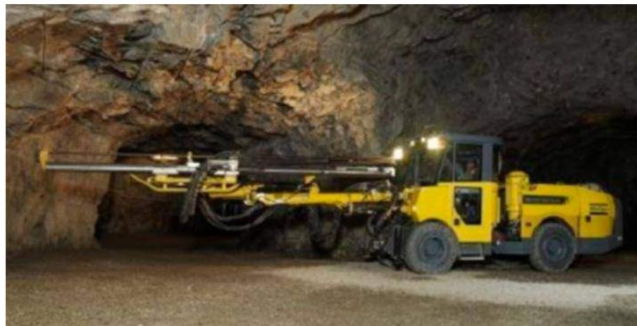
**Figura 26 — Jumbo Electro Hidráulico Rocket Boomer 282**
