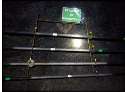
**Figura 8 — Juego de Barretillas para el Desatado de Rocas en la Rampa.**
