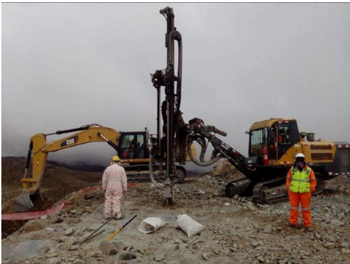
**Figura 20 — Perforación y voladura en cantera de rocas**
