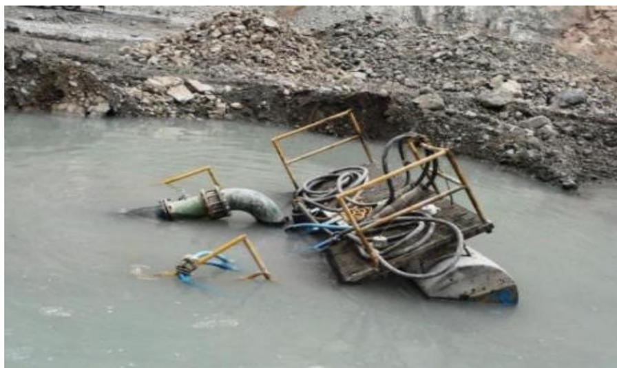
**Figura 19 — Bomba inclinada**
