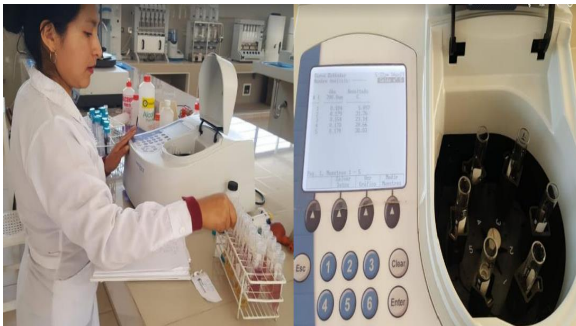
Figura 20 — Lectura de absorbancia de las muestras en espectrofotómetro
