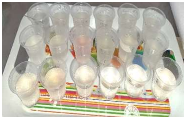
Figura 34 — hidratación de muestras para el análisis de consistencia del polvo de endospermo de semillas de tara
