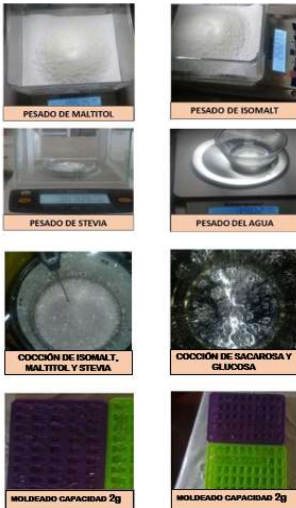
Figura 11 — Proceso de elaboración de caramelos duros con Stevia, Maltitol e Isomalt
