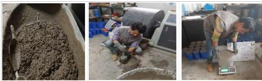
**Figura 25 — Prueba de masa unitario en estado fresco del concreto**
