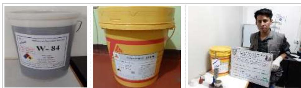
**Figura 20 — Aditivo Superplastificante Sikament-290N y Ulmén W-84**
