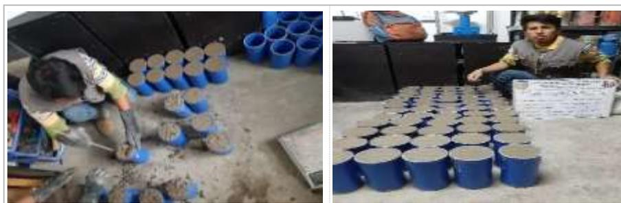
Figura 22 — Elaboración de especímenes normalizadas de 4" X 8"
