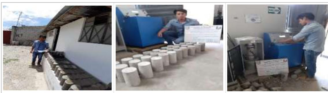
Figura 29 — Prueba de resistencia a compresion de probretas estandares de 4"x8"
