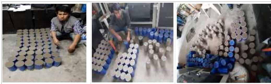
**Figura 27 —** Desmoldado y etiquetado de las probetas
