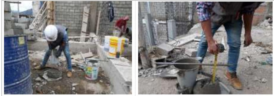
Figura 34 — Ensayo del asentamiento del concreto en la obra
