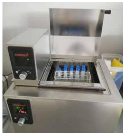
Figura 22 — Operación de calentamiento como parte del procedimiento de determinación de la solubilidad en agua del PML
