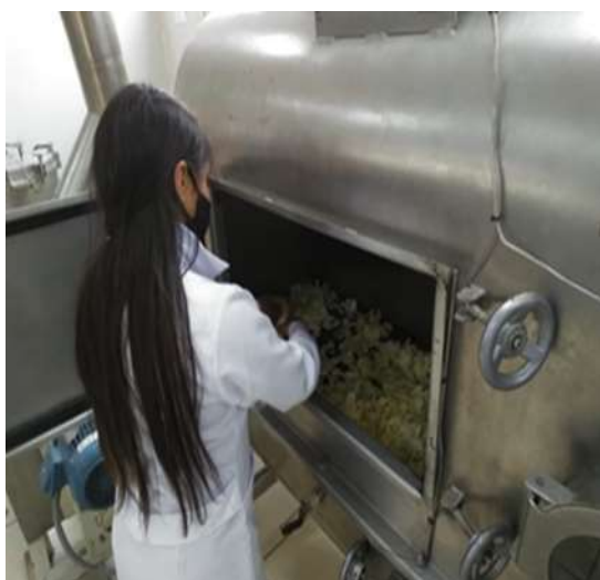
Figura 16 — Deshidratación del mesocarpo de limón por el método de convección forzada 1 (lecho fluidizado)
