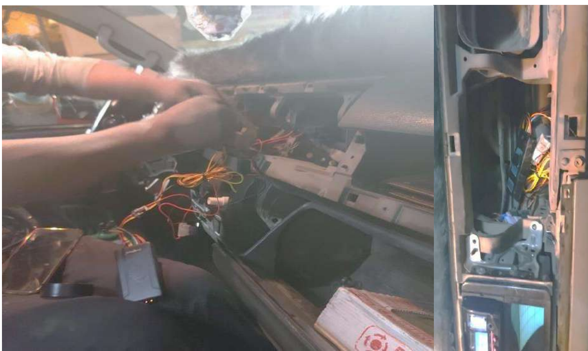
Figura 41 — Instalación del GPS ST-906W con SIM 968089538 al vehículo X1X-764
