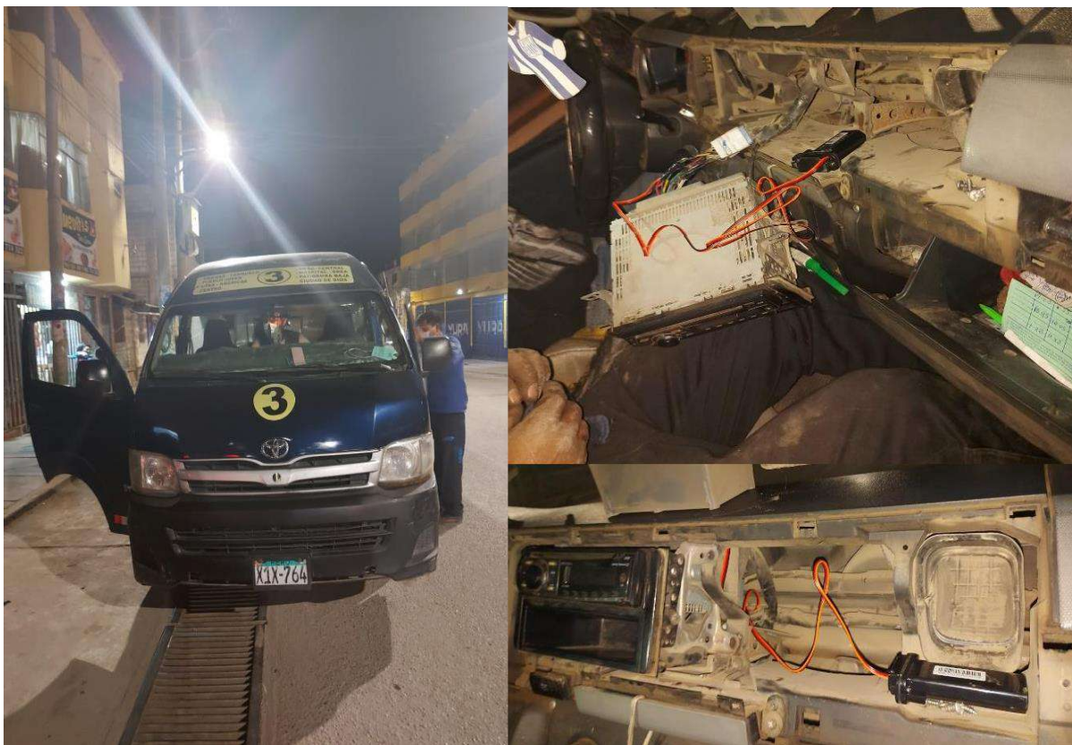
Figura 40 — Instalación del GPS ST-901 con SIM 968092286 al vehículo X3U-969
