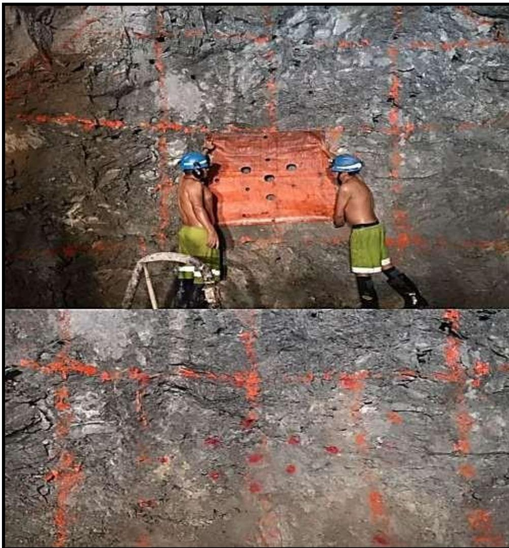
Figura 44 — Uso de plantilla para el marcado de taladros de arranque en CX2682
