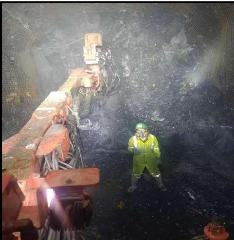
**Figura 49 — Perforación con jumbo en el CX 2682**
