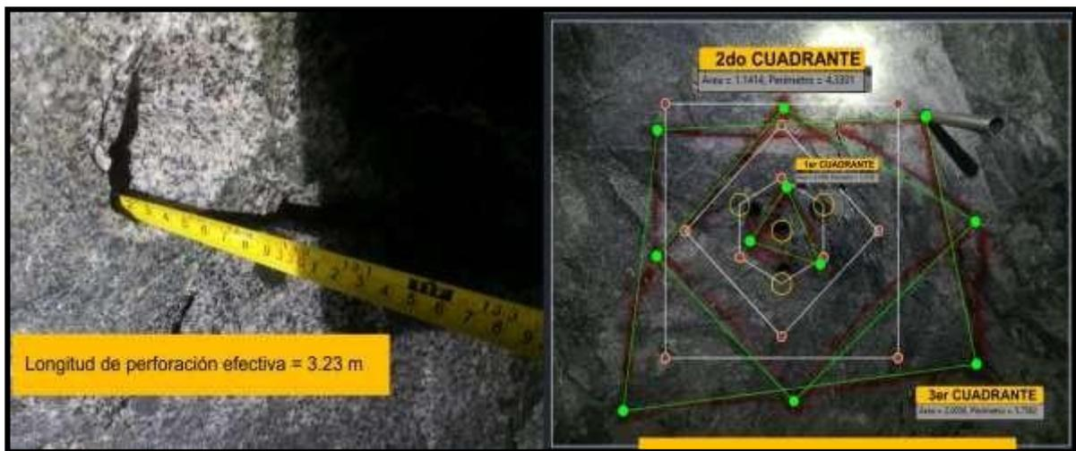
Figura 43 — Medición de taladros y desviación en los taladros de arranque en el CX2682
