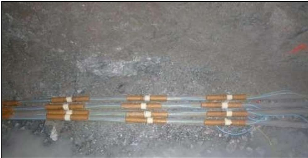
**Figura 24 — Elaboración de cargas espaciadas (cañas) para el recorte**
