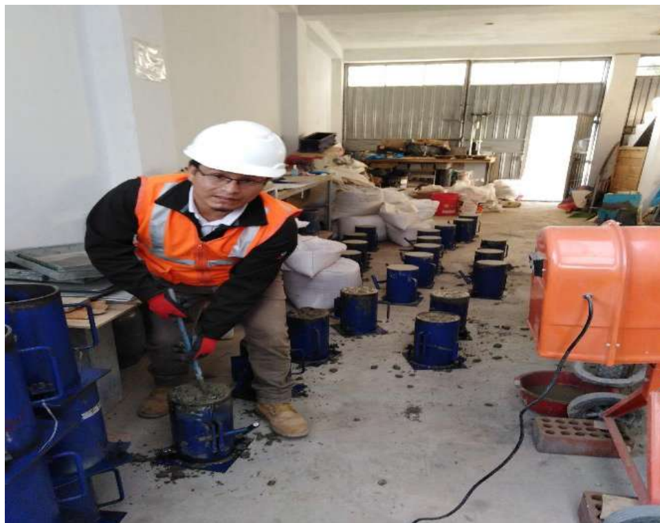
Figura 28 — Testigo para los ensayos de compresión
