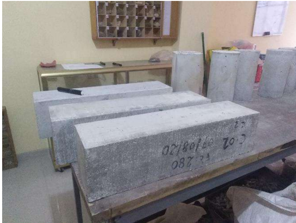
Figura 29 — Testigo para los ensayos de flexión
