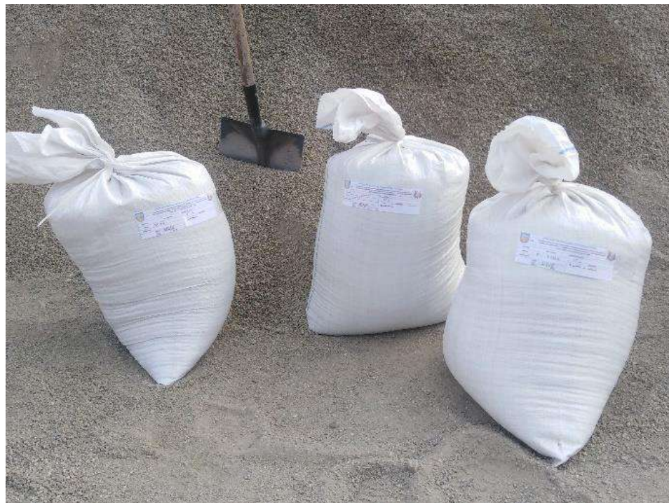
Figura 18 — Toma de muestras de agregado arena
