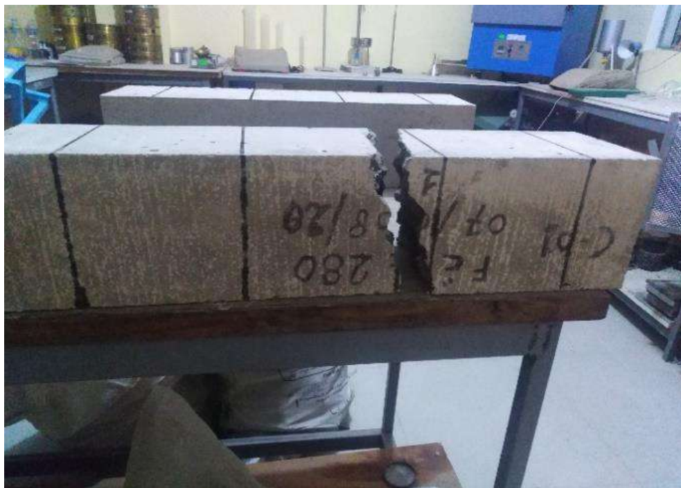
Figura 36 — Resultado al ensayo a la flexión de las vigas
