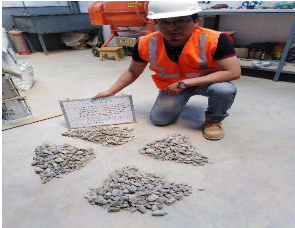
Figura 21 — Cuartero para el análisis granulométrico
