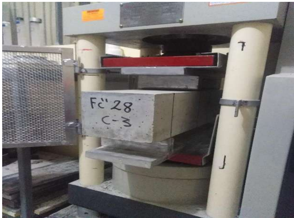
Figura 35 — Punto de falla a la flexión
