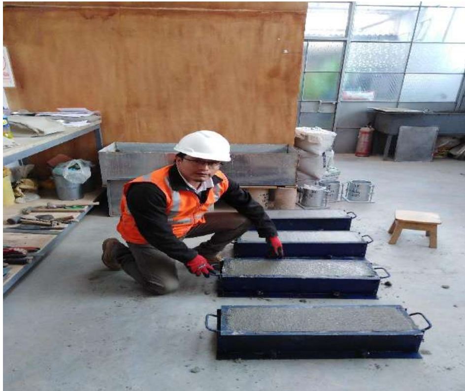
Figura 27 — Testigo para los ensayos de flexión
