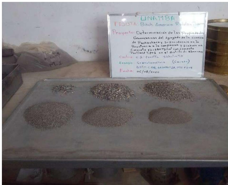
Figura 24 — Resultados del Análisis granulométrico del agregado fino
