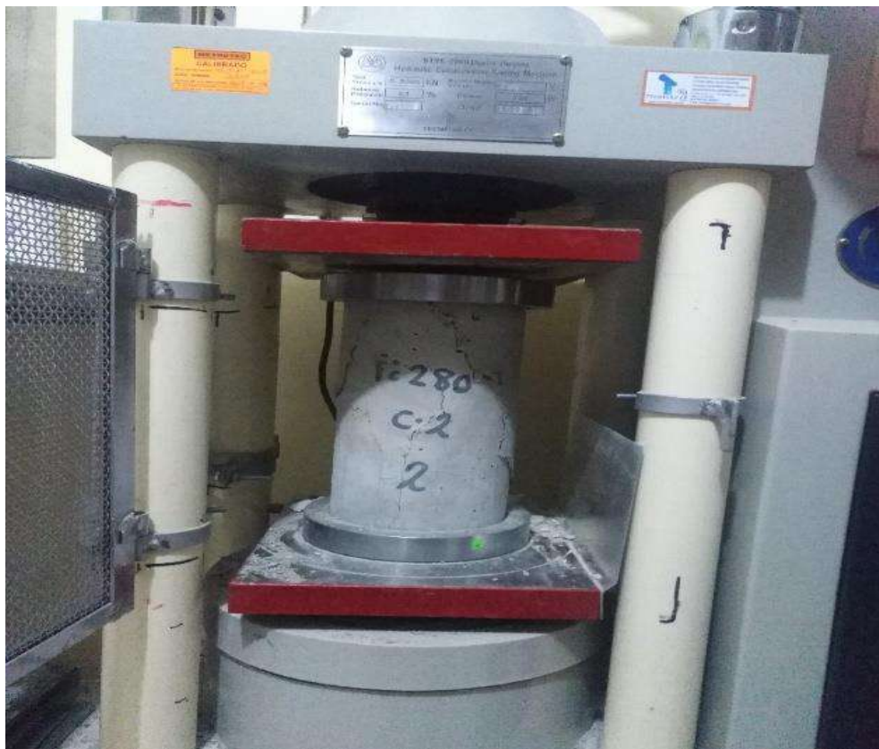
Figura 32 — Tipo de falla después del ensayo
