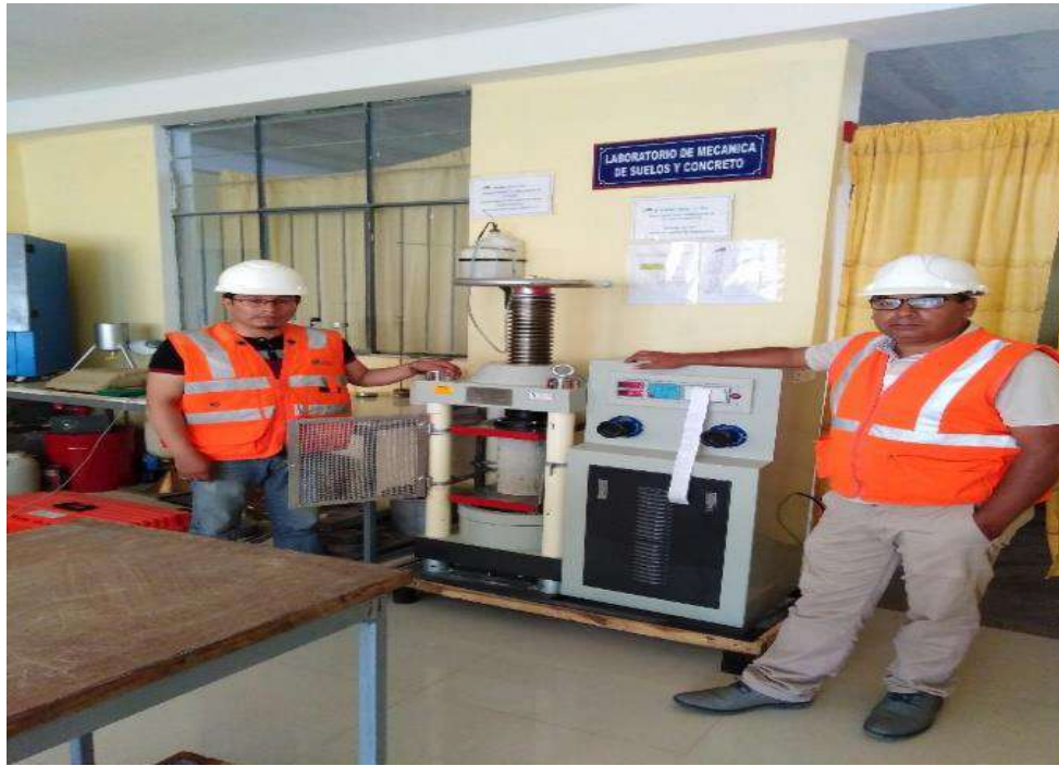
Figura 31 — Ensayo de compresión de briquetas de concreto
