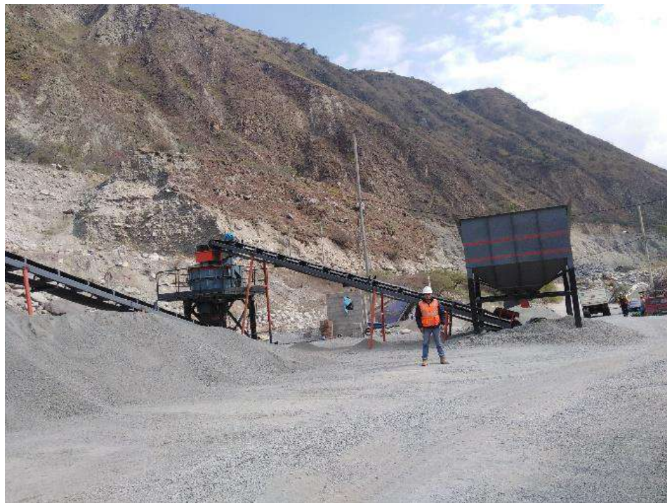
Figura 20 — Producción de agregado grueso
