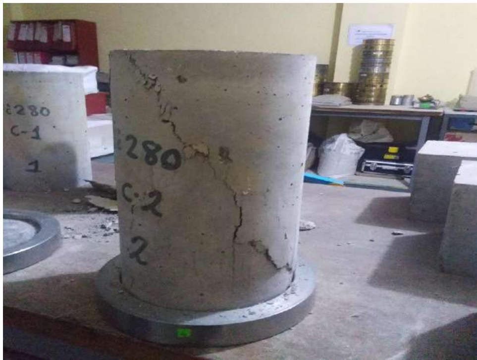
Figura 33 — Tipo de falla después del ensayo
