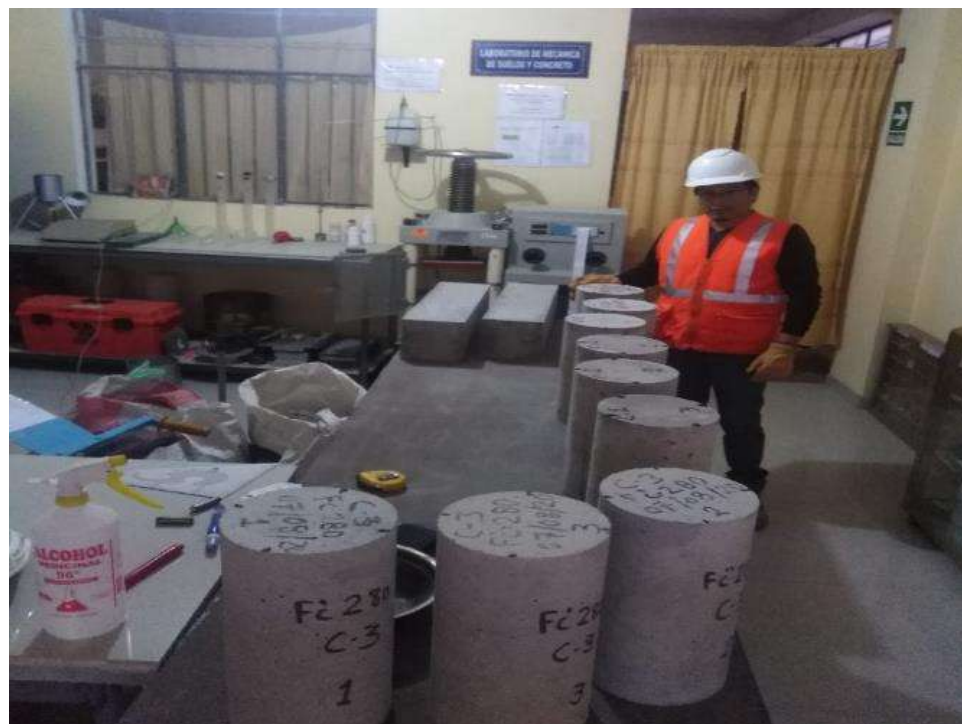
Figura 30 — Testigo para los ensayos de compresión
