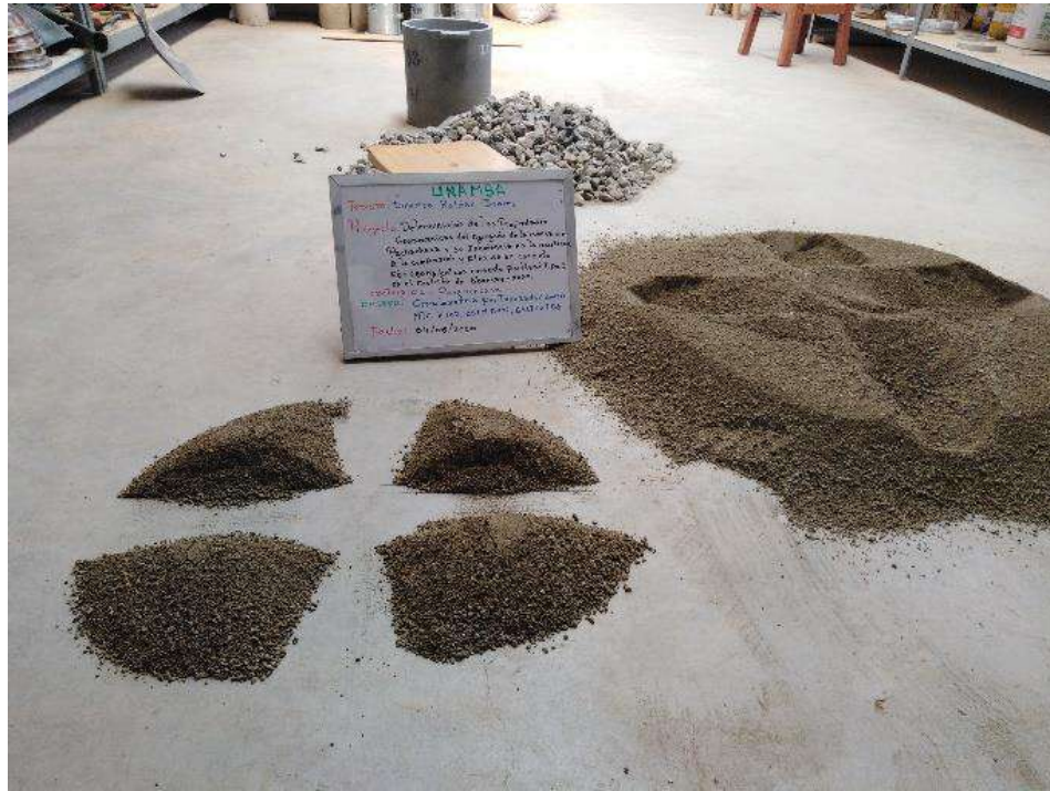
Figura 23 — Cuarteo del agregado grueso
