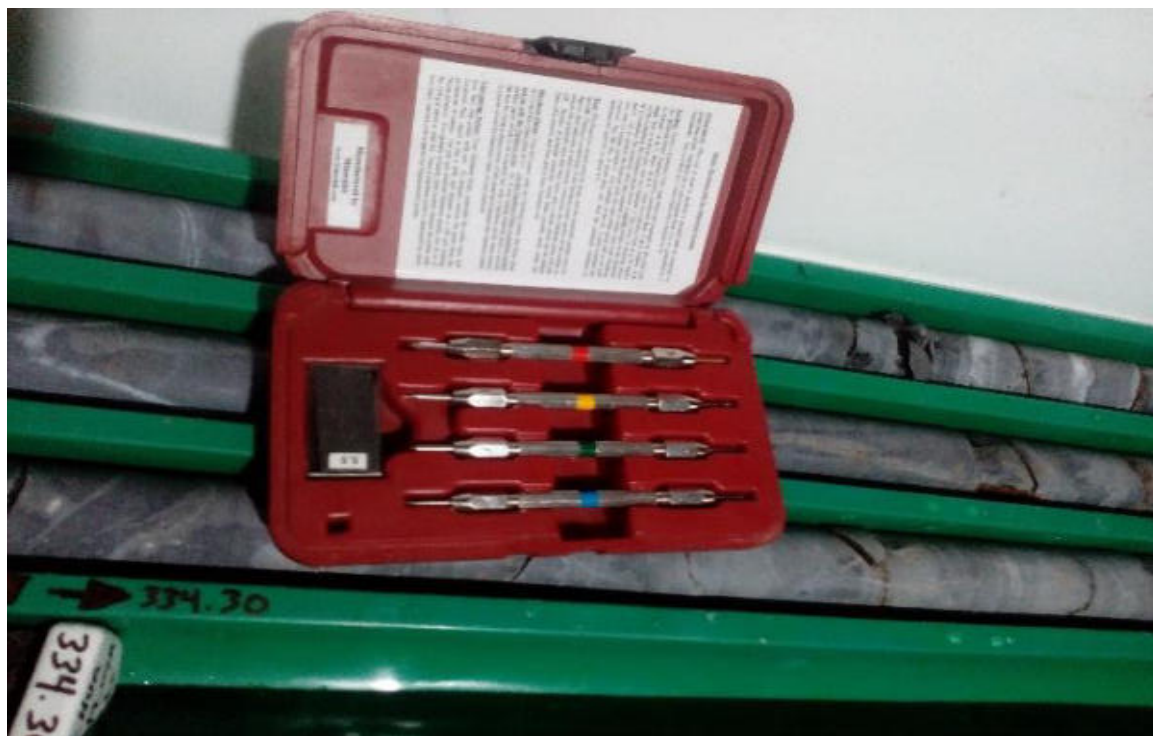
Figura 55 — Prueba de dureza de la roca en el sondaje E-HUA-10-19-02
