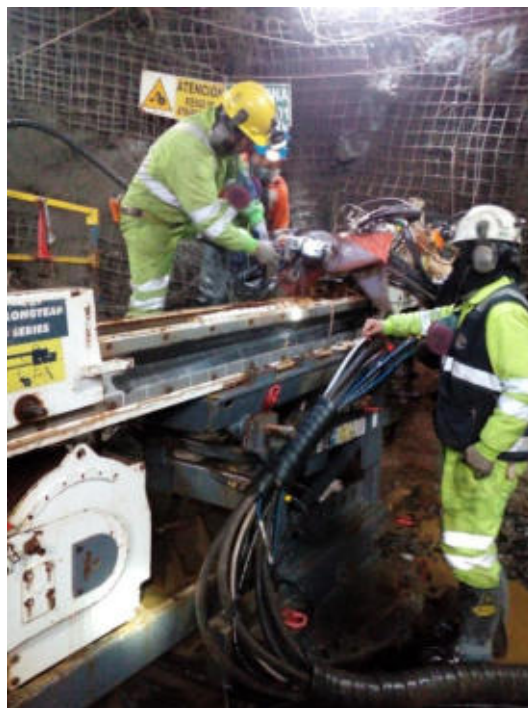
Figura 32 — Instalación del contometro para la medición del sondaje
