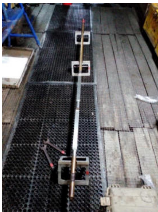
Figura 31 — Armado del equipo de medición Reflex Gyro
