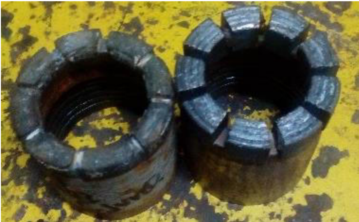
Figura 57 — Desgaste normal de las brocas NQ
