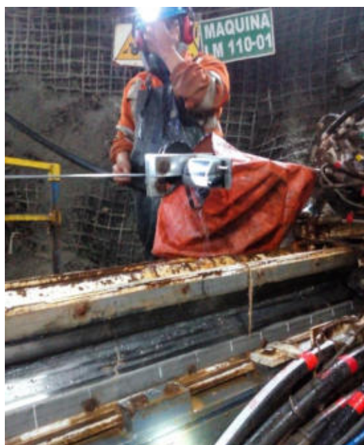
Figura 33 — Proceso de la medición verificando la distancia cada 5 metros en el contometro
