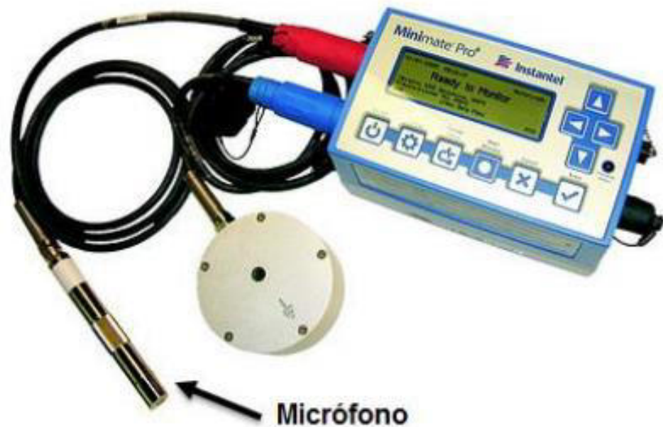
Figura 23 — Micrófono, equipo de monitoreo instantel
