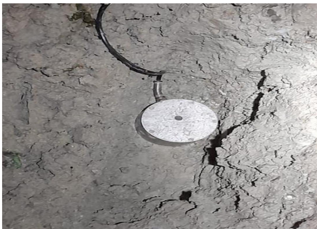
Figura 54 — Ubicación del transductor (geófono) antes de la voladura
