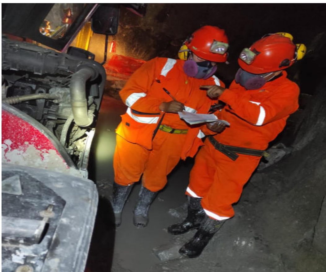
Figura 60 — Inspección de equipos antes de inicio de los trabajos – Check list
