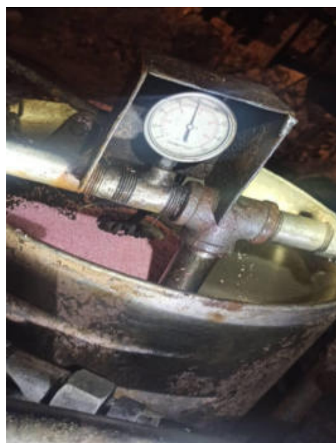
Figura 52 — Utilización del cargador de Anfo a 80 psi en el frente de trabajo
