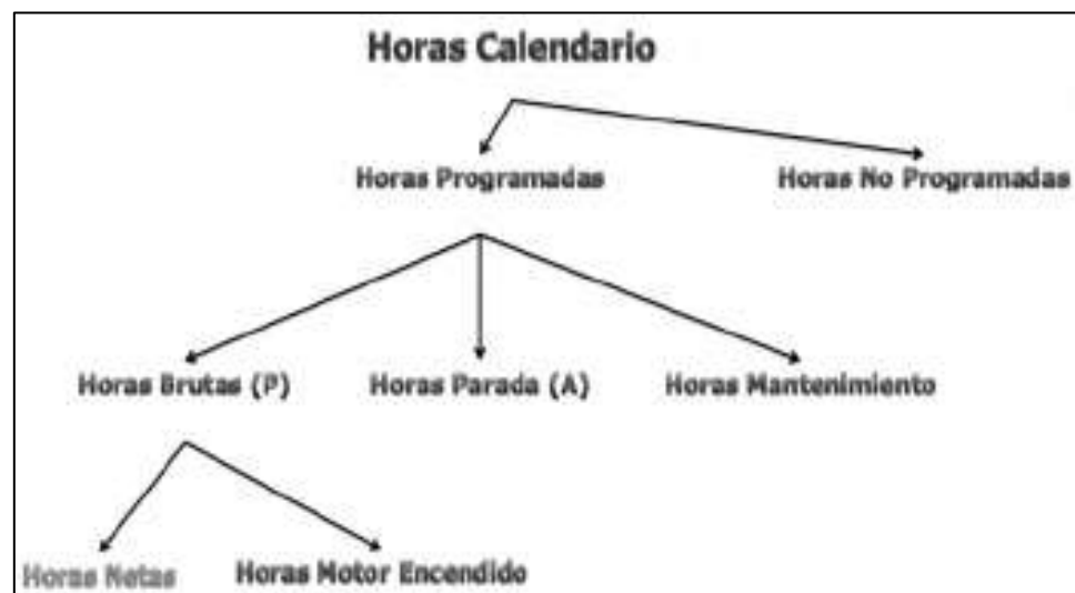
Figura 9 — Distribución de horas cronológicas de una Perforadora hidráulica
