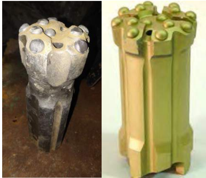
Figura 47 — Desgaste de la broca retráctil T-38 usadas en la perforación de taladros largos en roca dura.
