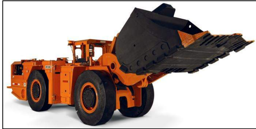
Figura 6 — Scoop de 2,2 yd 3 modelo JOY 4LD para limpieza en secciones angostas Extraído de manual de operación de komatsu
