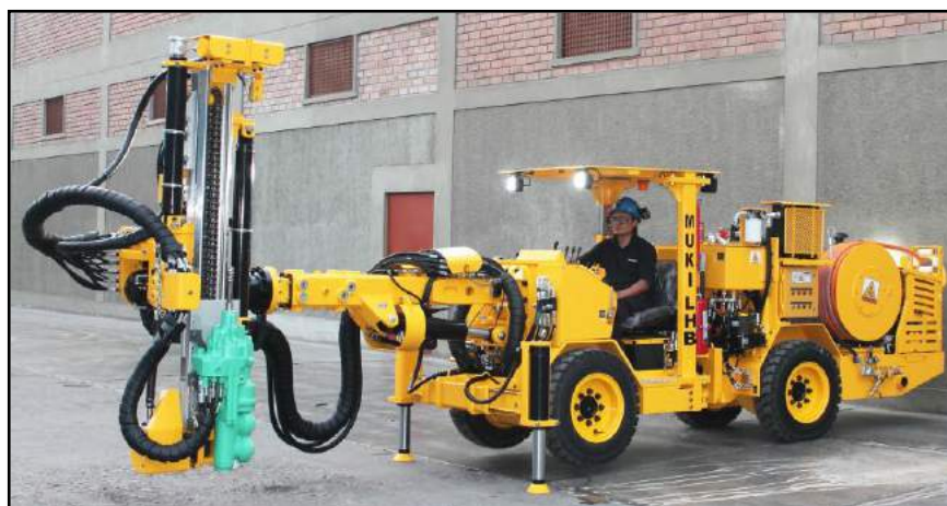
Figura 5 — Perforadora electrohidráulica para taladros largos MUKI LHB de RESEMIN
