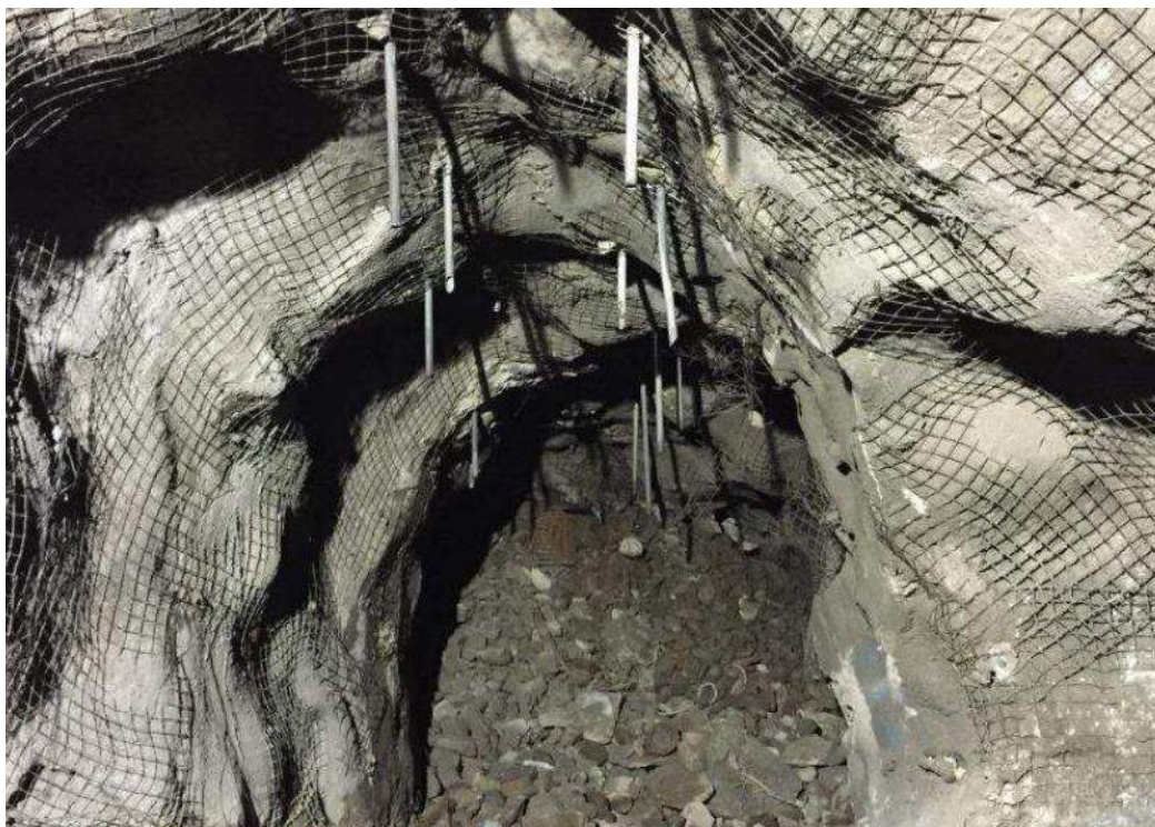
Figura 52 — Taladros perforados en negativo con sus respectivos tubos de PVC para evitar que se tapen los taladros.
