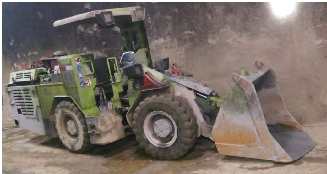
Figura 60 — scoop-tramp OVERPRAM de capacidad de 1.5 yd 3 para limpieza del tajo 395 de la sección V, de la zona baja.
