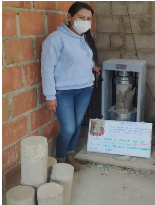
Figura 83 — Ensayo de resistencia a la compresión del concreto a los 28 días de rotura
