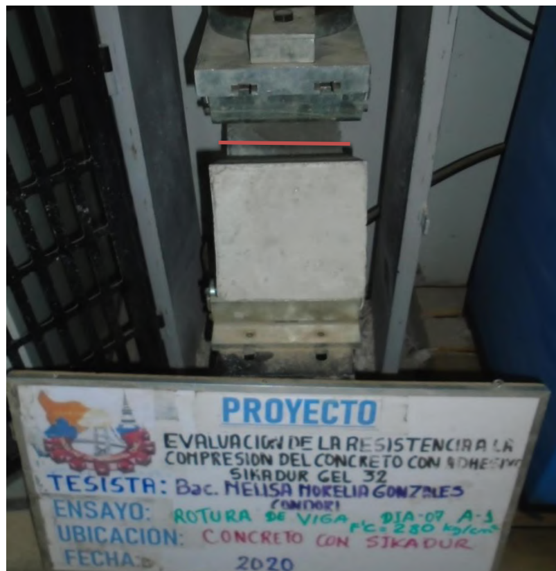
Figura 81 — Viga de concreto con adhesivo con falla en el tercio central
