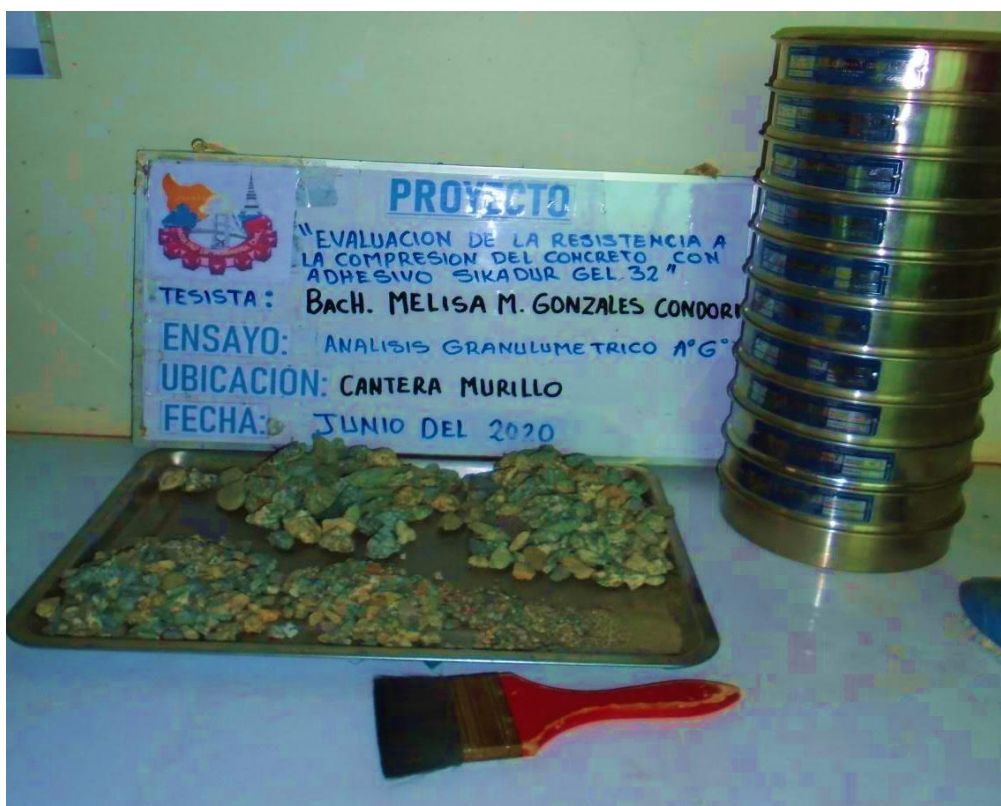
Figura 20 — Ensayo de análisis granulométrico del agregado grueso
