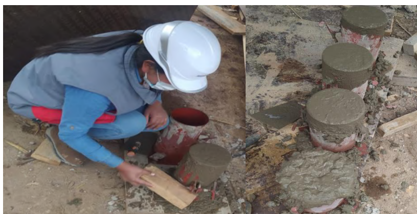
Figura 27 — Elaboración de briquetas
