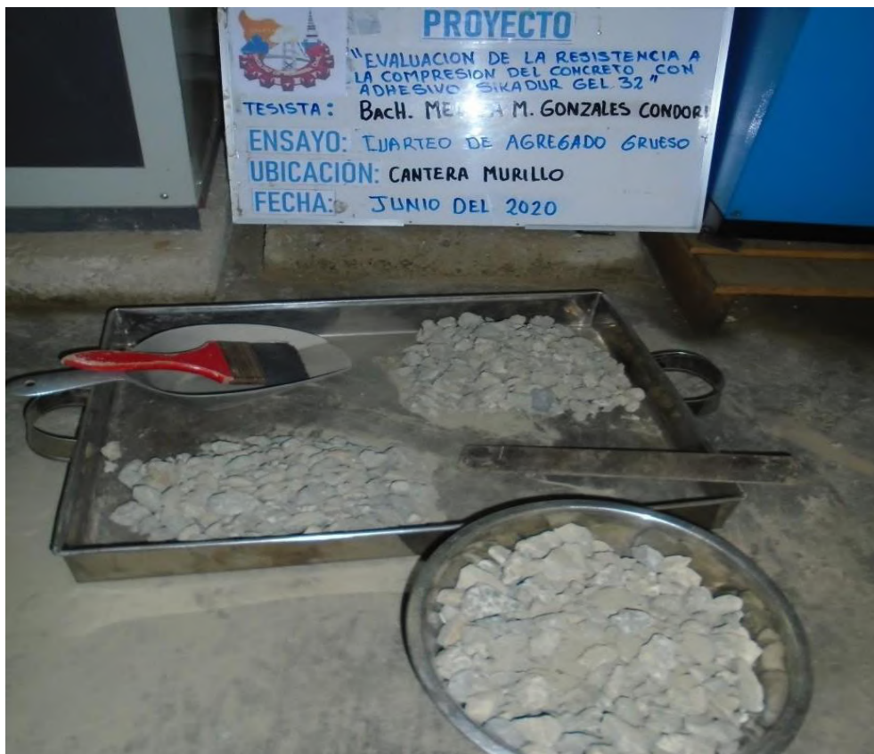
Figura 64 — Cuarteo del agregado grueso para el ensayo de granulometría
