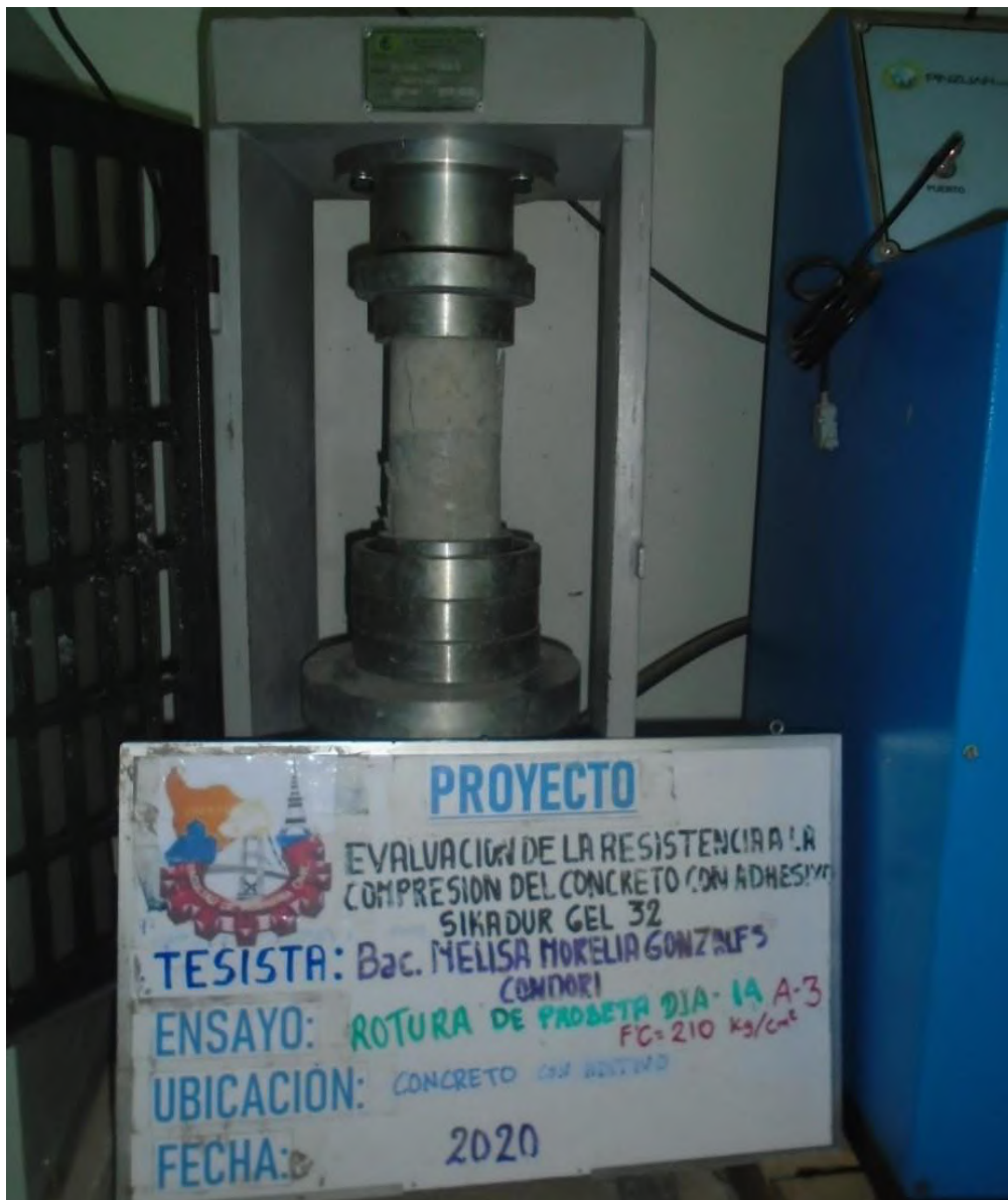
Figura 74 — Ensayo a la resistencia a la compresión del concreto unida a 0° grados con adhesivo sikadur gel 32.
