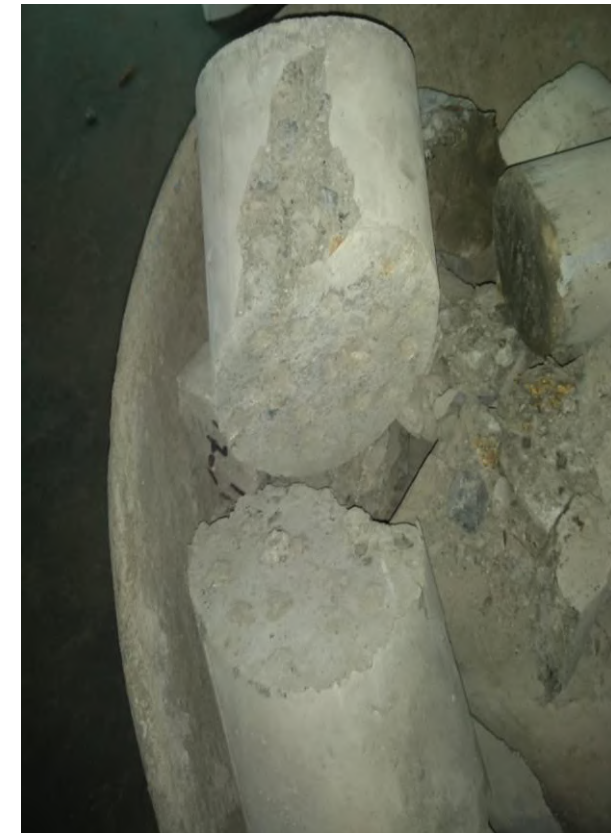
Figura 37 —Briquetas sin adhesivo (patrón) que fallaron por corte
