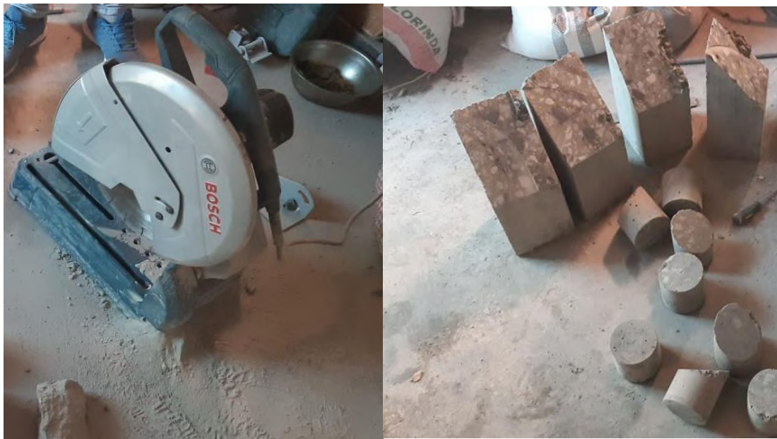
Figura 70 — Corte con amoladora para de concreto con ángulo de 45° y 0°
