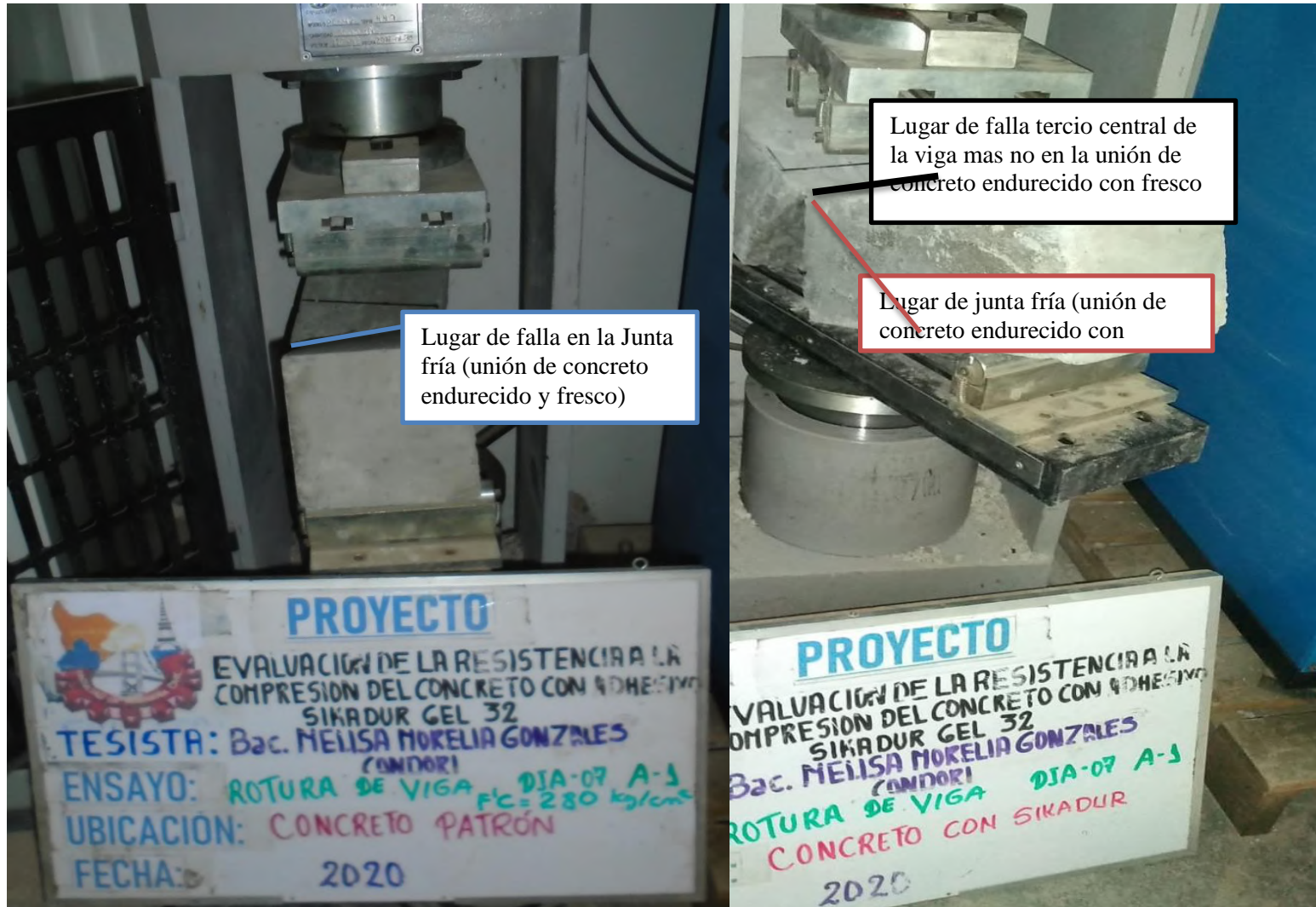
Figura 40 — Ubicación de fallas en vigas (Tercio central y junta fria del concreto con adhesivo y sin adhesivo)
