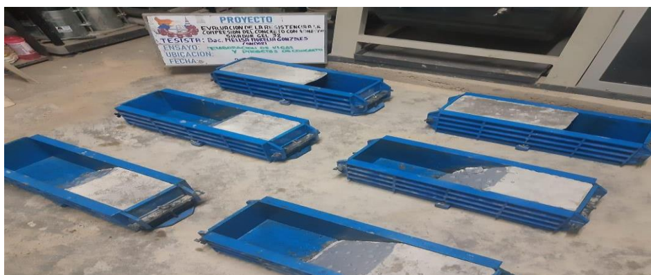
Figura 30 — Aplicación de adhesivo sikadur gel 32 en vigas a 0° Y 45 °
