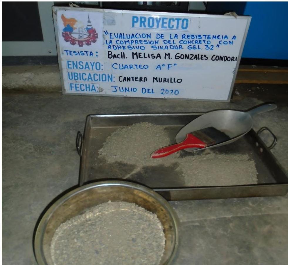
Figura 66 — Cuarteo del agregado fino para el ensayo de granulometría.
