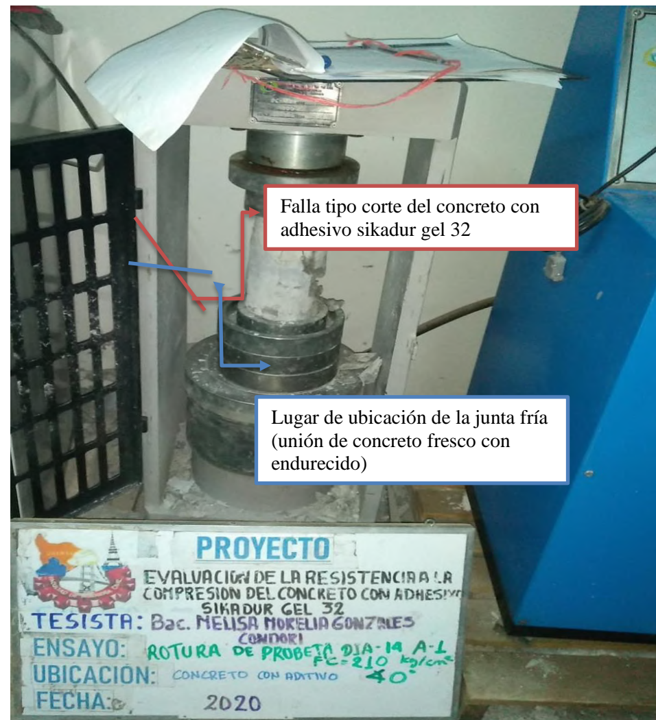
Figura 38 — Falla tipo corte en briquetas unidas con adhesivo sikadur gel 32
