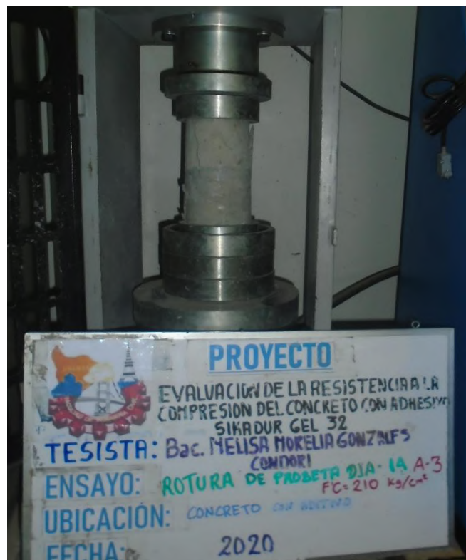
Figura 85 — Ensayo de resistencia a la compresión del concreto f'c=210 \text{ kg/cm}^2 con adhesivo, e a los 14 días de fraguado
