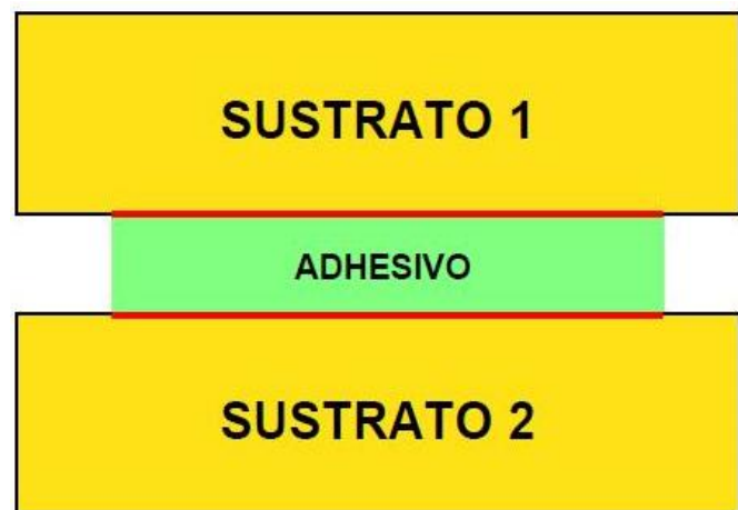
Figura 7 — Unión entre el concreto fresco y concreto Extraído en (Mario Madrid. Tecnología de la adhesión)
