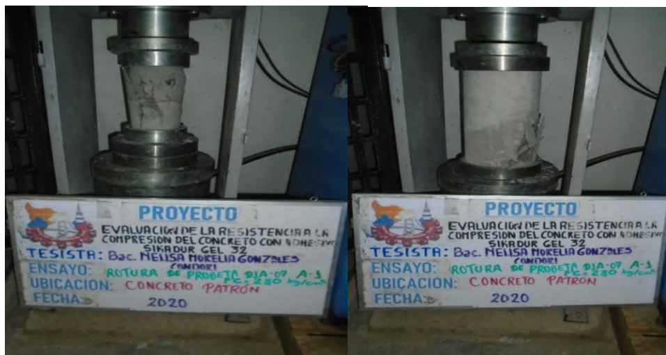
Figura 32 — Ensayo de resistencia a la compresión del concreto con adhesivo sikadur gel 32 y sin adhesivo
