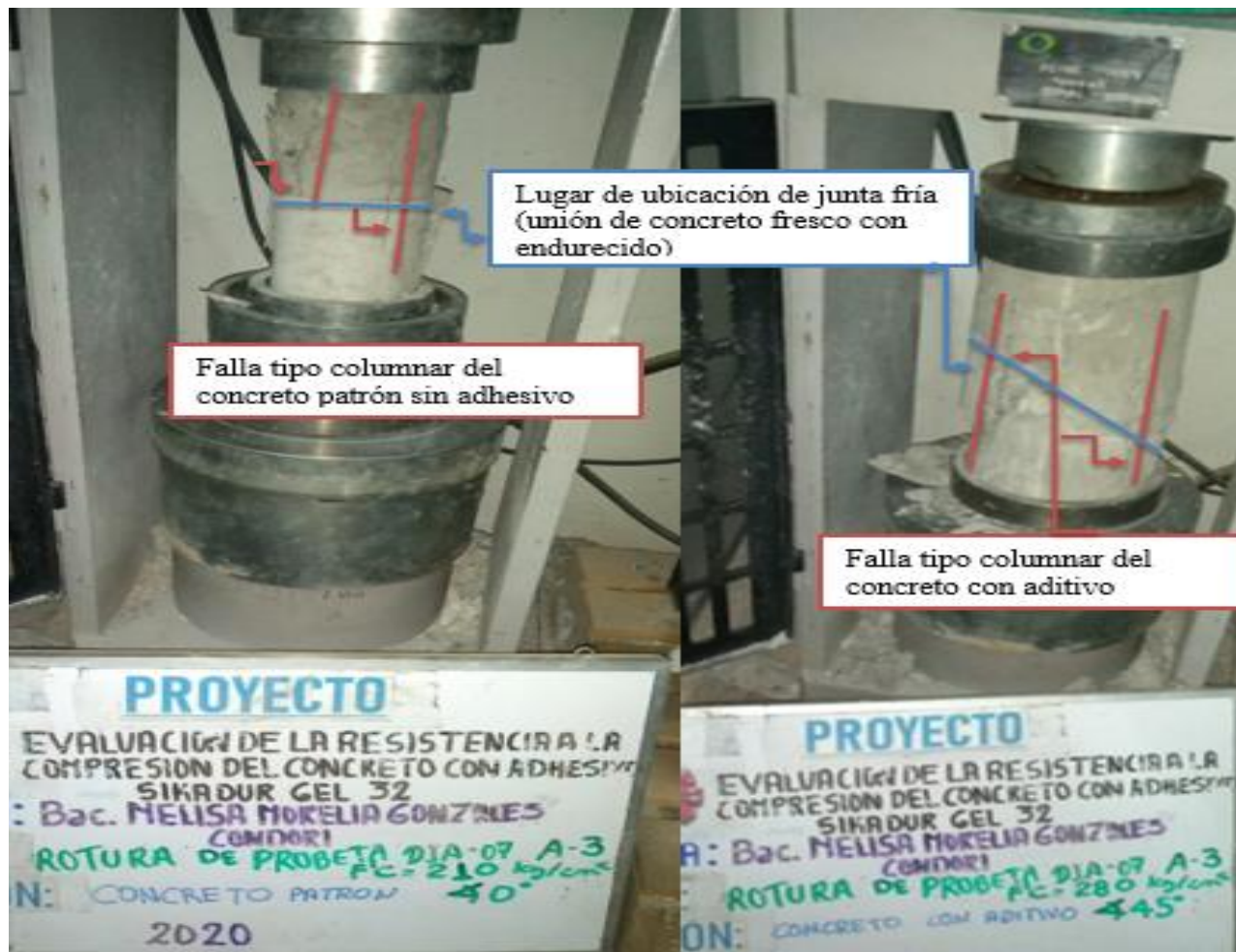
Figura 35 — Tipo de falla columnar en ensayos de compresión del concreto
