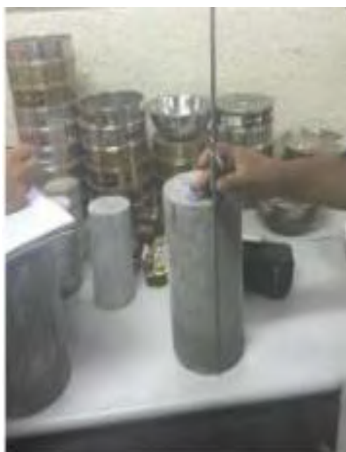
Figura 34 — Verificación y medición de la altura de la briqueta de
