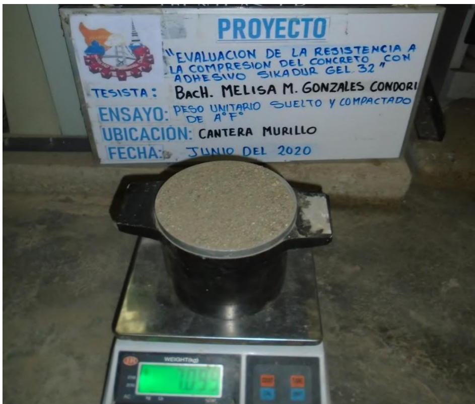
Figura 61 — Peso unitario suelto y compactado del agregado fino
