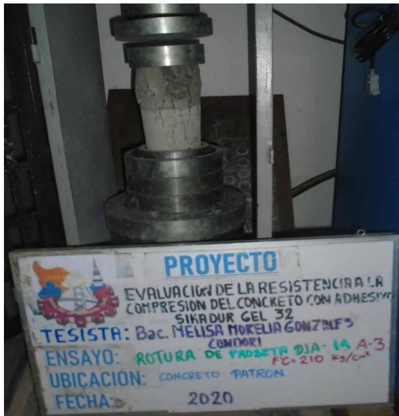
Figura 87 — Rotura de briqueta del concreto patrón con un ángulo de unión de 0°
