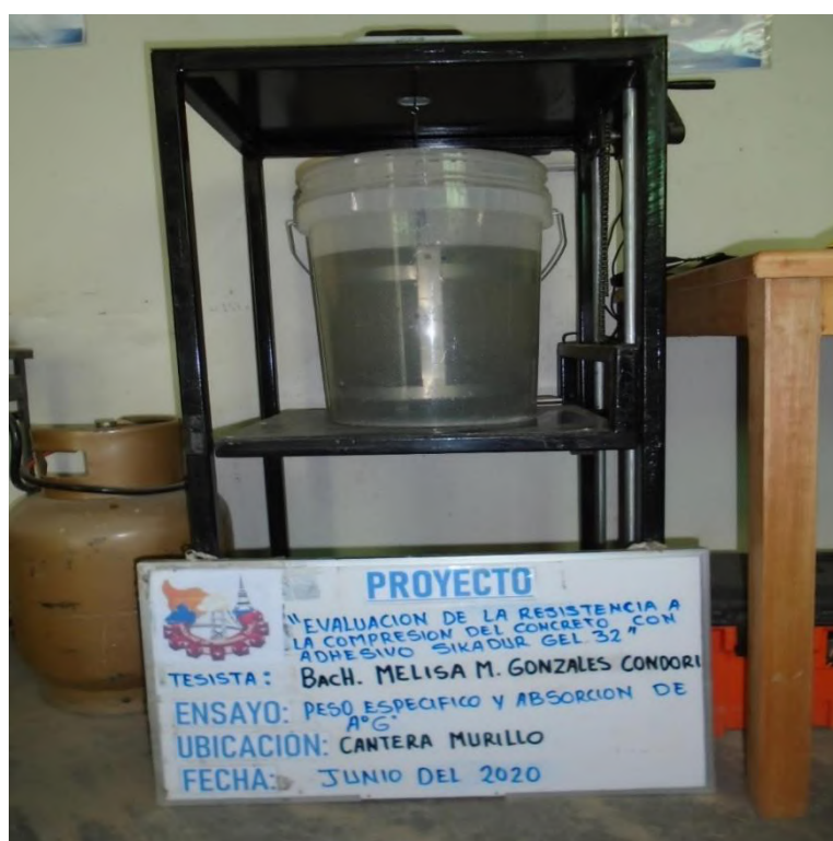
Figura 24 — Ensayo de peso específico y absorción del agregado grueso.
