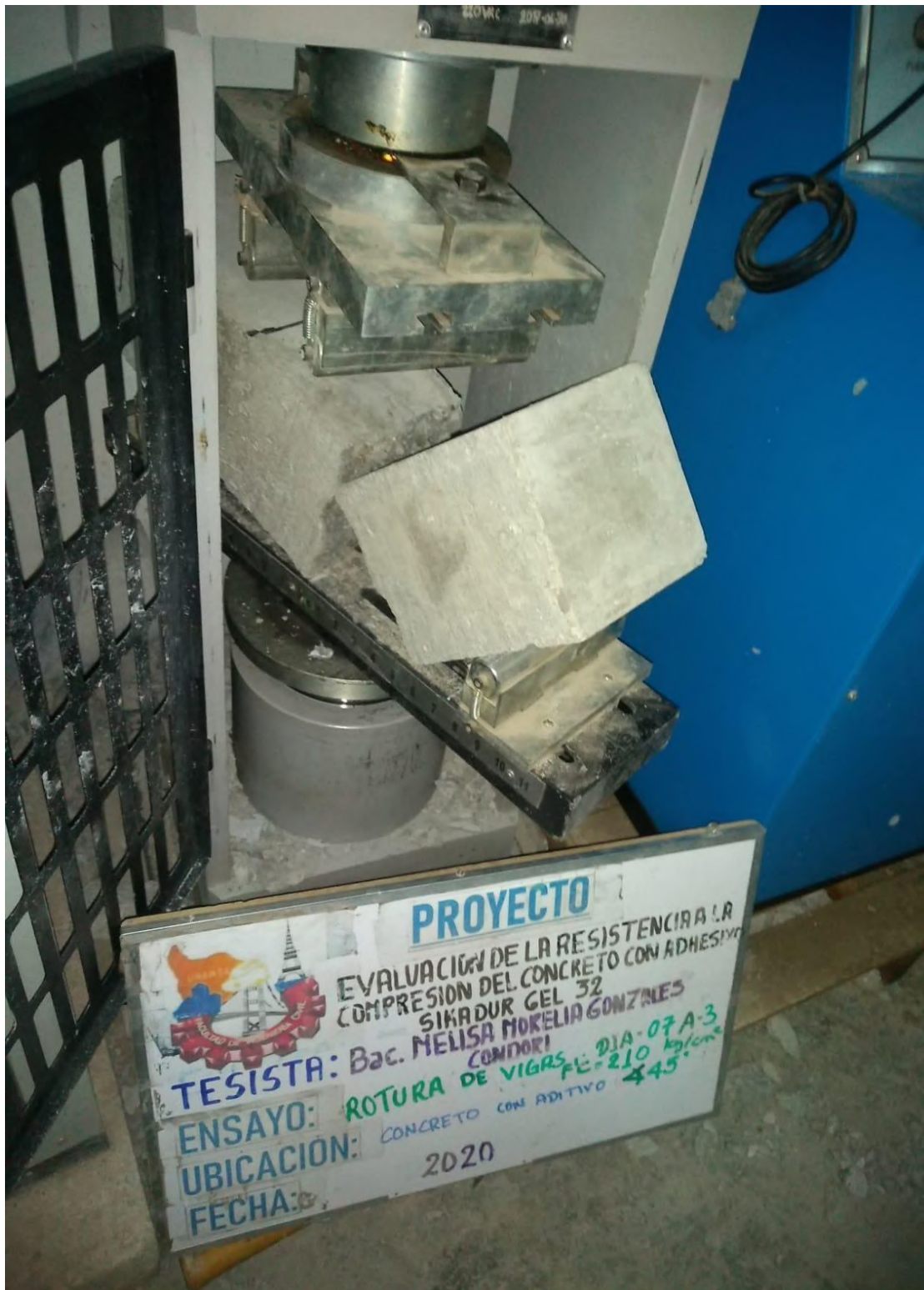
Figura 77 — Ensayo a la resistencia a flexión del concreto unida a 45° grados, edad de unión 3 días con adhesivo sikadur gel 32
