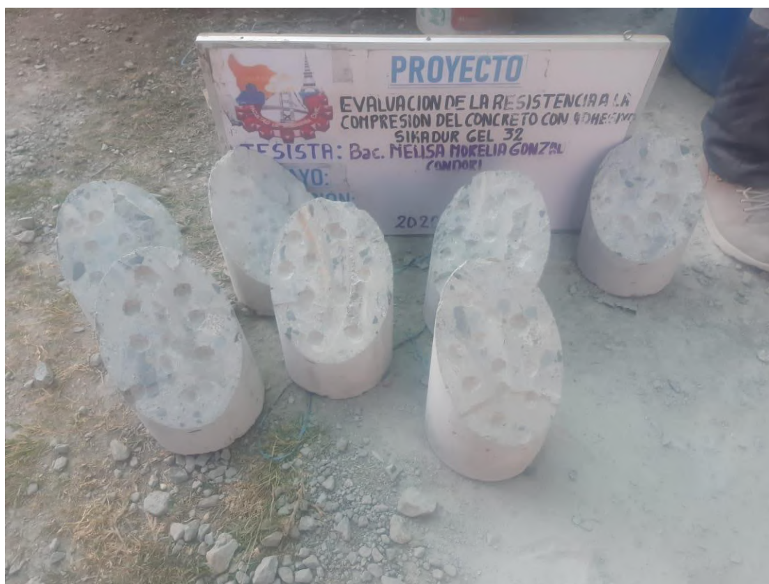
Figura 72 — Picado de briquetas para aplicar el adhesivo sikadur gel 32.
