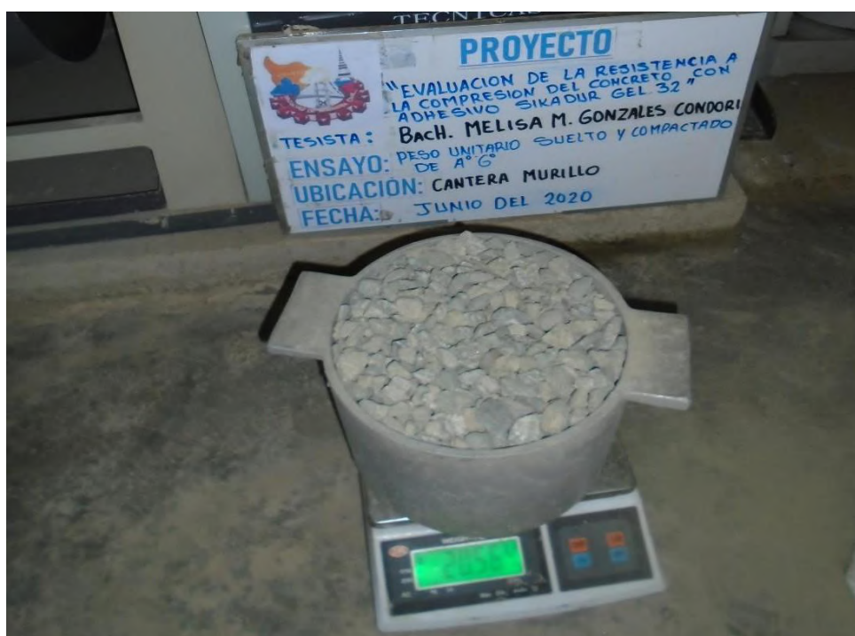
Figura 63 — Peso unitario suelto y compactado del agregado grueso.
