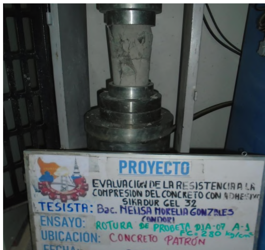
Figura 82 — Briqueta de concreto patrón f_c=280 \text{ kg/cm}^2 con tipo de falla cónica a 1 día de unión y 7 días de fraguado
