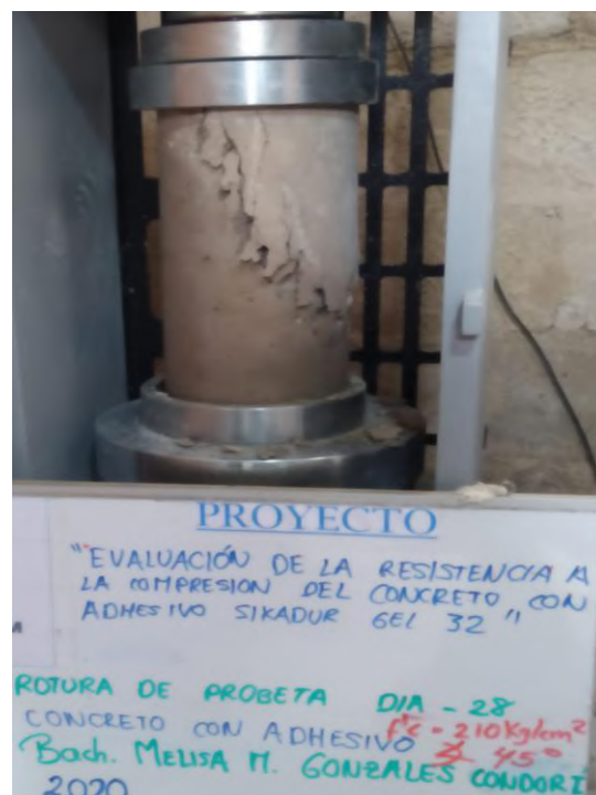
Figura 96 — Rotura de briqueta a los 28 días de fraguado
