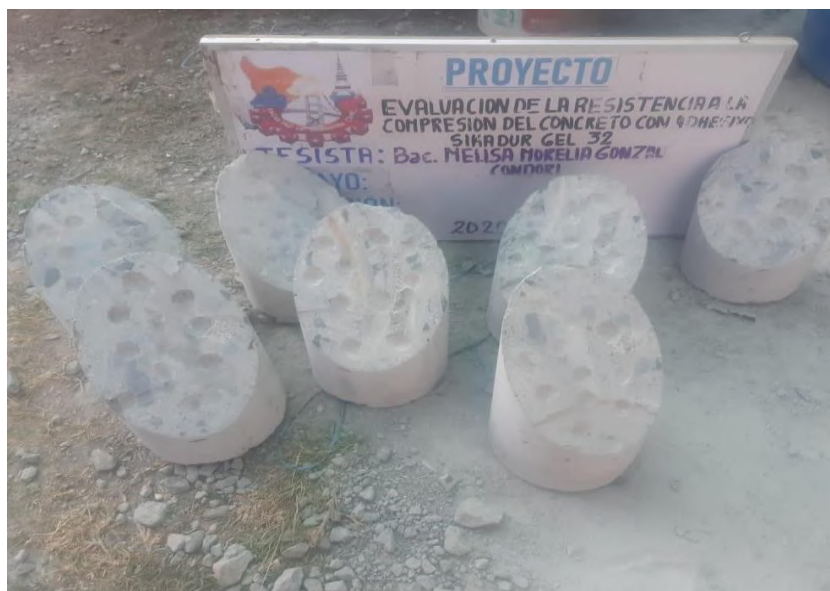
Figura 4 — Testigo de probeta según NTP 339.033-2015.
