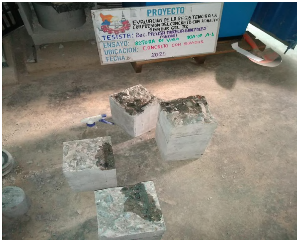
Figura 95 — Rotura de vigas con adhesivo sikadur gel 32 con falla ubicada en tercio central
