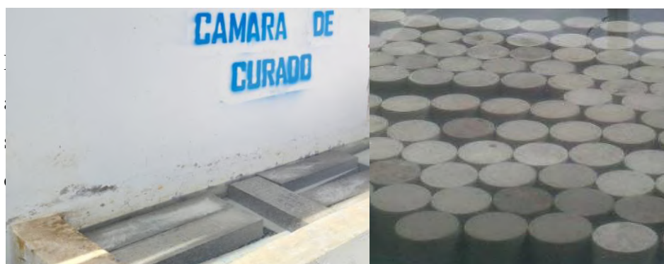
Figura 28 — Curado de briquetas y vigas de concreto
