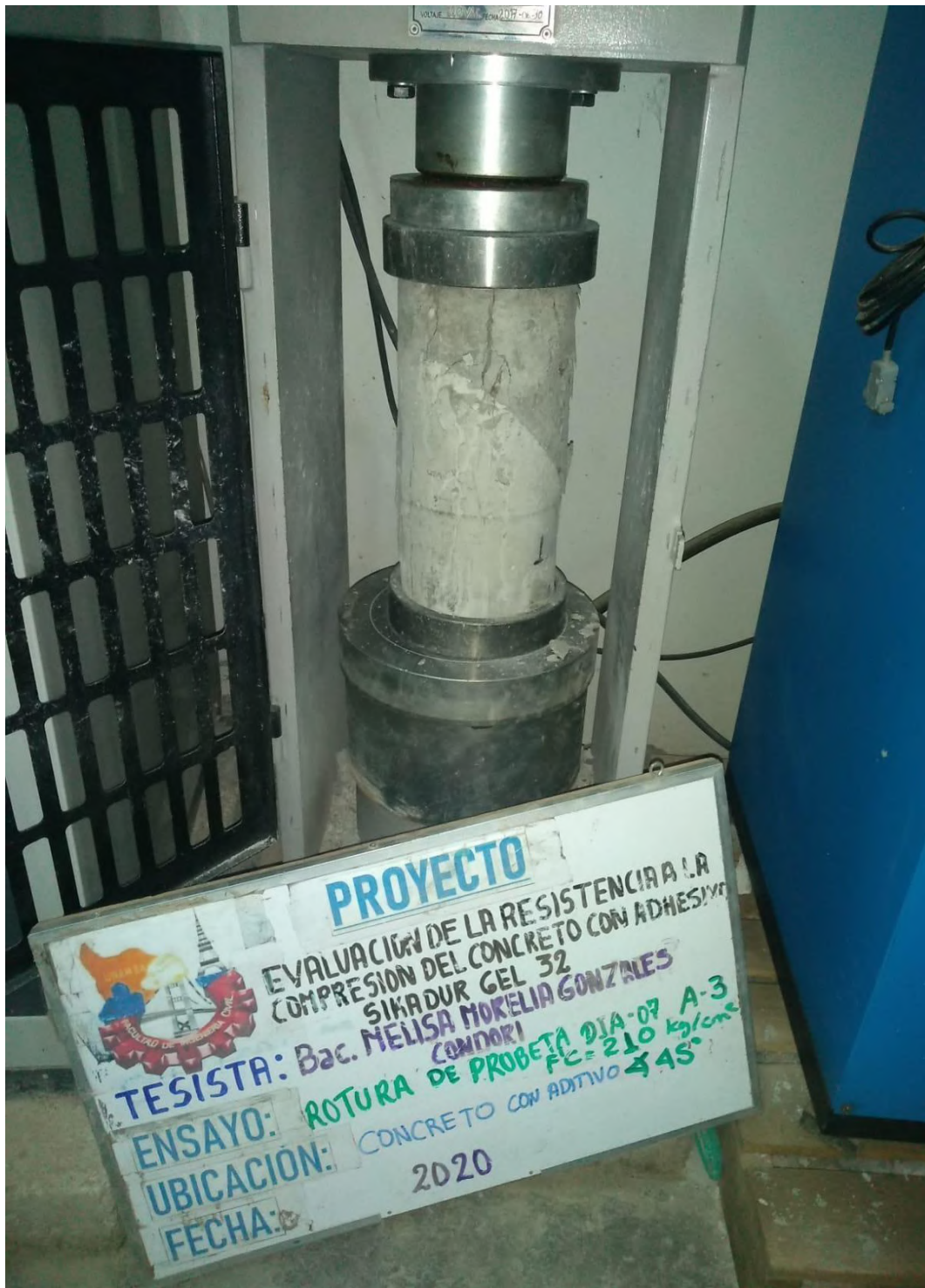
Figura 75 — Ensayo a la resistencia a la compresión del concreto unida a 45° grados con adhesivo sikadur gel 32
