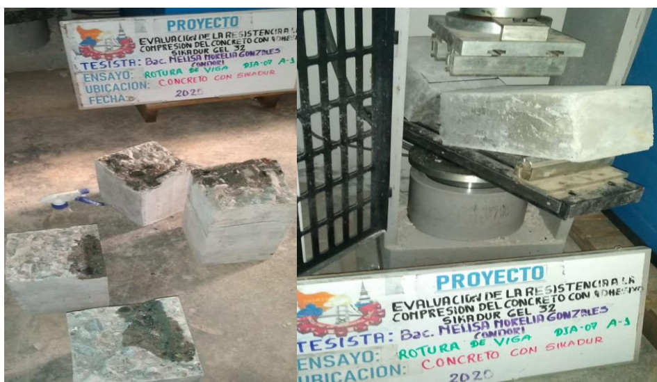
Figura 31 — Ensayo de resistencia a flexión del concreto con adhesivo sikadur gel 32
