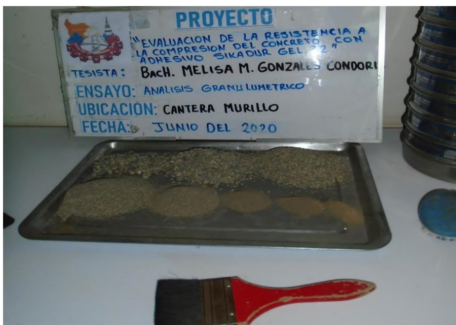
Figura 18 — Ensayo de análisis granulométrico del agregado fino
