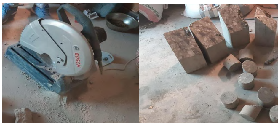
Figura 29 — Corte de vigas y briquetas en ángulos de 0^\circ Y 45^\circ
