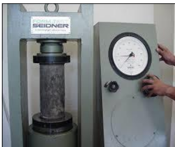
Figura 6 — Rotura a carga axial de testigos de concreto
