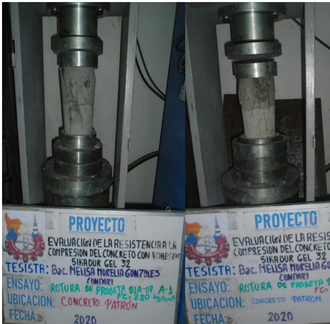
Figura 78 — Ensayo a la resistencia a la compresión del concreto patrón a 0° grados sin adhesivo sikadur gel 32
