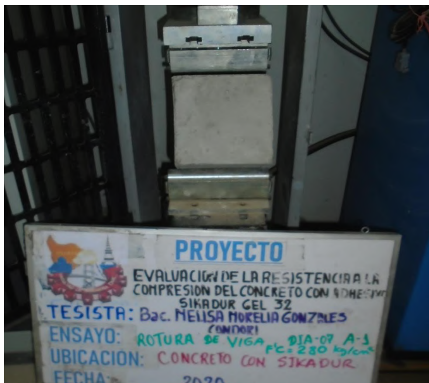
Figura 84 — Ensayo de resistencia a flexión del concreto f'c=280 \text{ kg/cm}^2 con adhesivo edad de unión 1 día a los 7 días de fraguado.
