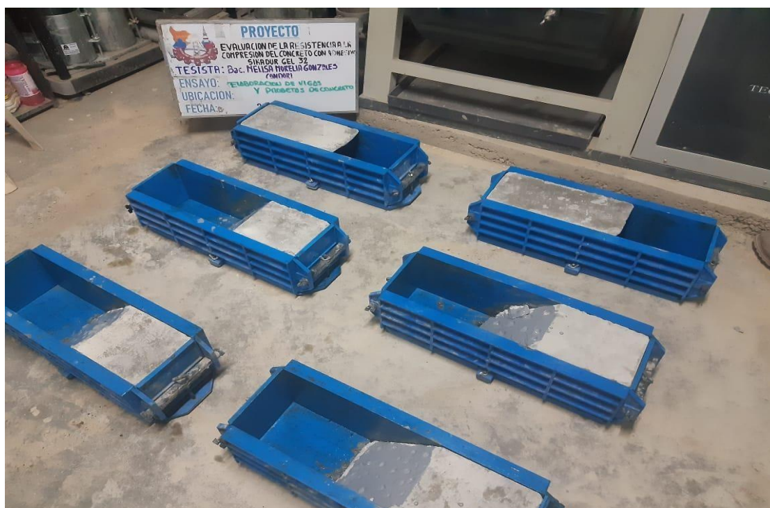
Figura 73 — Aplicación del adhesivo sikadur gel 32 en vigas
