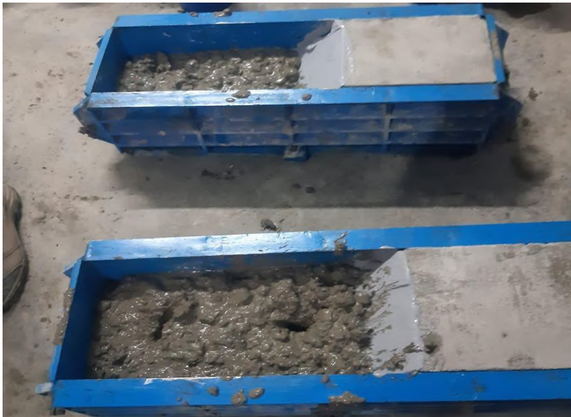
Figura 71 — Unión del concreto fresco con endurecido para completar la viga
