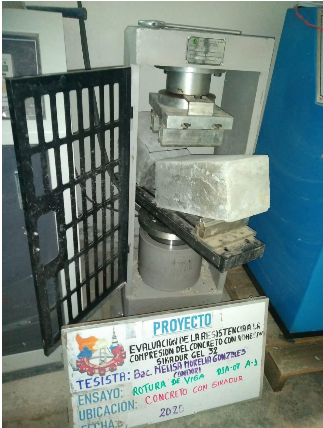
Figura 76 — Ensayo a la resistencia a flexión del concreto unida a 45° grados, edad de unión 1 día con adhesivo sikadur gel 32
