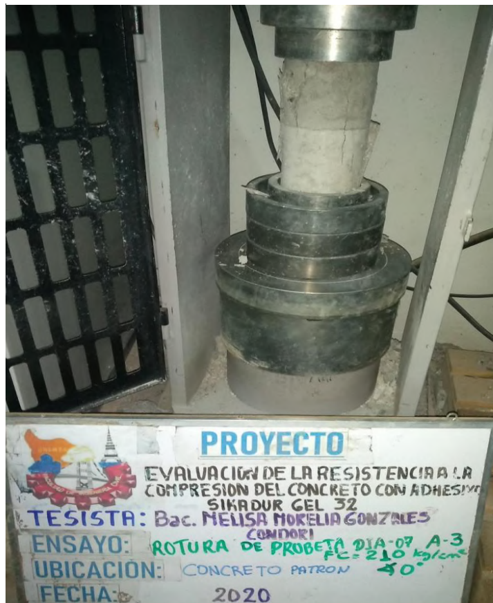
Figura 94 — Rotura de briqueta del concreto f_c=210 \text{ kg/cm}^2 patrón con un ángulo de unión de 0°
