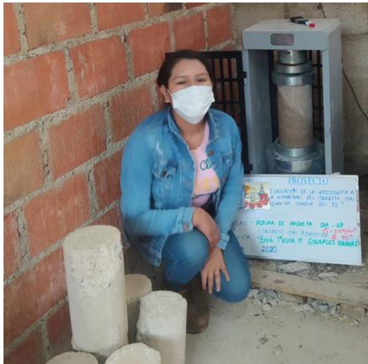
Figura 93 — Ensayo de rotura de briquetas a los 28 días con un ángulo de unión de 45°
