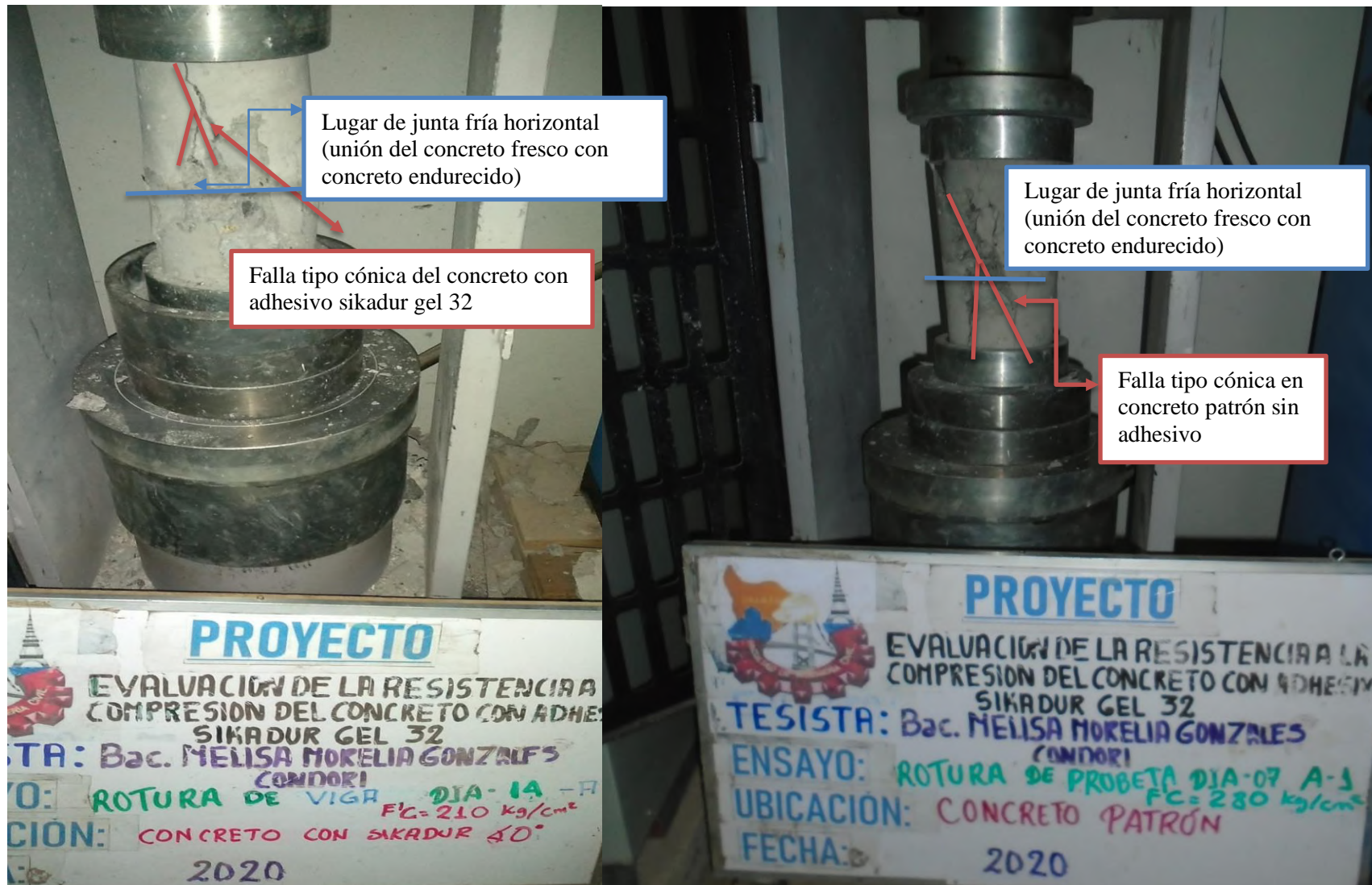
Figura 39 — Falla del concreto tipo cónica
