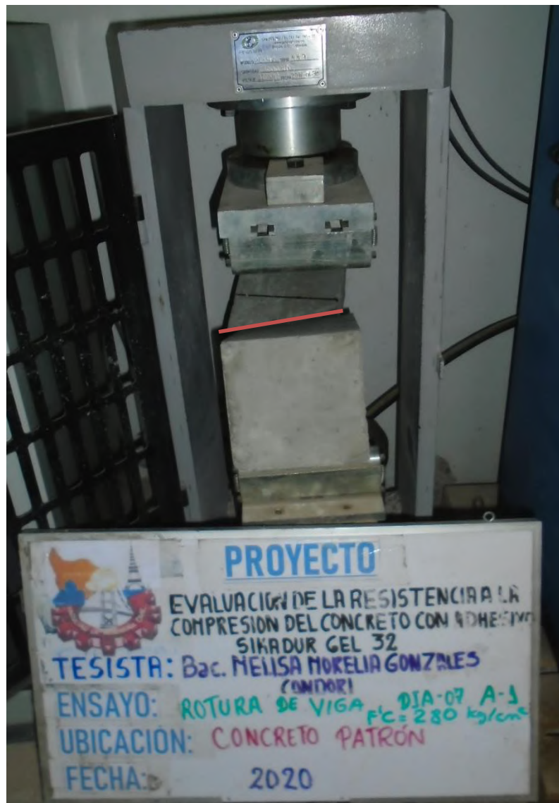
Figura 80 — Viga de concreto patrón con falla en la junta fría
