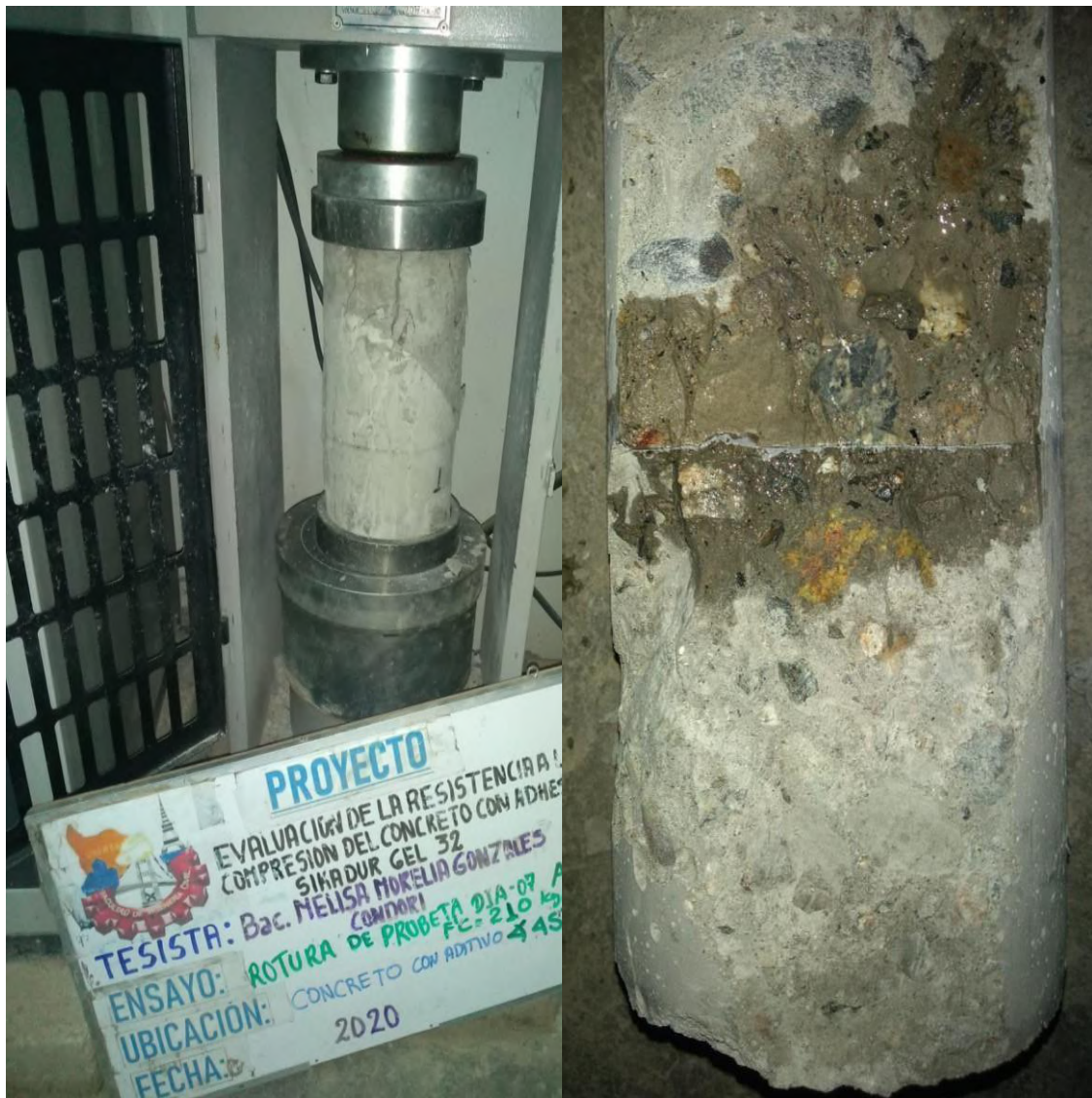
Figura 79 — Ensayo a la resistencia a la compresión del concreto con adhesivo a 45° y 0° grados
