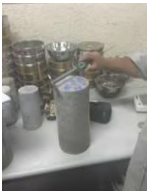
Figura 33 — Verificación del diámetro de la briqueta de concreto con ayuda del micrómetro
