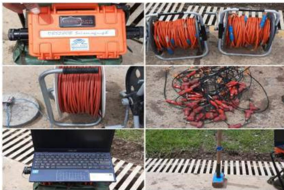
**Figura 62** — Instrumentos utilizados para el ensayo MASW
