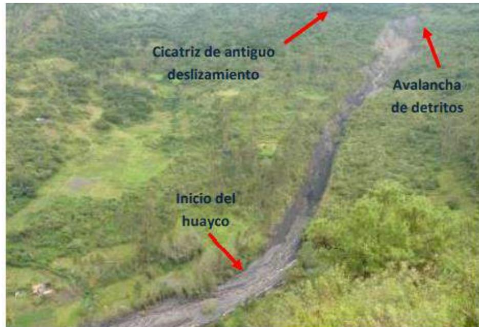
**Figura 20**—Avalancha-flujo de detritos en Cerro Chuyllurpata (Tamburco, Abancay) a causa de lluvias de marzo del 2012 (INGEMMET, 2012).
