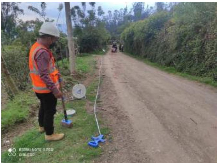
**FOTO 03:** Ensayo MASW – 01, momentos antes del primer registro mediante el impacto de la comba de 10 kg sobre la platina metálica.
