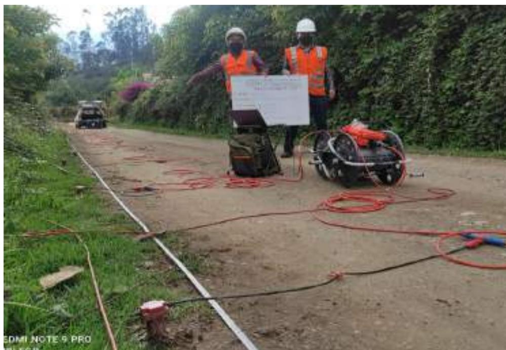
**Figura 63** — instalación del equipo para el ensayo MASW.
