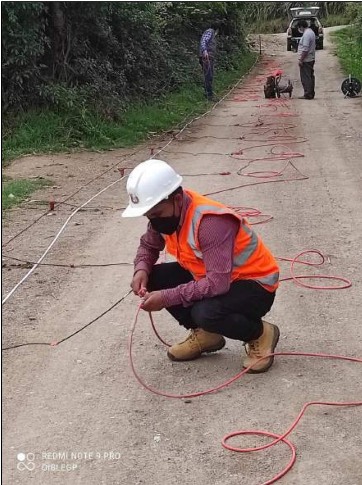
**FOTO 01:** Proceso de instalación de los equipos MASW
