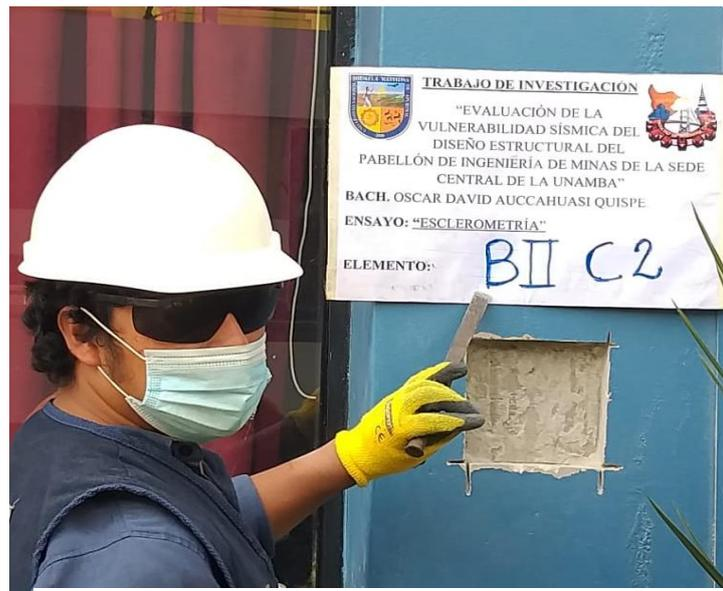
**Figura 78** — Limpieza manual de la superficie del elemento estructural a ser ensayado
