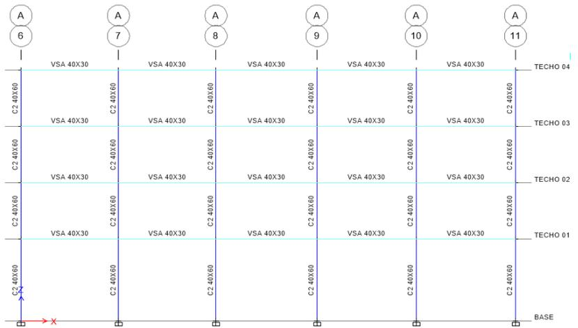
Figura 33 — Elevación eje A-A
