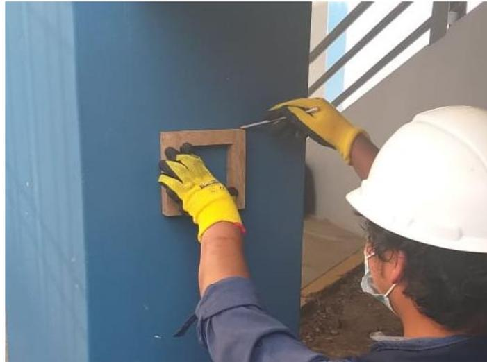
**Figura 76 — Trazo de área a ser ensayado en la columna**
