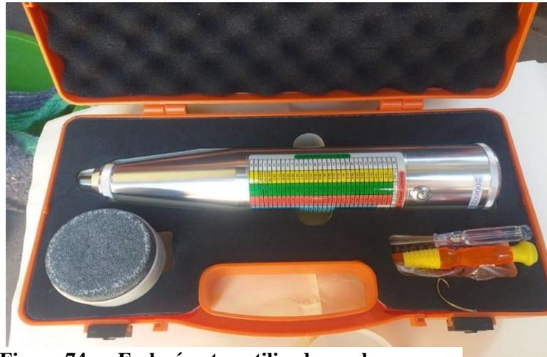
Figura 74 — Esclerómetro utilizado en el ensayo
