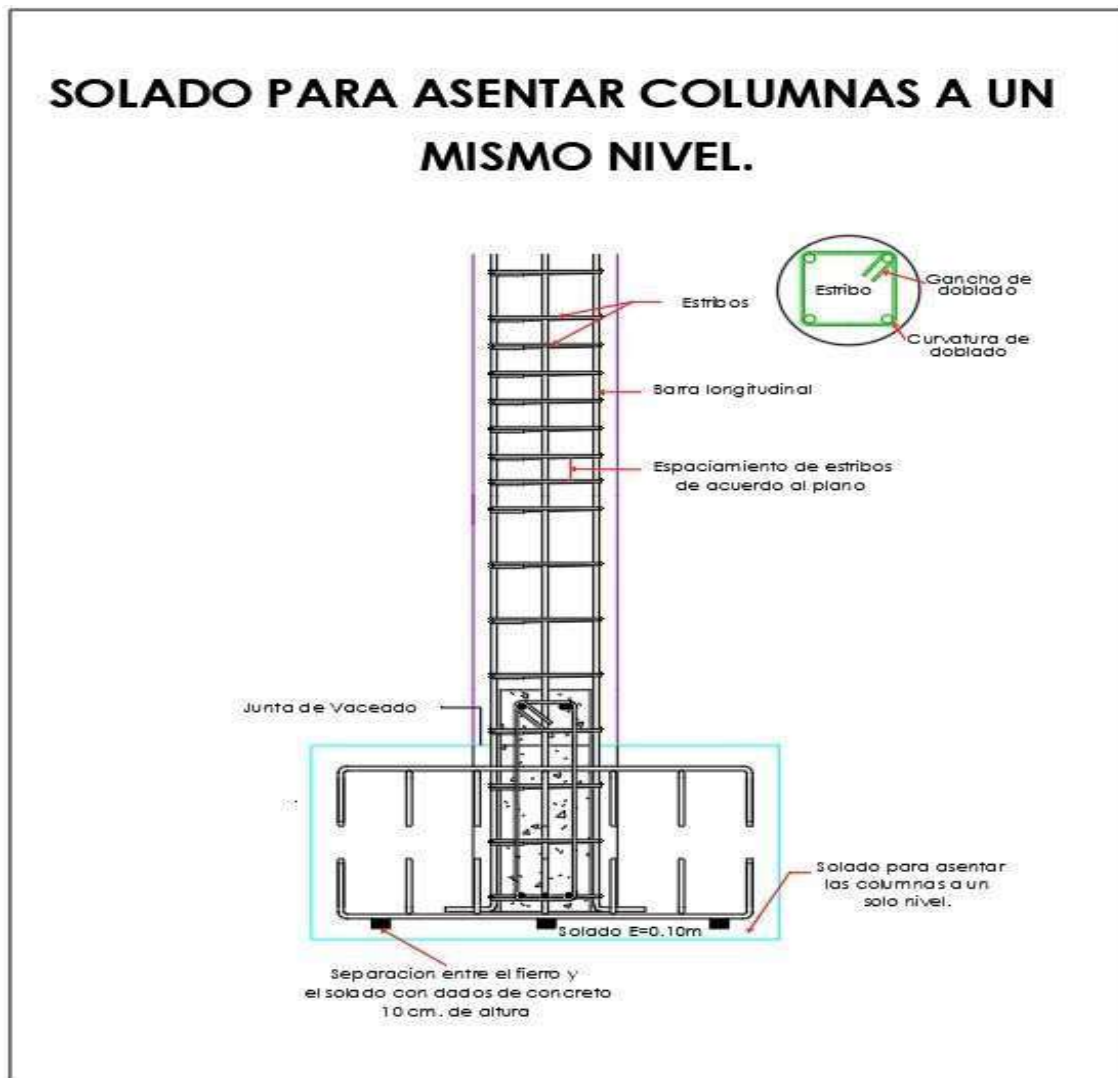
Figura 2— Solado para asentar columna a un mismo nivel
