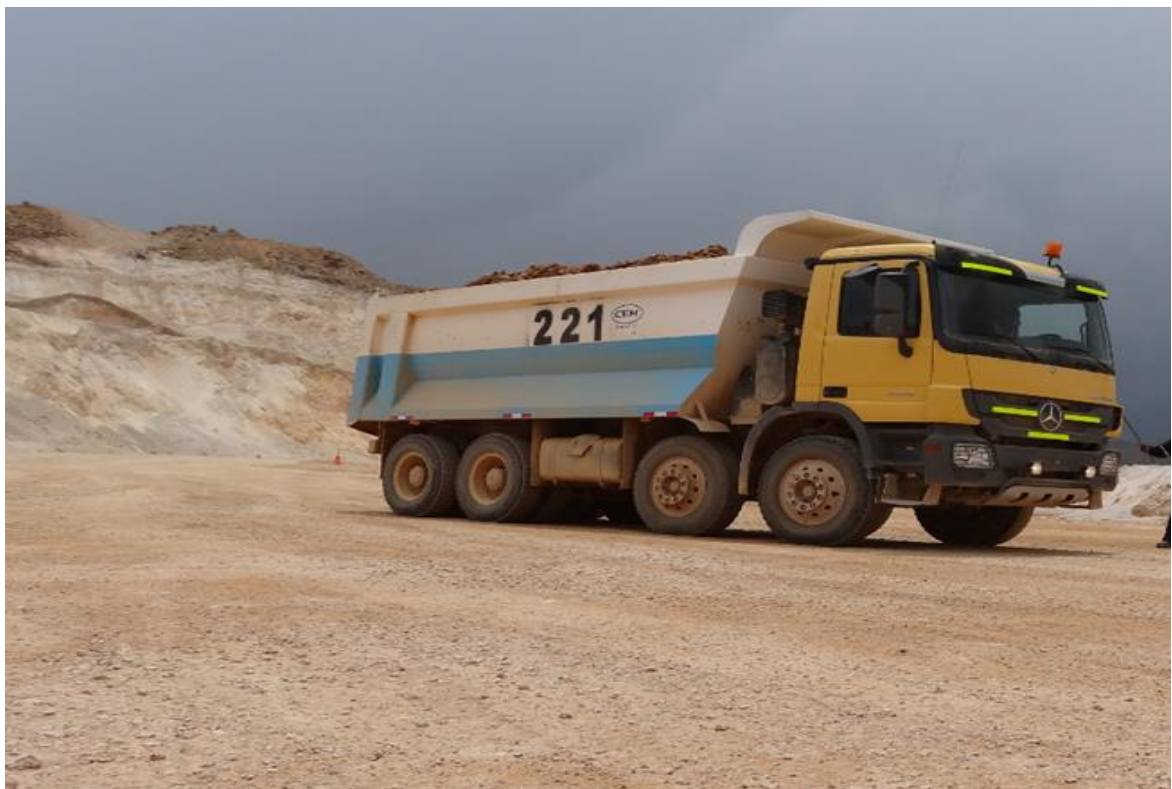
Figura 53 — Transporte de material con volquetes de 22 m 3
