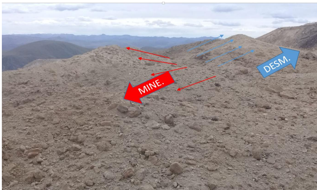
Figura 41 — Voladura selectiva entre el Mineral y Desmante
