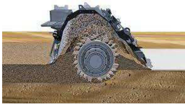
Figura 1 — Estabilización por combinación de suelos
