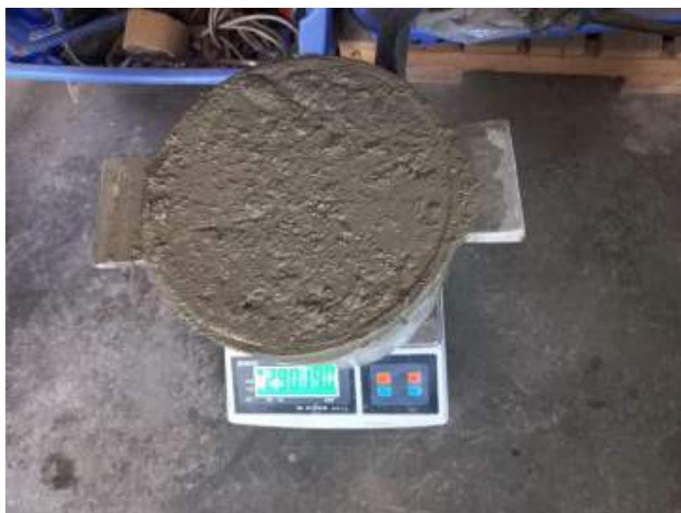
**Figura 16 – Peso unitario en estado fresco del concretoFast-Track.**
