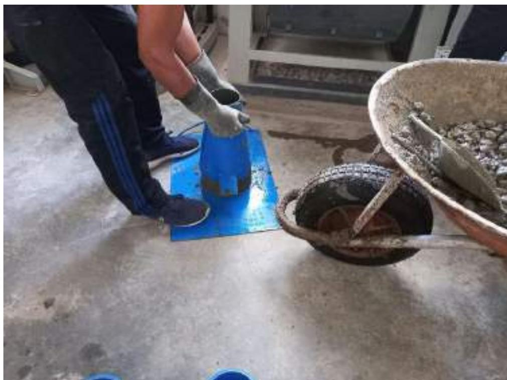
**Figura 14 – Ensayo de Asentamiento (Slump).**
