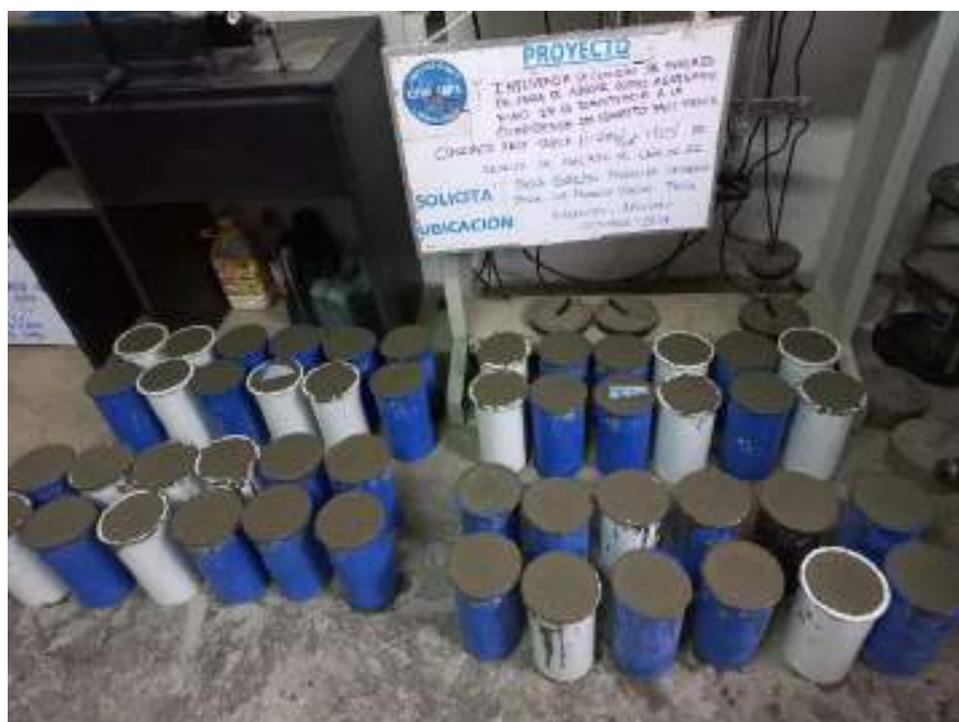
Figura 22 — Elaboración de probetas de concreto Fast-Track + % de adición de CBCA.
