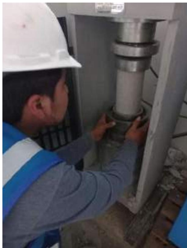
**Figura 25** — Colocación y ajuste de las probetas a la prensa de rotura de briquetas.
