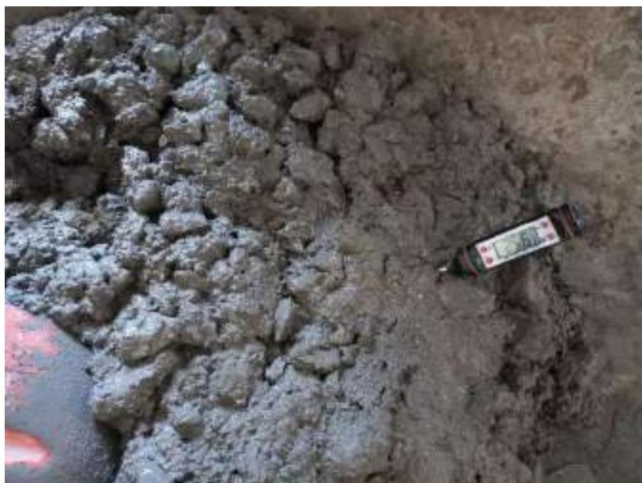
**Figura 12 – Medida de temperatura del concreto Fast-Track en estado fresco.**
