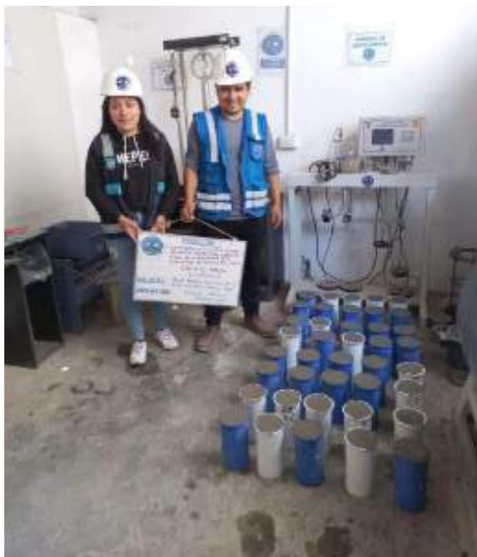
Figura 19 – Rotulado de probetas de concreto Fast-Track.
