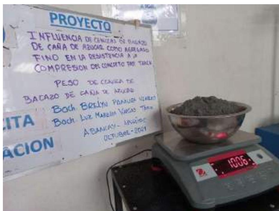
Figura 4 — Peso de ceniza de bagazo de cañazo de azúcar.
