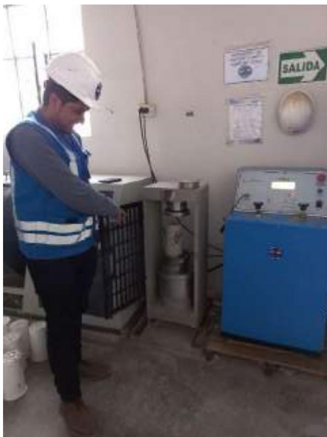
**Figura 26** — Ensayo de rotura de probetas.
