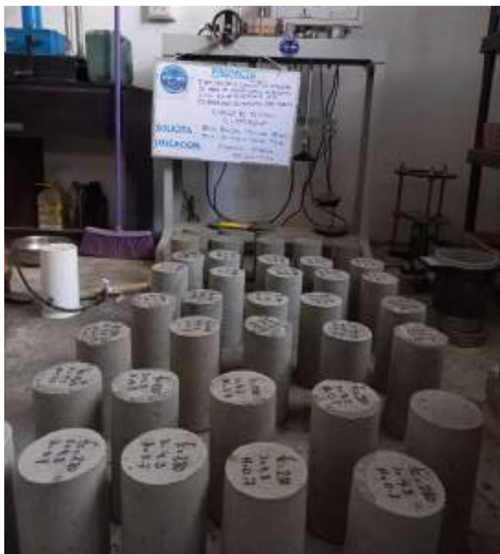
Figura 21 — Desencofrado de probetas de concreto Fast-Track.
