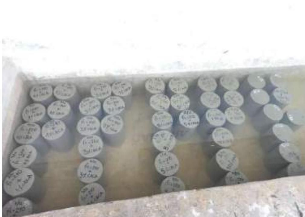
**Figura 32 – Proceso de curado de las probetas elaboradas del Concreto Fast-Track.**
