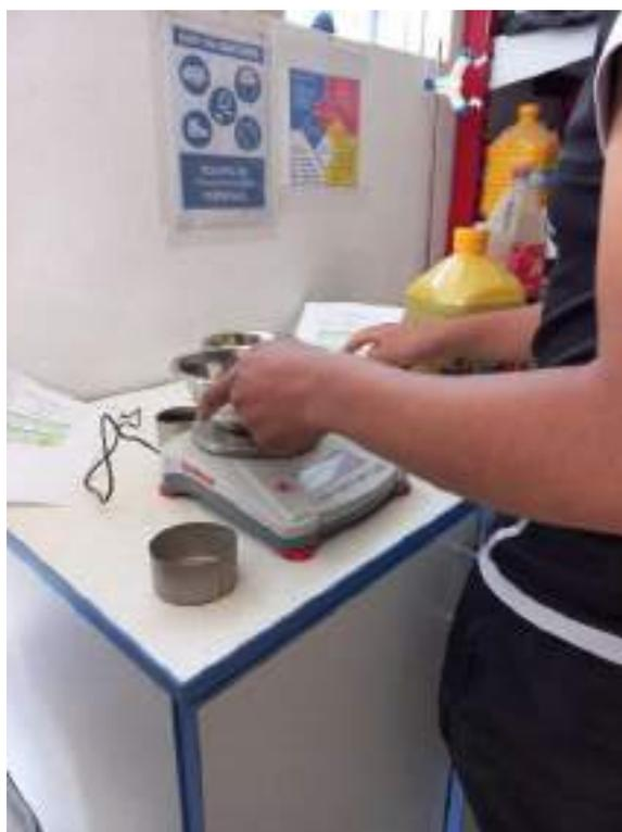
**Figura 1 — Peso de aditivo según diseño de mezcla.**
