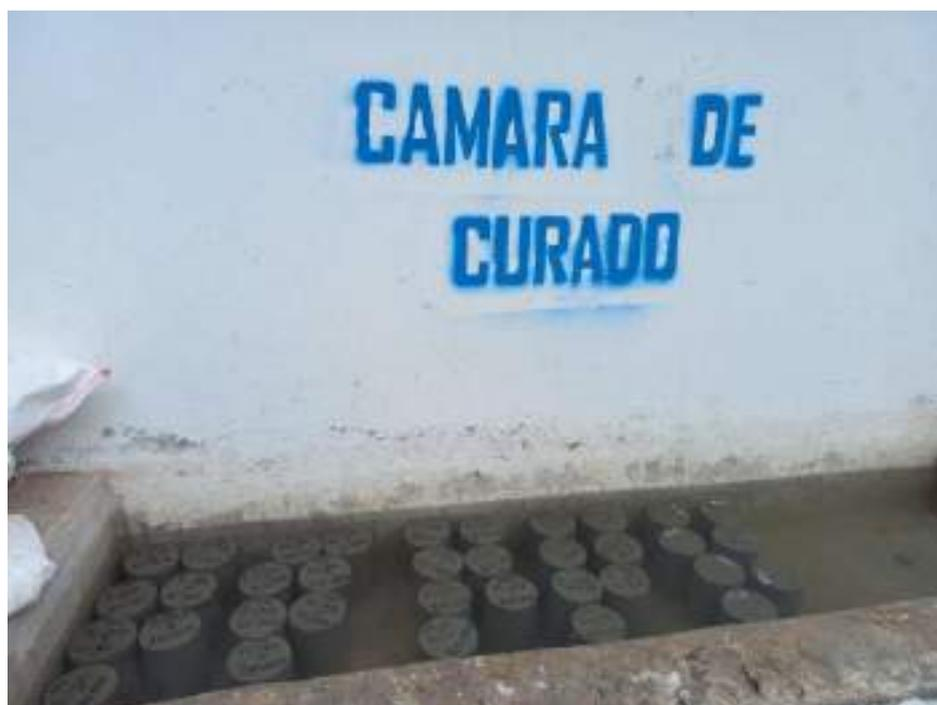
**Figura 31 – Cámara de curado de probetas del concreto Fast-Track.**
