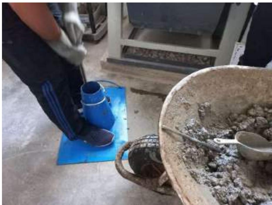
**Figura 13 – Ensayo de Asentamiento (Slump).**
