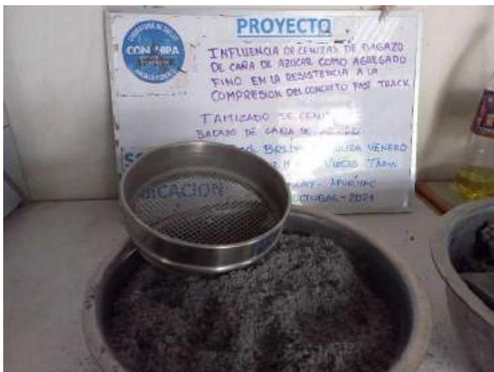
Figura 3 — Tamizado de ceniza de bagazo de caña de azúcar.
