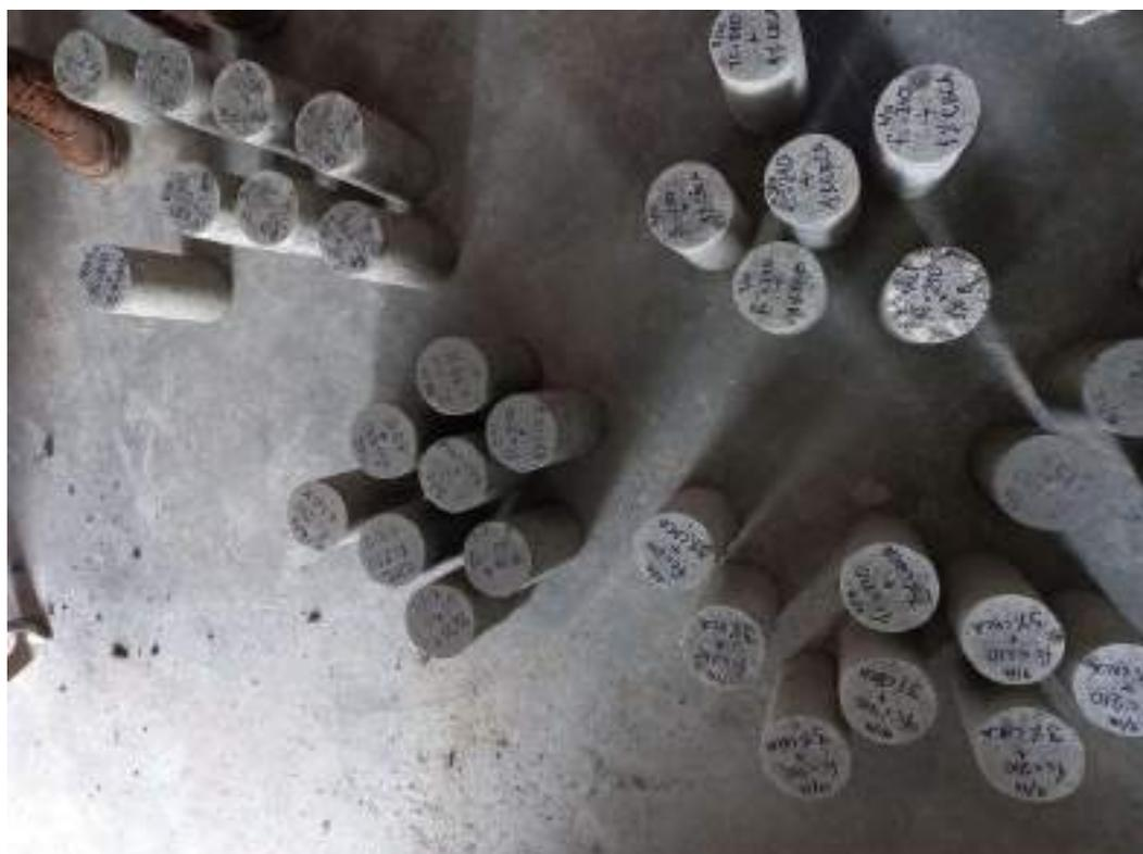
**Figura 24 – Rotulado de probetas de concreto Fast-Track.**
