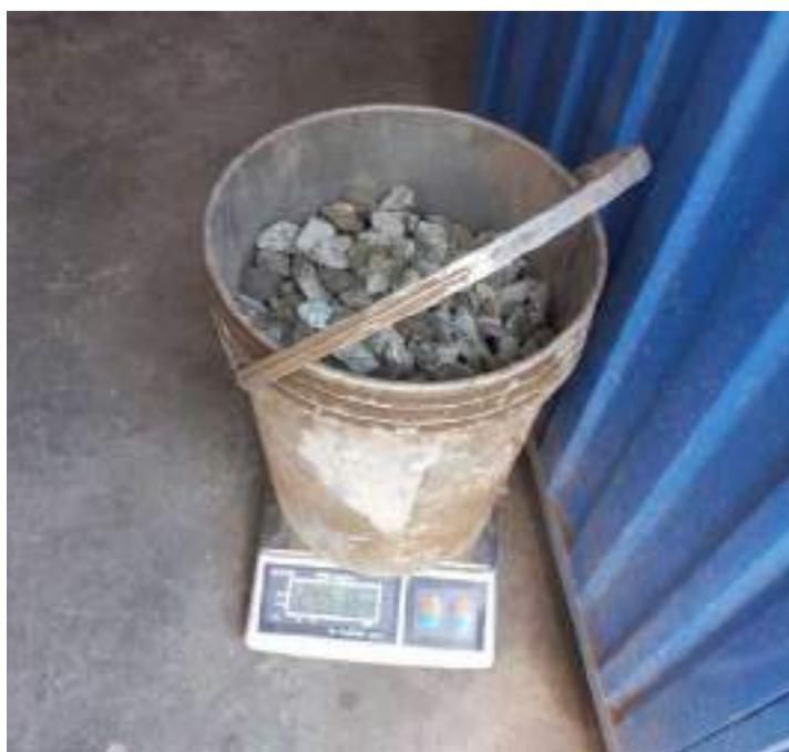
**Figura 2 — Peso de piedra chancada según diseño de mezcla.**
