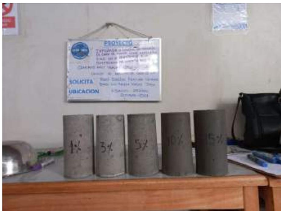
Figura 30 — Probetas elaboradas según el % de adición de CBCA.
