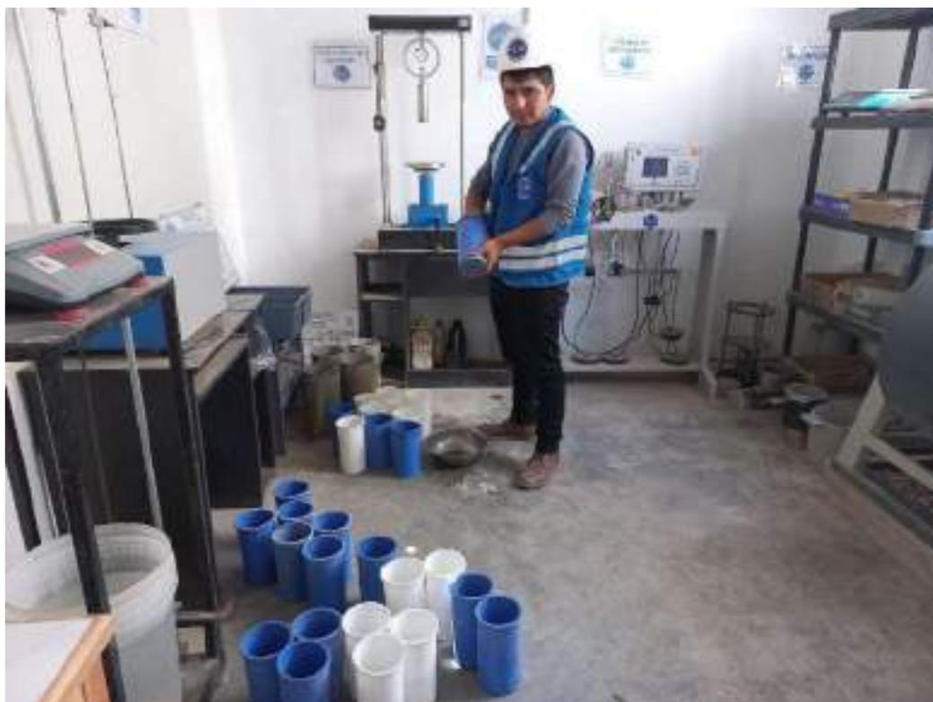
**Figura 7 – Preparación de moldes para elaboración de probetas de concreto Fast.Track.**
