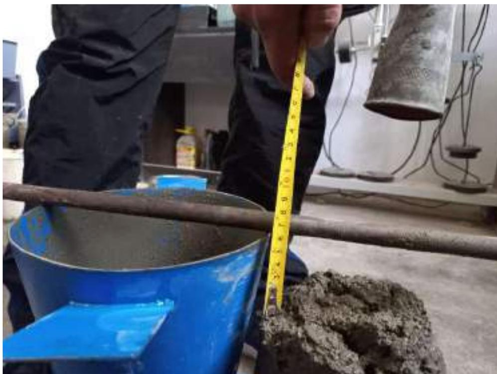
**Figura 15 – Medición del asentamiento del concreto en estado fresco.**
