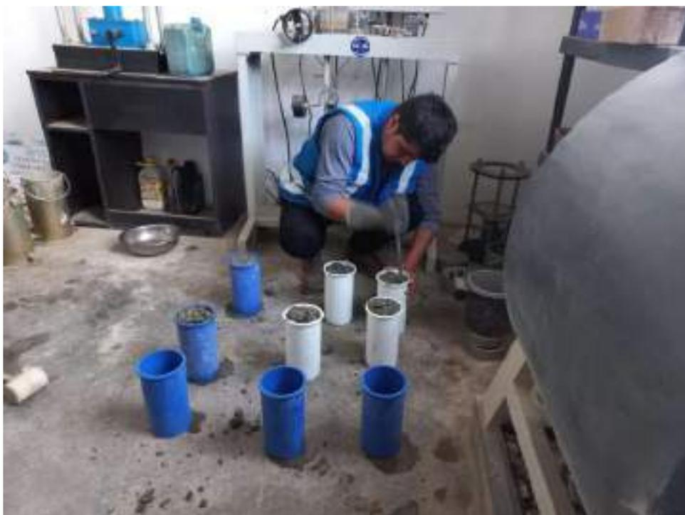
Figura 17 – Elaboración de probetas de concreto Fast-Track.
