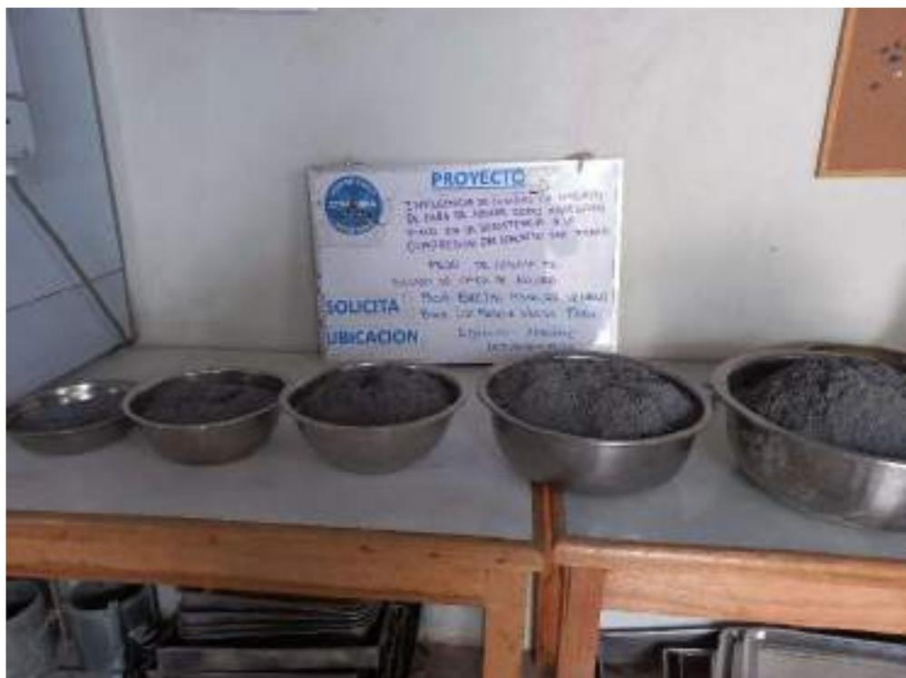
**Figura 5 — Cantidades de CBCA según porcentaje a adicionar al concreto Fast-Track.**
