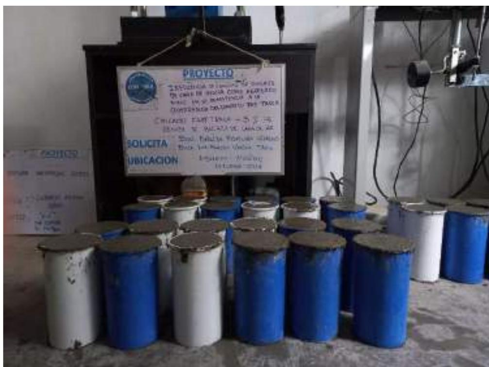
Figura 20 – Elaboración de probetas de concreto Fast-Track.
