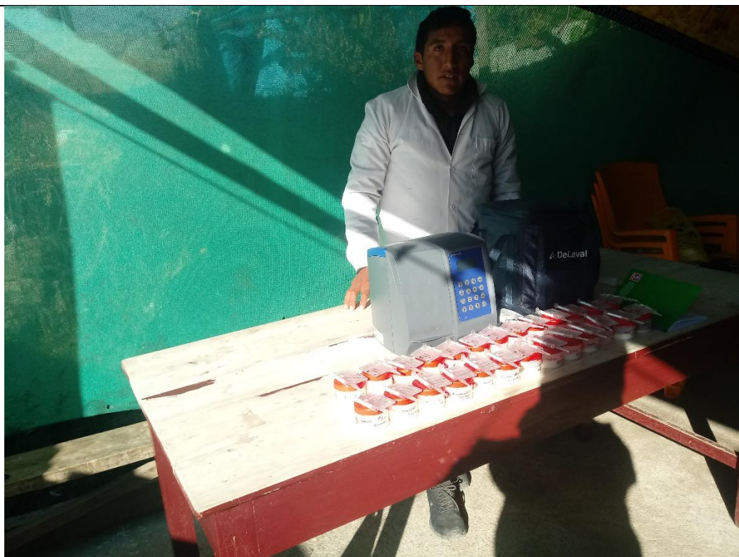
Imagen N° 6: En la imagen se observa el equipo Couter Delaval y los casset procesados de las distintas muestras.
