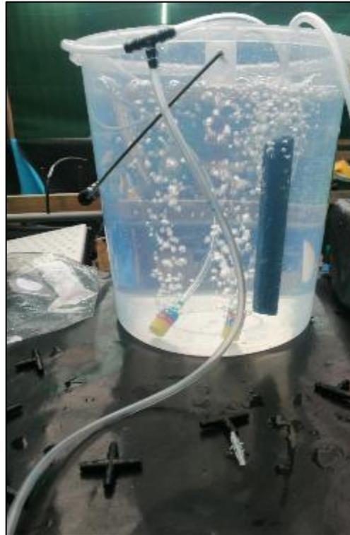
Figura 63 — Prueba de oxigenador para Post Almacigo
