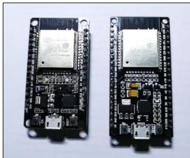
Figura 7 — Módulo esp32-wroom-32
