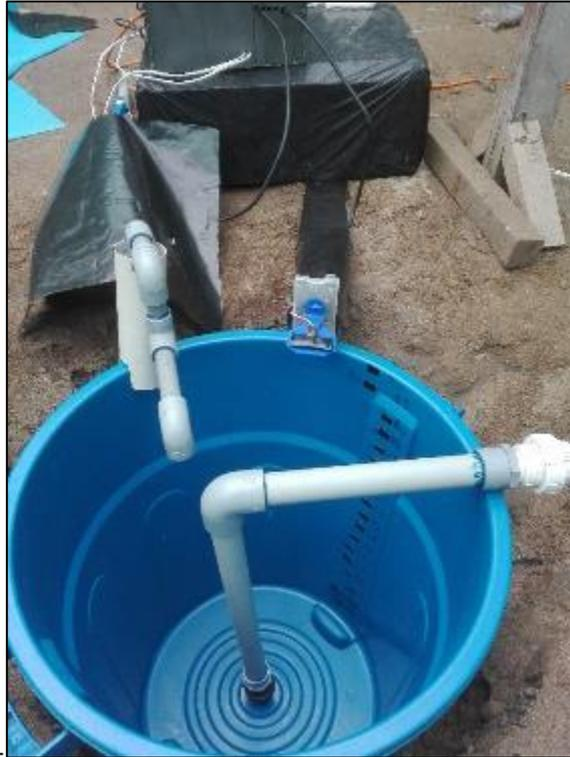
Figura 72 — Modulo 3 para control de llenado y nivel de agua en NFT
