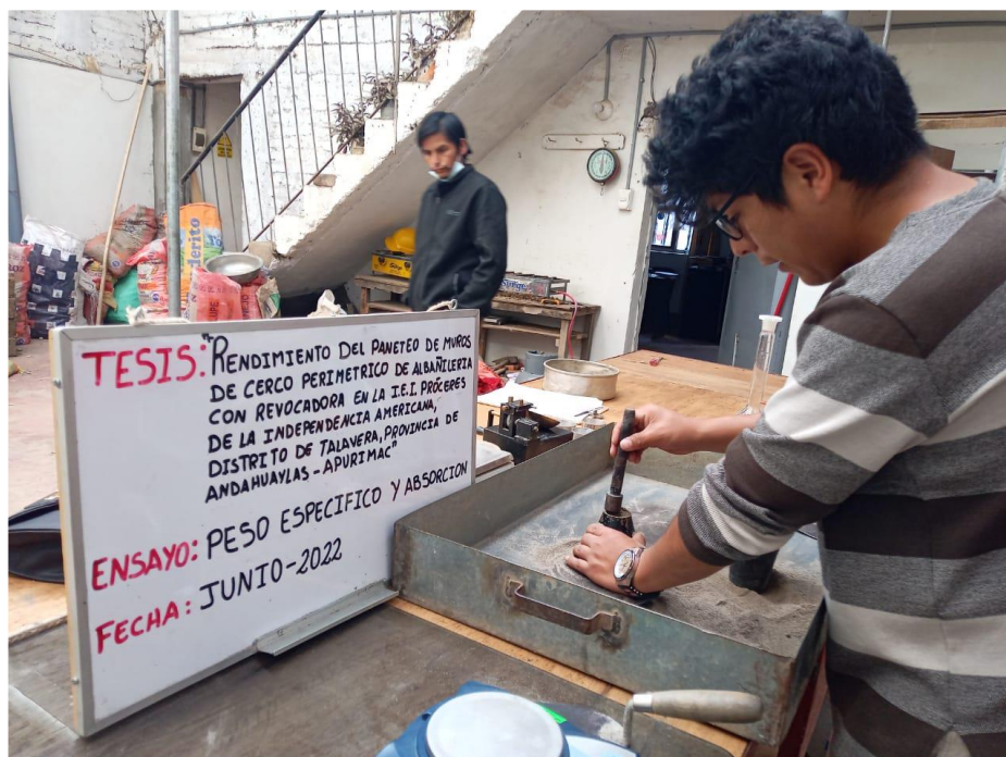
Figura 53 — Procedimiento para verificar si existe humedad superficial de la arena con el molde cónico
