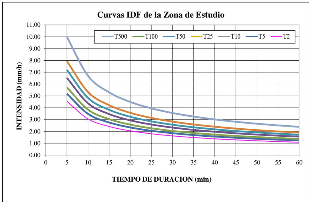
**Figura 7 — Curvas Intensidad, Duración y Frecuencia (IDF)**
