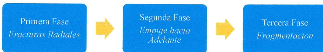
**Figura N° 14.** Etapas del proceso del Fragmentación de la Rocas.
