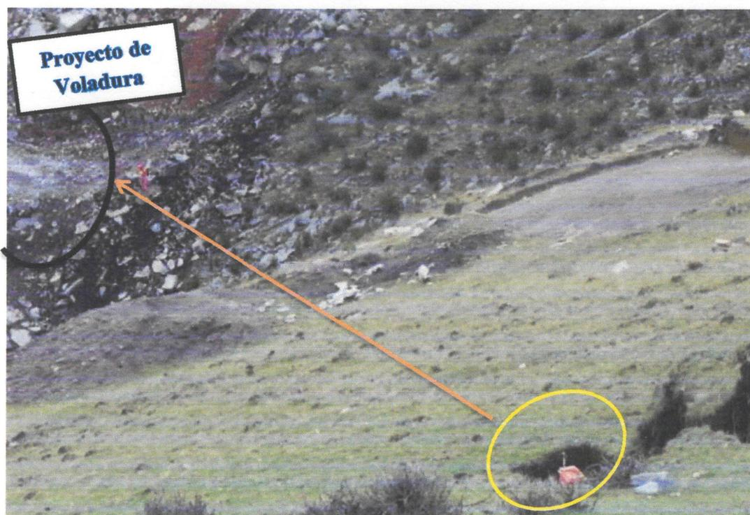
Foto. Instalación del geófono Pre Voladura Tramo 01.
