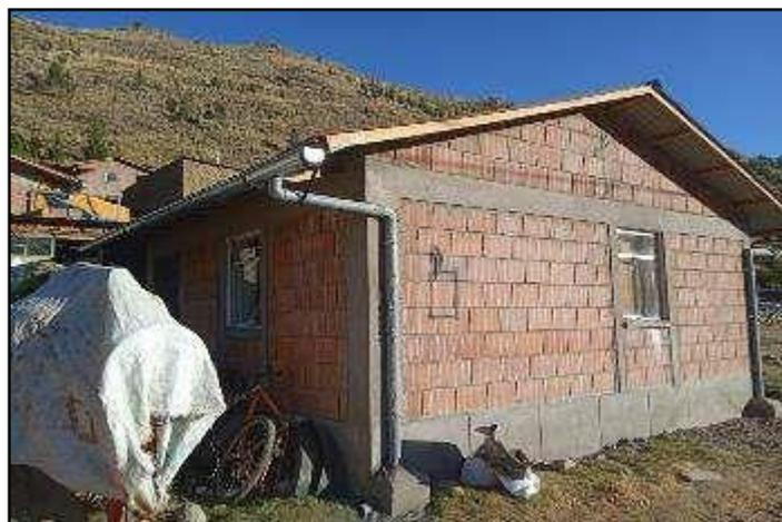
**Figura 110 — Módulo habitacional con muros de ladrillo con EPS 3-4**
