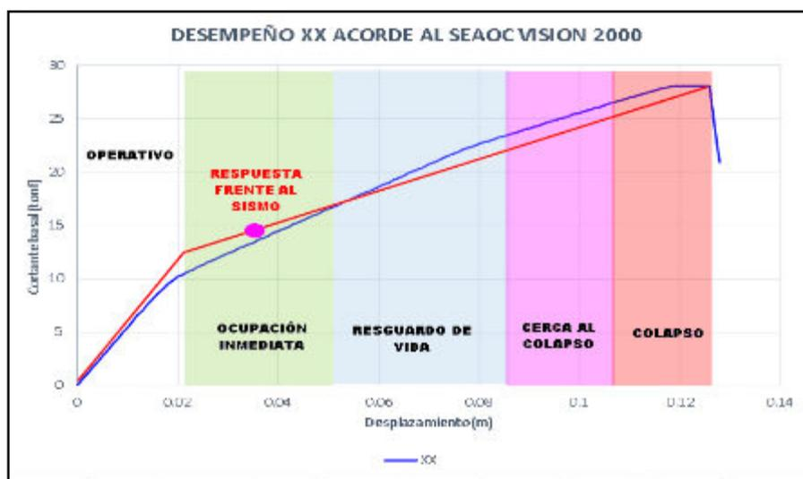
**Figura 63** — Curva de capacidad y desempeño para sismo máximo en la dirección X-X
