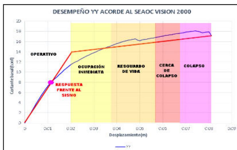
**Figura 95 — Curva de capacidad y desempeño para sismo máximo en la dirección Y-Y**
