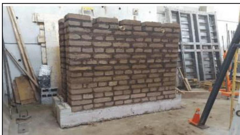
**Figura 40 — Muro de adobe reforzado con caña**
