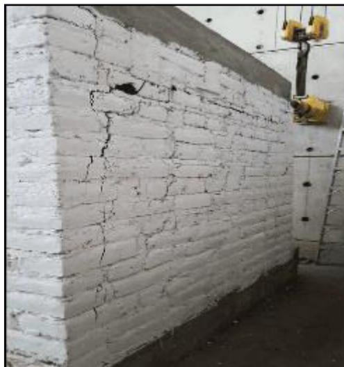
**Figura 41 — Observación de fisuras efecto de carga cíclica**
