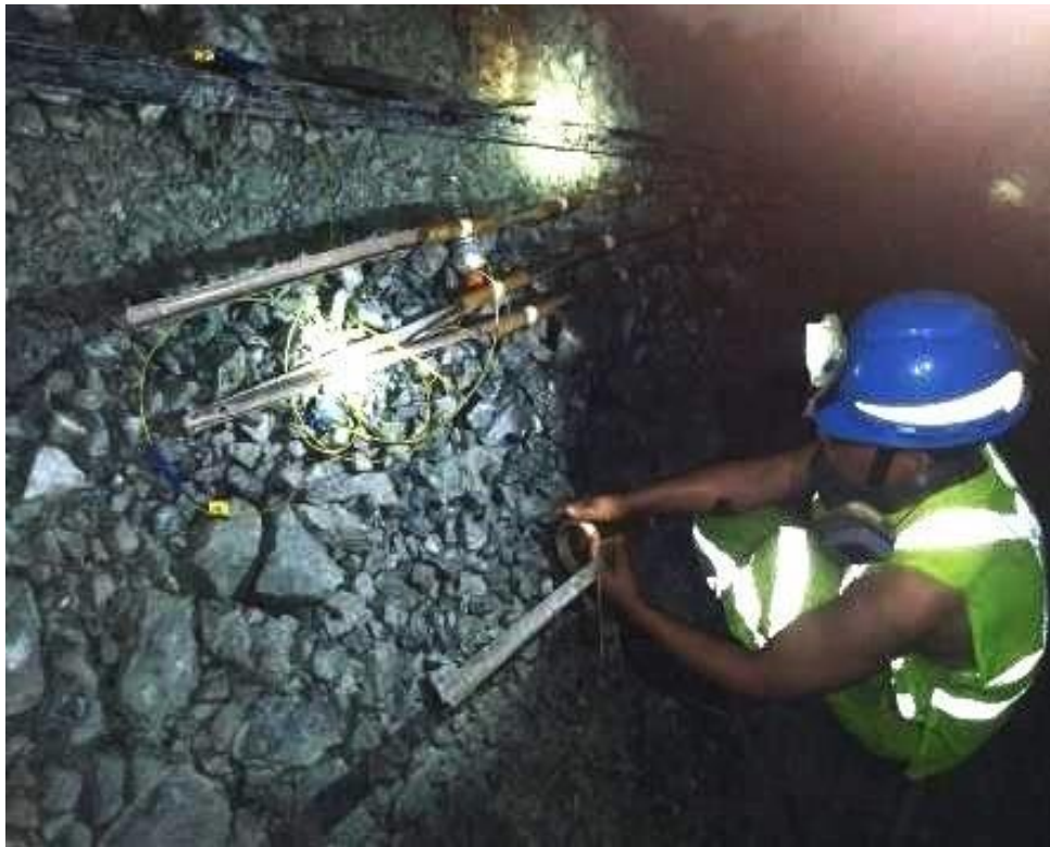
Figura 49 — Preparación de cañas con Exsablock 7/8"x7" espaciados
