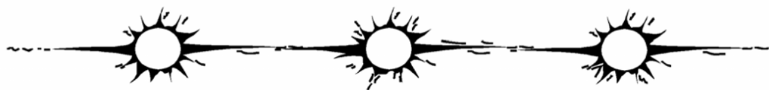
Efecto de la corta distancia entre los taladros de recorte
