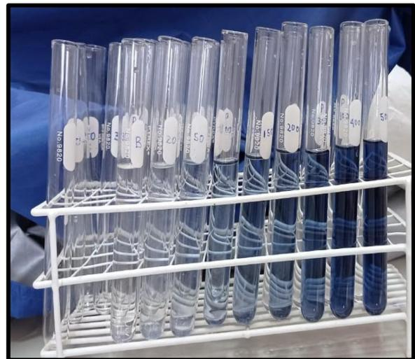
Foto 4: Muestras patrón listas para ser leídas en el espectrofotómetro.
