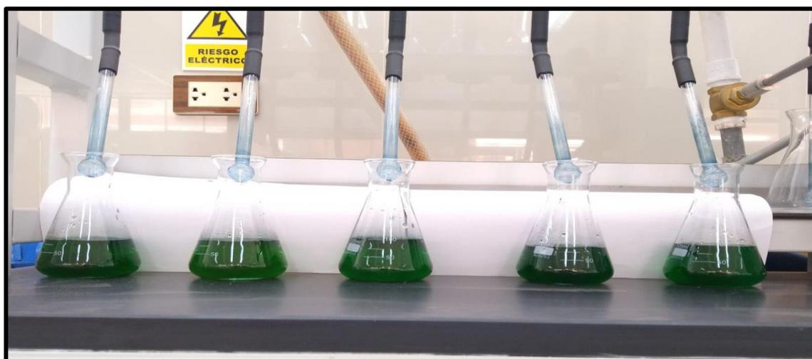
Foto 12: Matraz con muestras destiladas para el proceso de titulación
