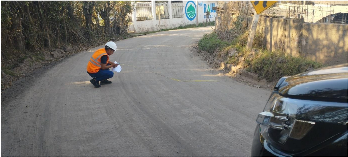
Figura 76 —Registro del ancho de la vía en una curva
