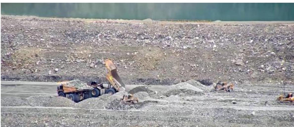
**Figura 104 — Equipo auxiliar (Tractor sobre orugas) conformando la zona de descarga.**
