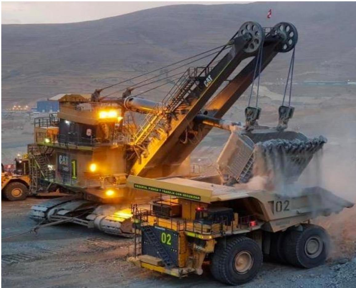
Figura 95 — Pala eléctrica cargando a un camión Komatsu 930E-4SE.
