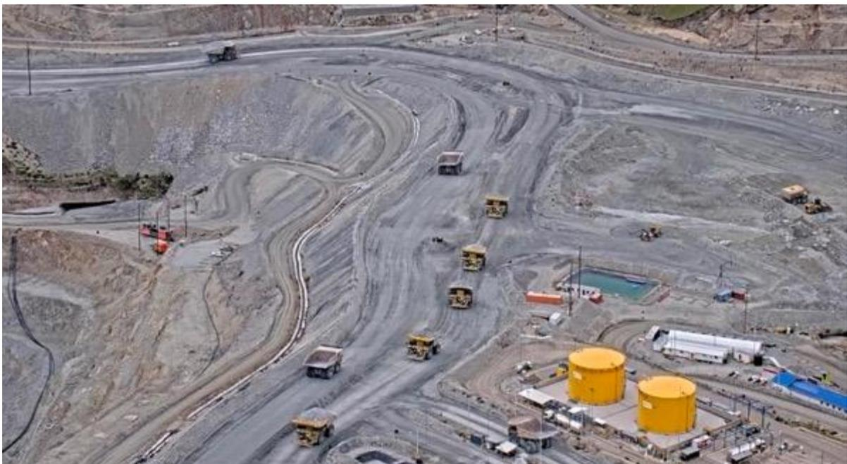
**Figura 102 — Camiones mineros acarreado desmonte hacia los botaderos.**
