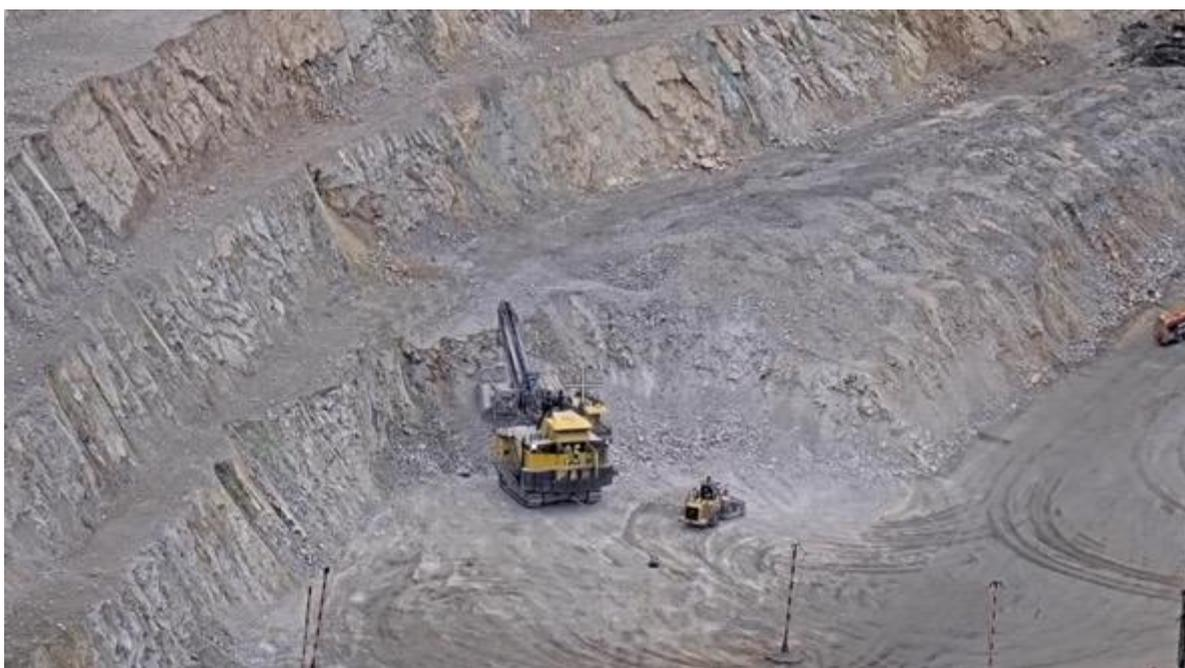
**Figura 100 — Pala eléctrica P&H 4100XPC esperando camiones para cargar.**
