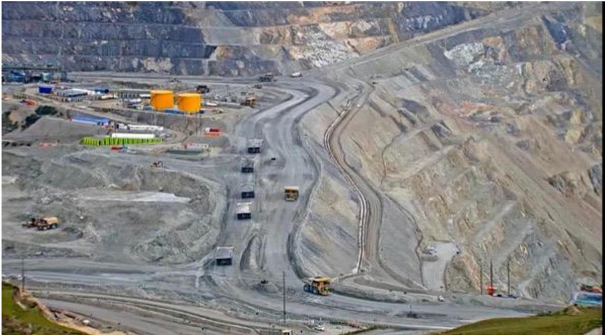
**Figura 101 — Camiones mineros acarreado mineral hacia chancadora primaria.**
