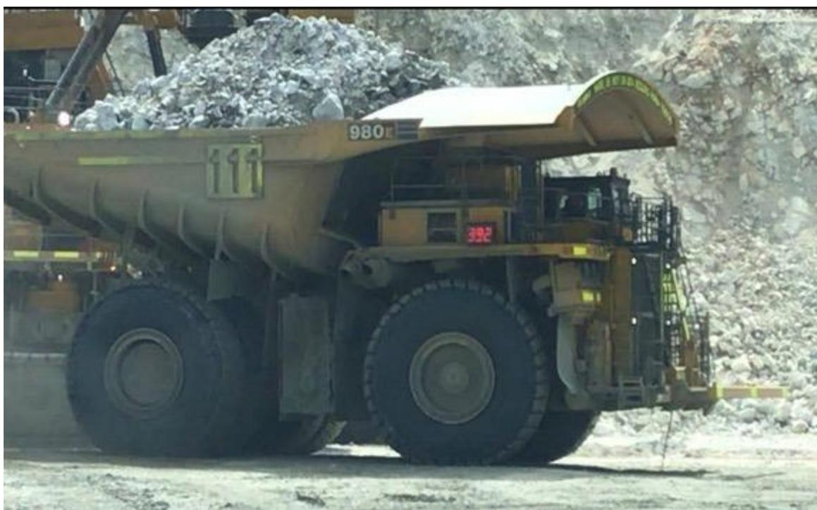
**Figura 97 — Camión Komatsu 980E registrando su carga útil (payload).**
