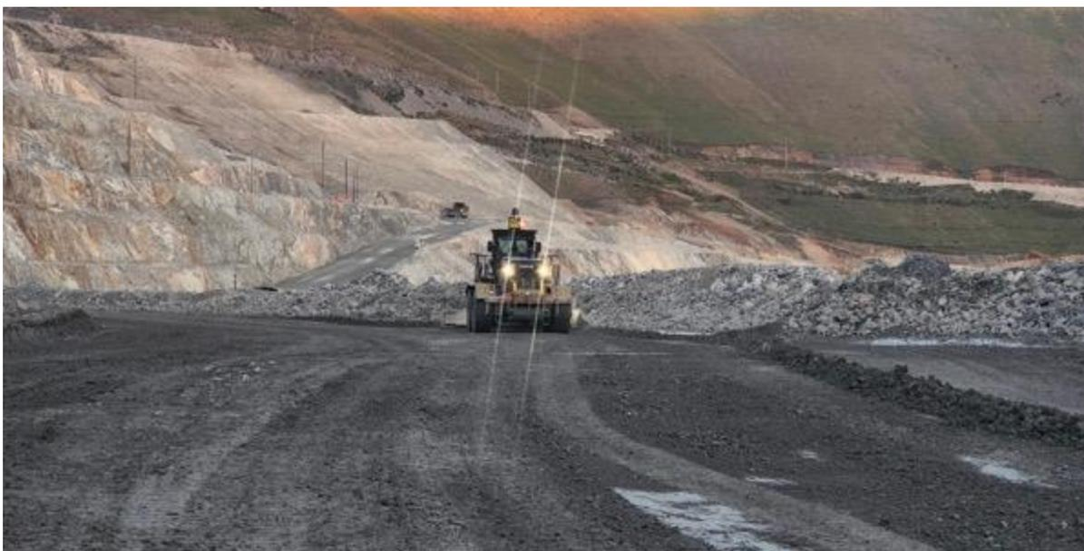
**Figura 105 — Motoniveladora realizando mantenimiento de las vías de acarreo.**
