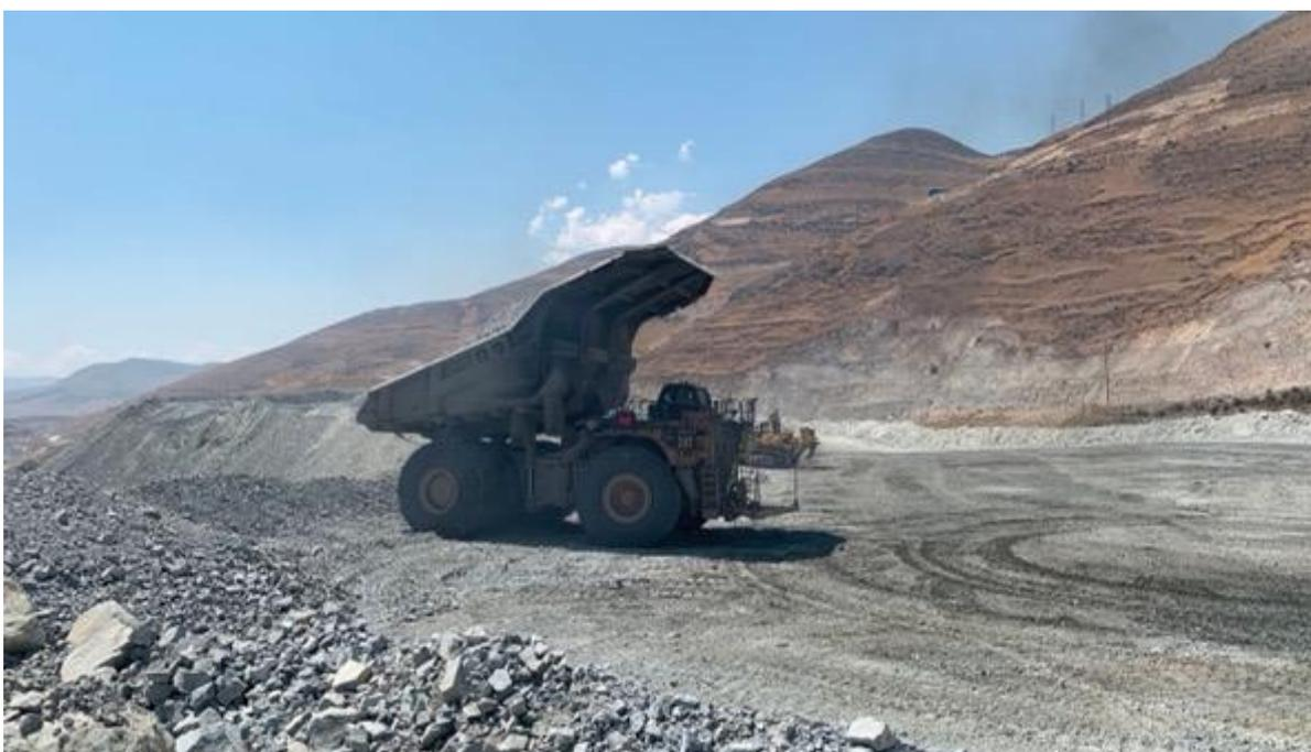
**Figura 103 — Camión minero descargando desmonte en el botadero.**
