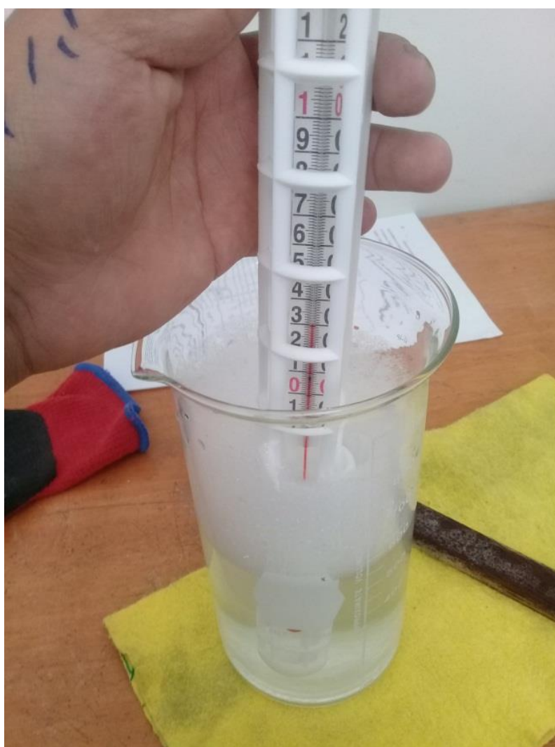
Figura 44 — Control de temperatura de la solución de detergente
