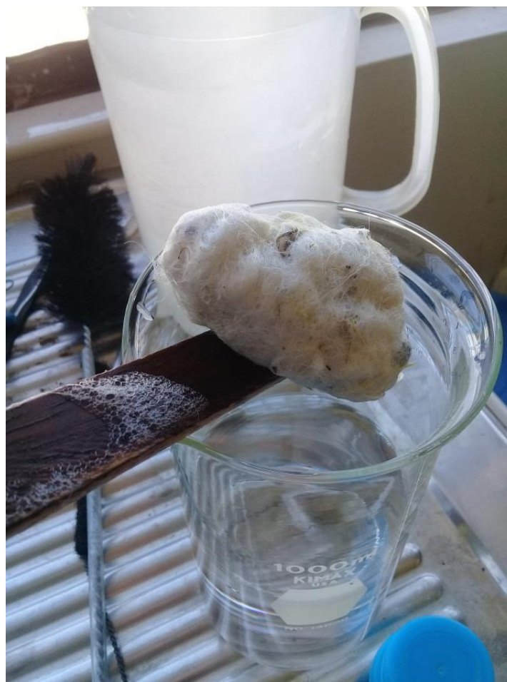
Figura 48 — Enjuagado de muestra fibra a 20°C y 60rpm
