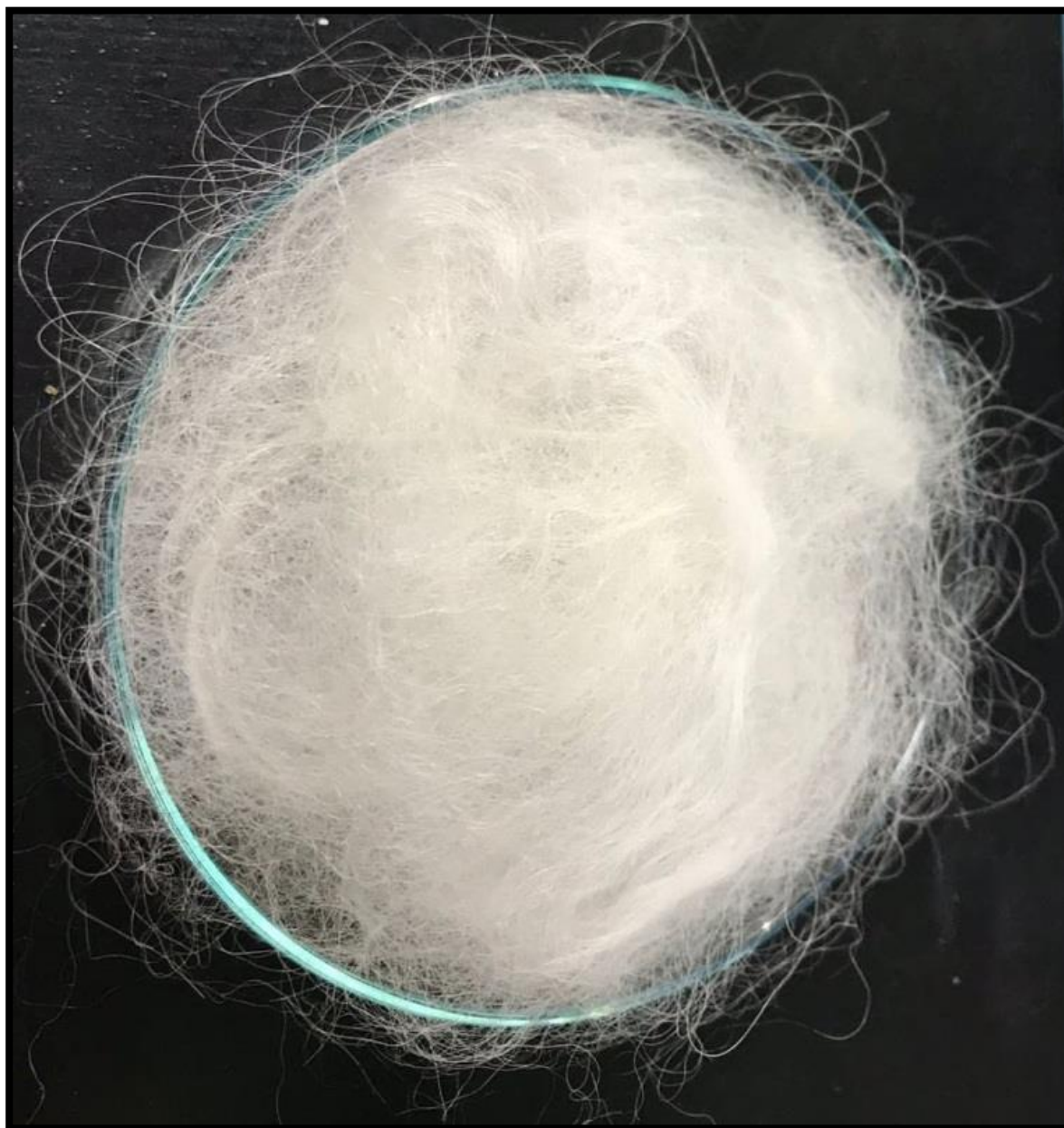
Figura 28 — Fibra de alpaca Suri lavado a 35°C con 1ml de Lipasa.
