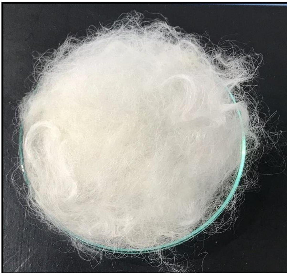
Figura 30 — Fibra de alpaca Suri lavado a 35°C con 40ml de Libre.
