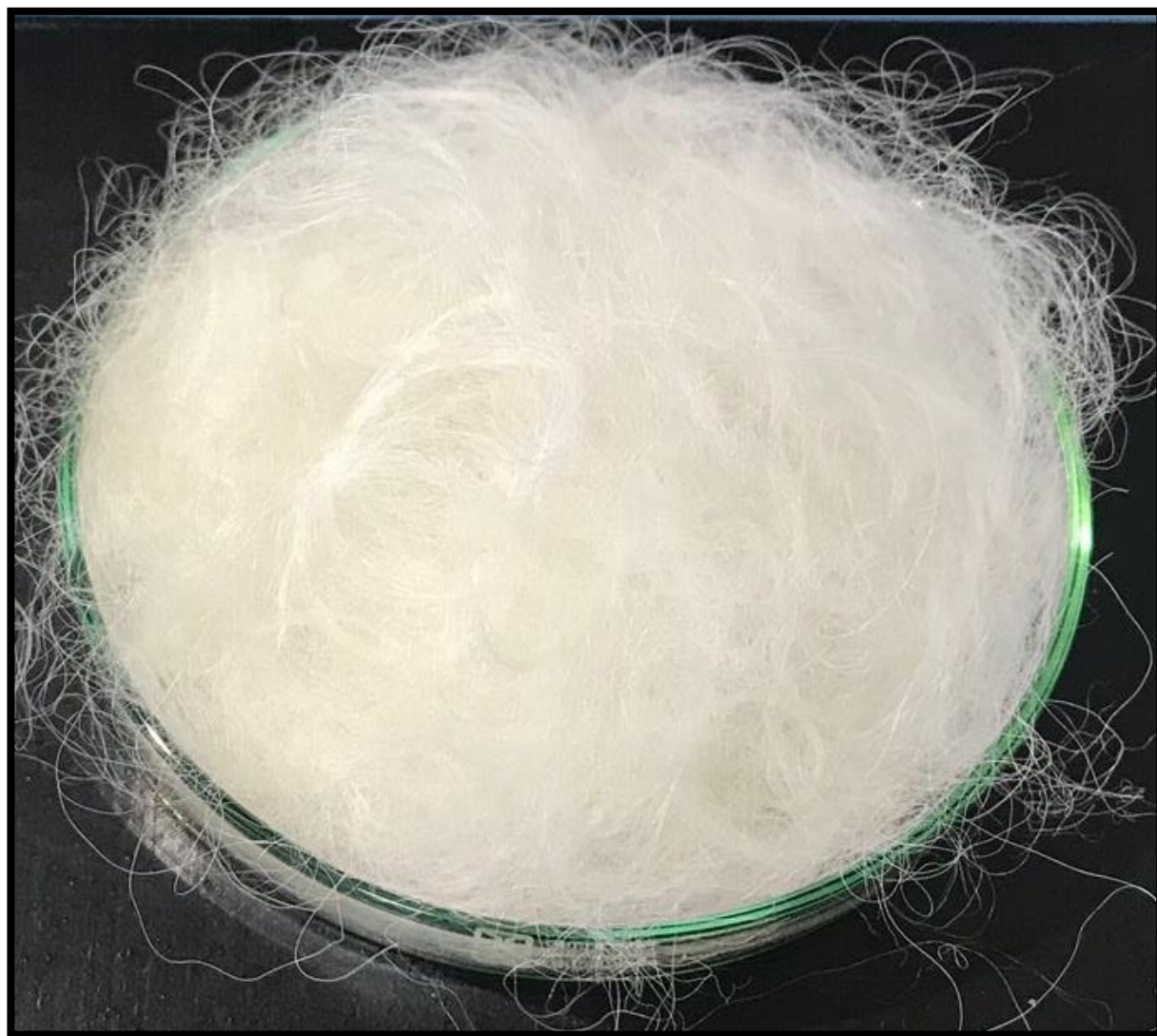
Figura 29 — Fibra de alpaca Suri lavado a 35°C con 40ml de Biopelícula.
