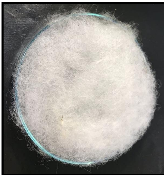
Figura 21 — Fibra de alpaca Huacaya lavada a 35 °C.
