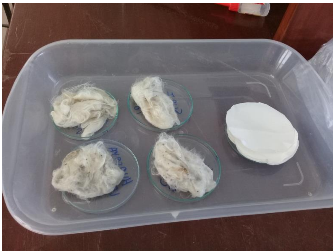
Figura 50 — Muestras de fibras lavadas listas para el secado a 80 ° C en la estufa
