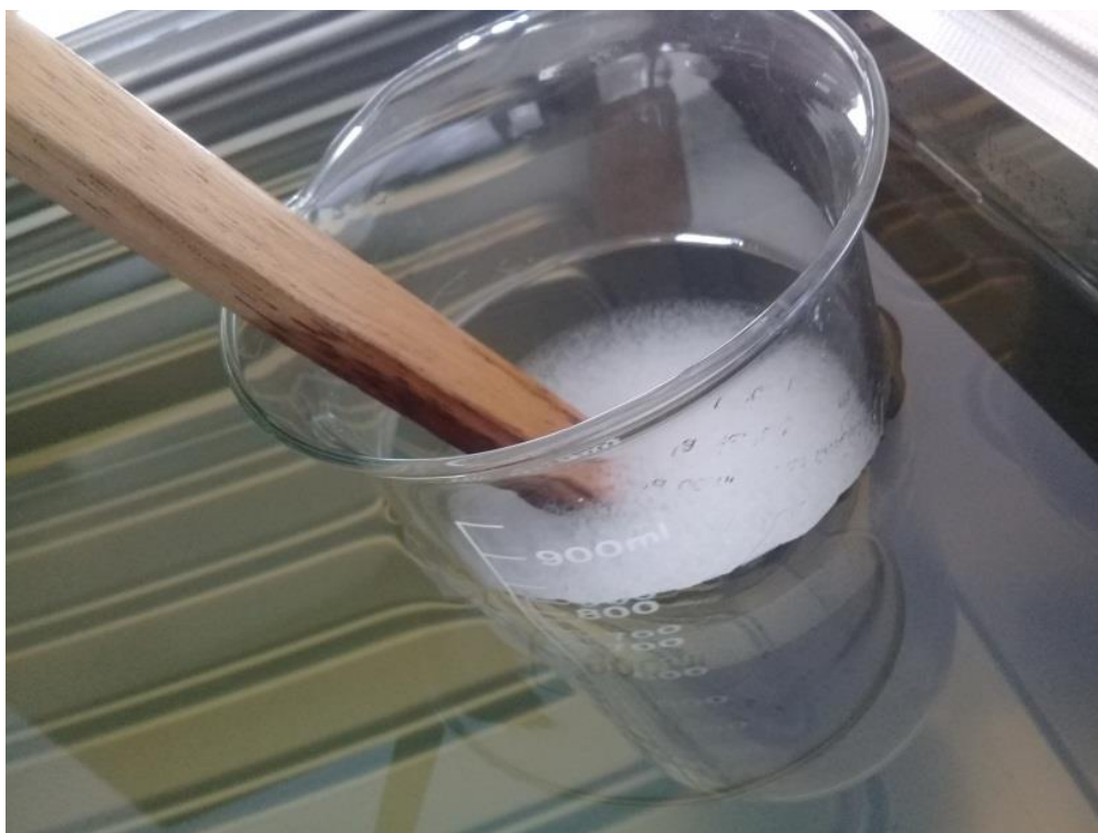
Figura 47 — Lavado de muestra fibra a 35°C a 60 rpm
