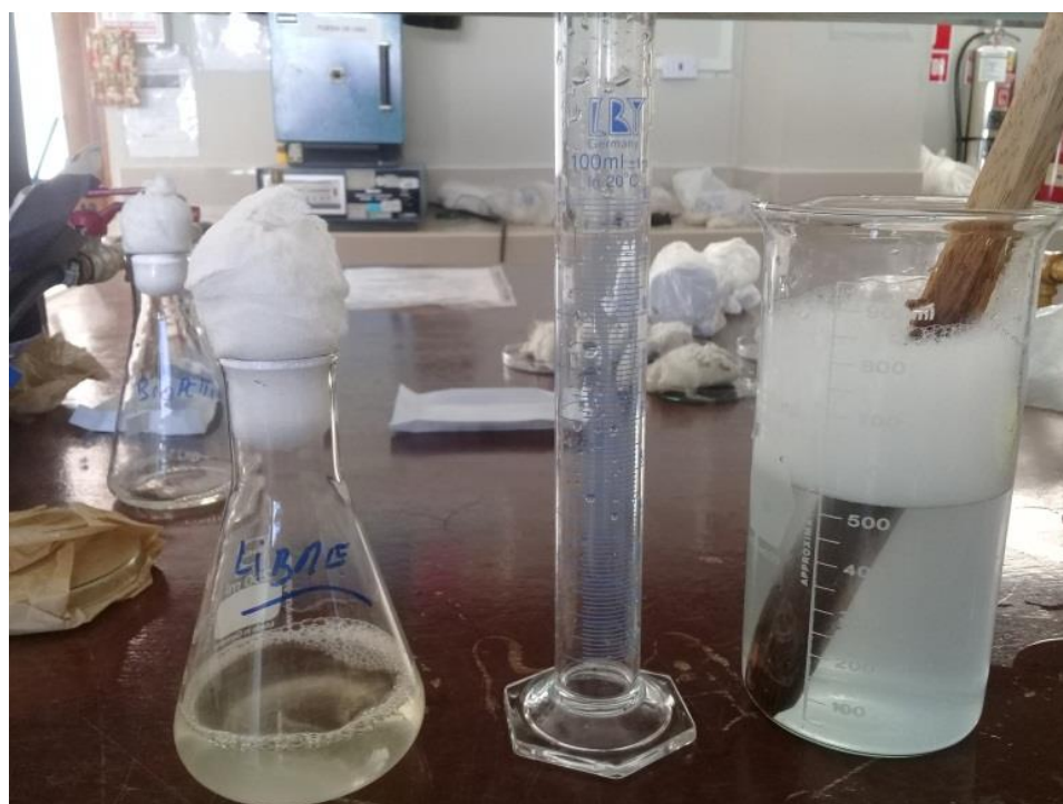
Figura 46 — Adición de enzima a la solución detergente
