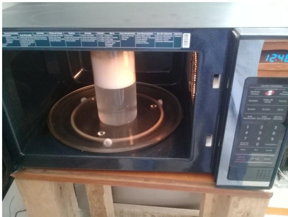
Figura 43 — Calentado hasta 35°C de la solución de detergente - agua
