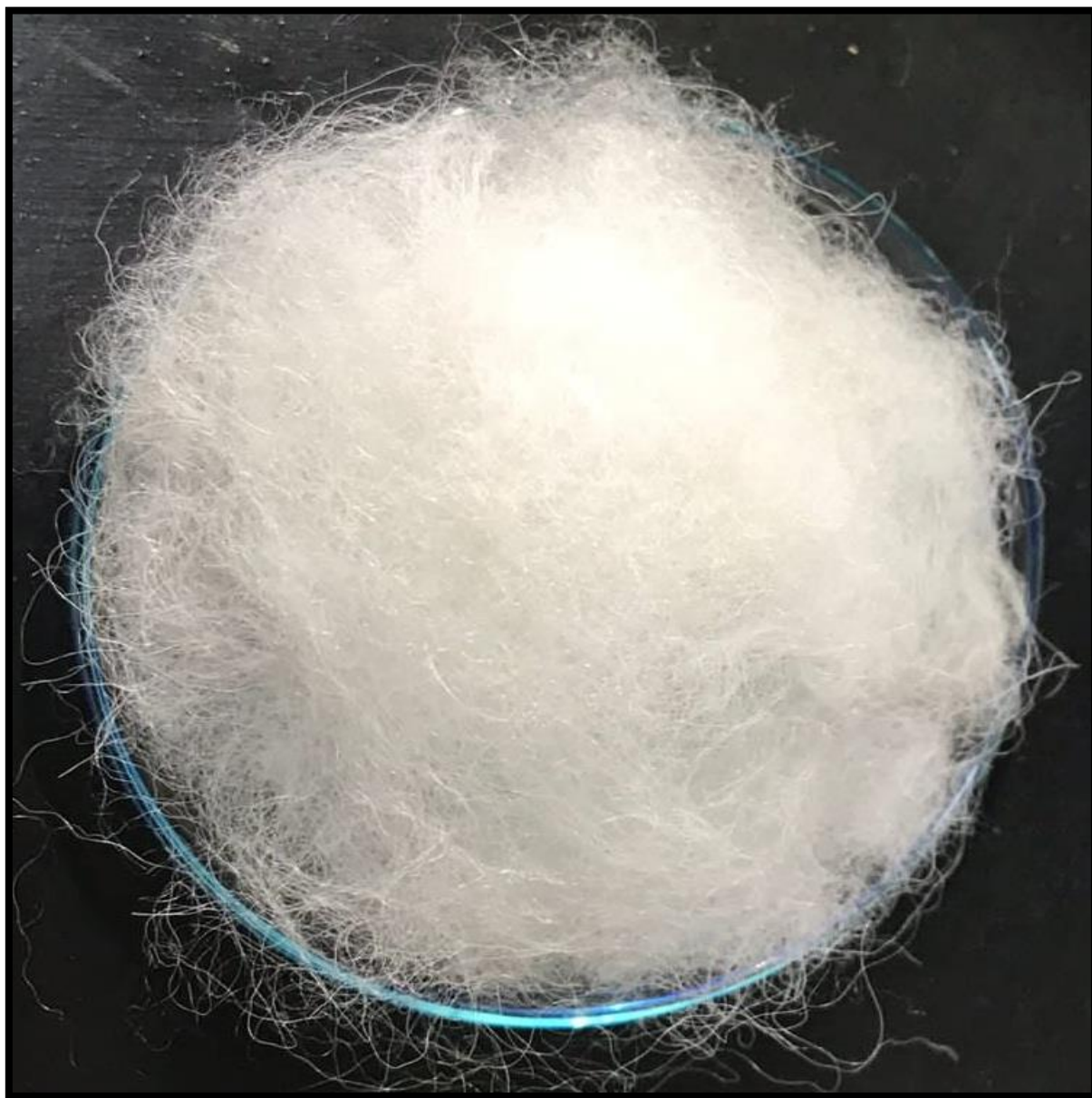
Figura 31 — Fibra de alpaca Huacaya lavado a 35°C con 0.5ml de Lipasa.
