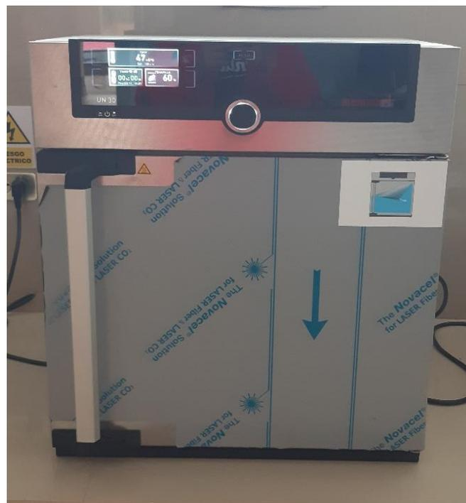
Figura 37 — Estufa para determinar humedad
