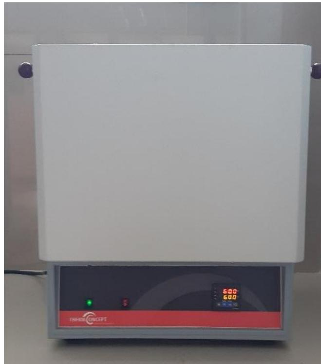
**Figura 38 — Mufla para determinar cenizas**
