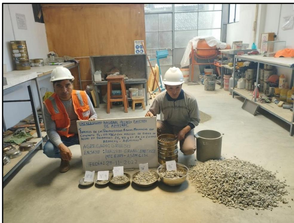
Figura 45 — Análisis granulométrico del agregado grueso
