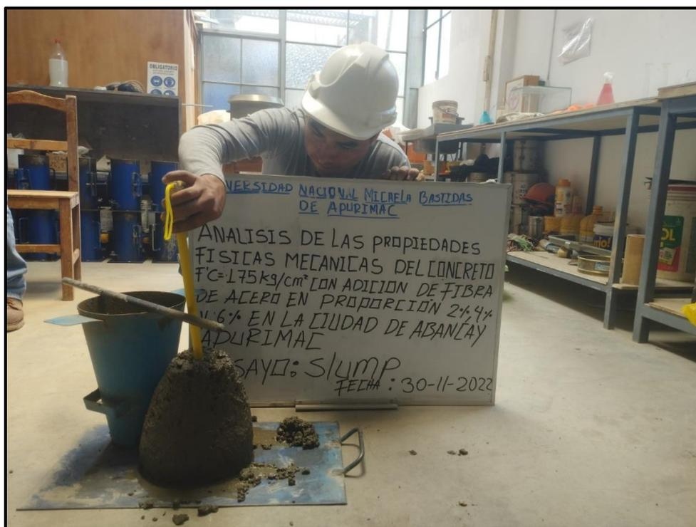
Figura 49 — Ensayo de asentamiento en concreto fresco
