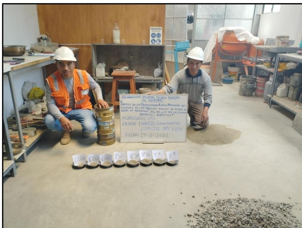
Figura 44 — Estudio granulométrico del agregado fino
