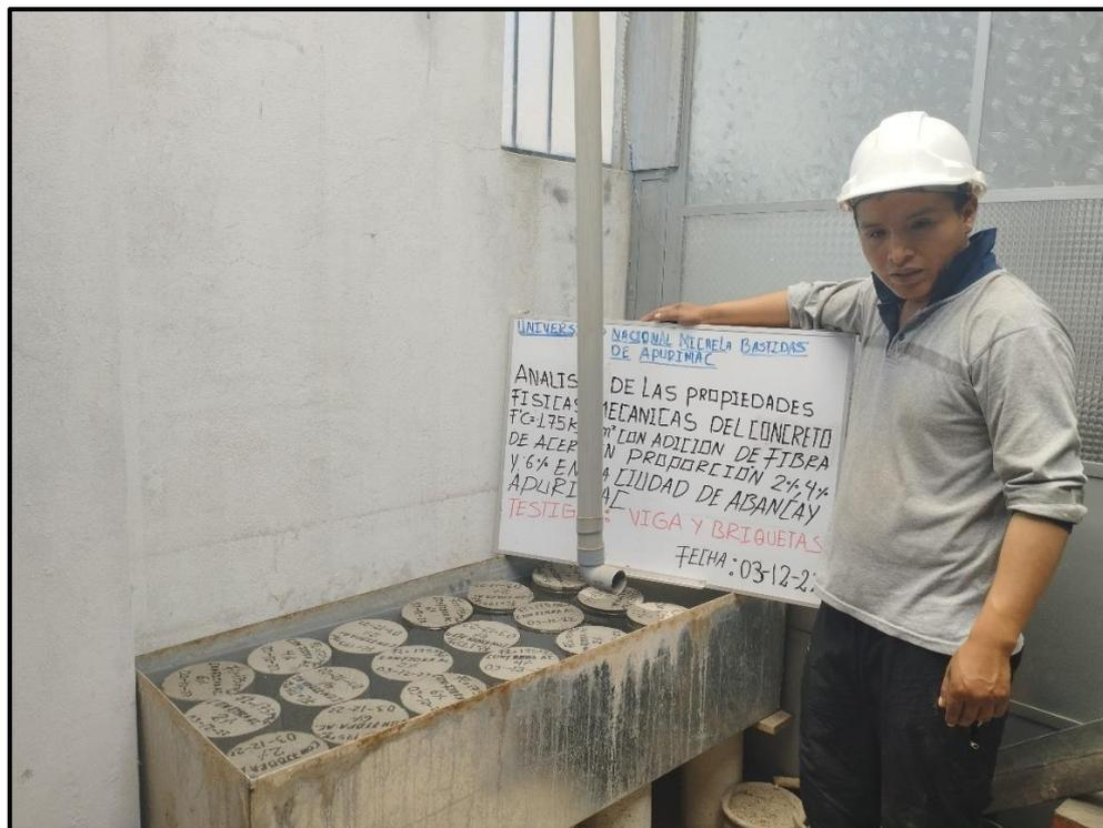
Figura 51 — Proceso de curado de los testigos
