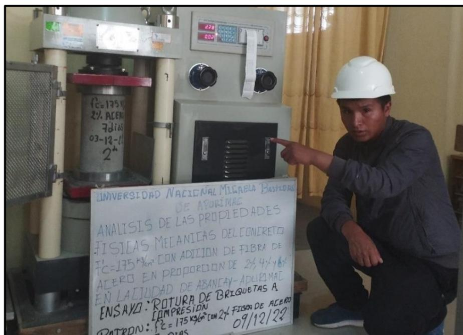
Figura 16 — Determinación de la resistencia a compresión
