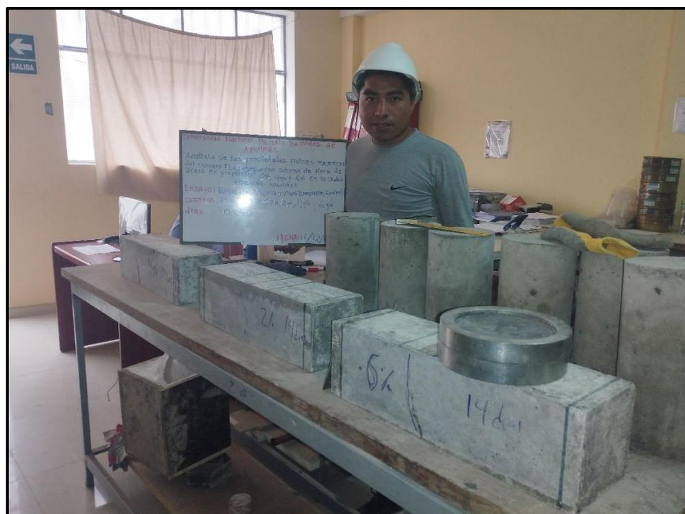
Figura 52 — Testigos para las respectivas roturas como cilíndrico y viga
