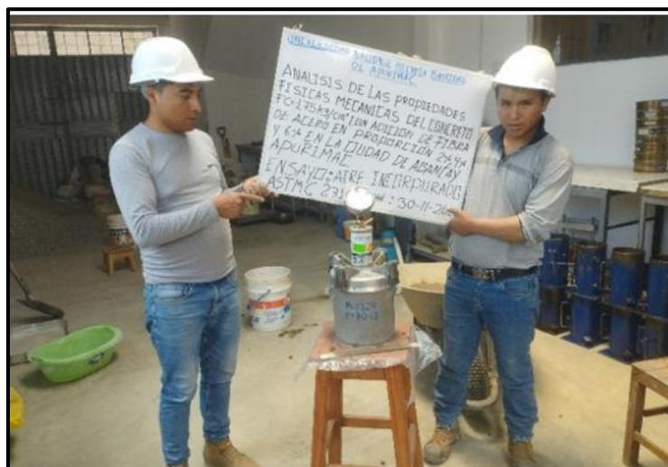
**Figura 26** — Ensayo del aire atrapado en el concreto con olla de Washington
