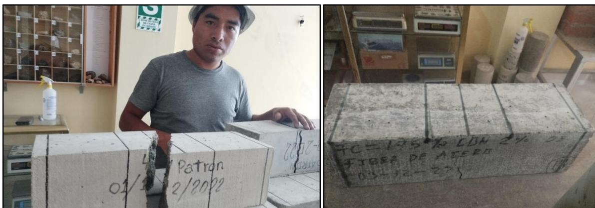
**Figura 18** — Falla frágil y fisuración de los testigos prismáticos
