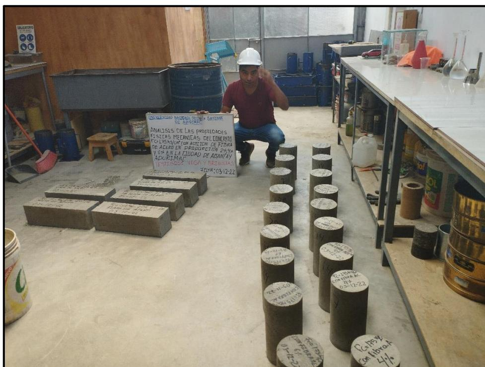
Figura 50 — Testigos de concreto 175 kg/cm<sup>2</sup> para los ensayos
