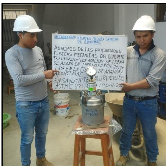
**Figura 14** — Ensayo del aire atrapado en el concreto
