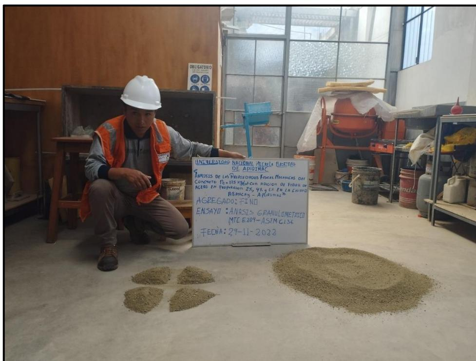
Figura 43 — Extracción de material para los ensayos
