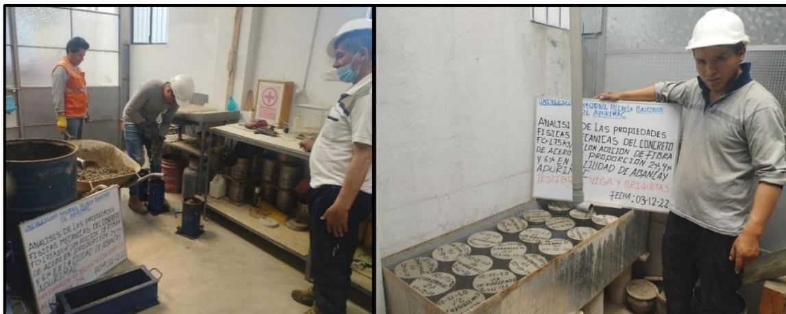
Figura 15 — Elaboración y curado de muestras cilíndricas
