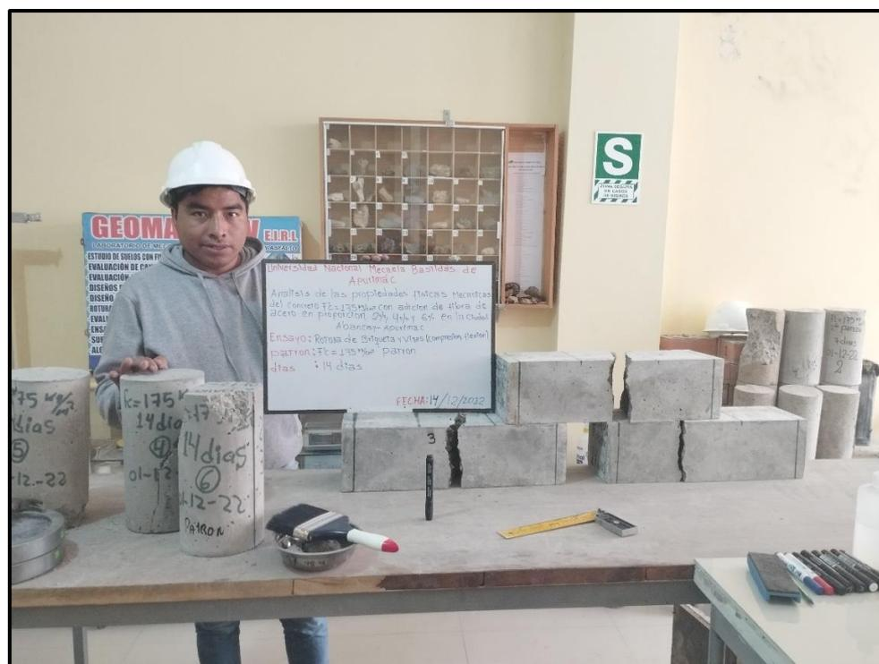
Figura 54 — Tipos de falla de los testigos de vigas y cilindros después del ensayo
