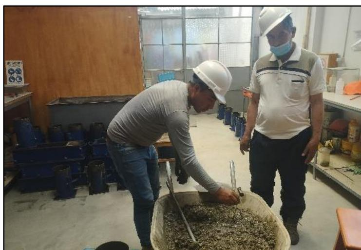
**Figura 23** — Control de temperatura en el concreto en su estado fresco sin/con fibra de acero
