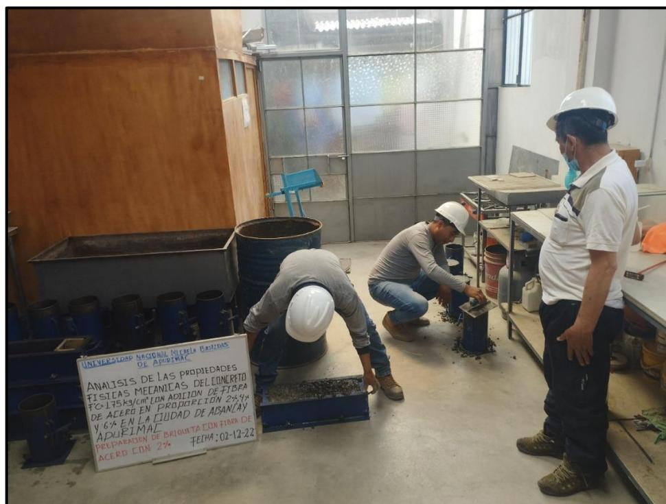
Figura 48 — Elaboración de testigos para los ensayos
