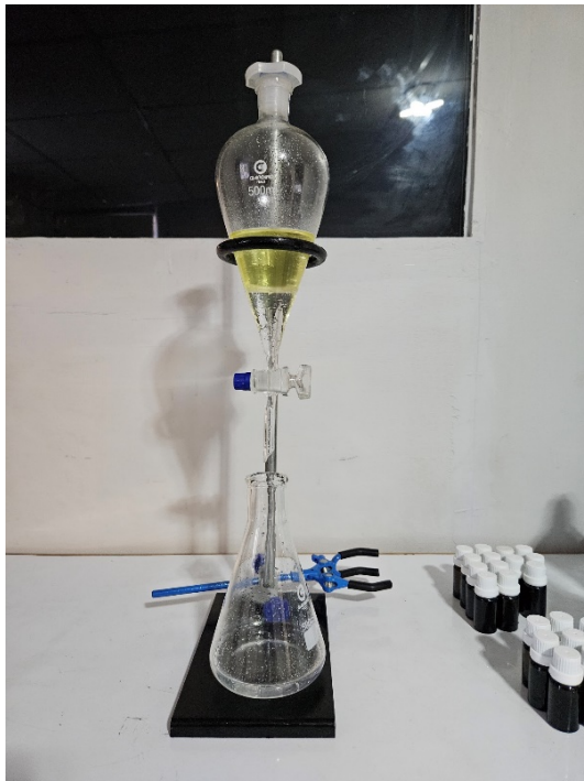
Fotografía 14 — Proceso de decantación y estabilización del aceite esencial.
