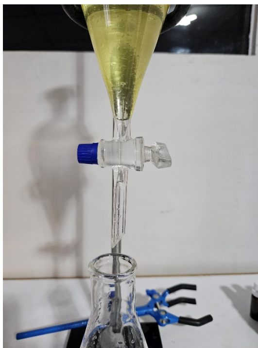
Fotografía 15 — Eliminación del hidrolato, mediante la llave de la pera.
