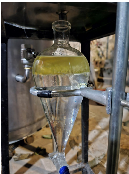
Fotografía 13 — Recolección del aceite e hidrolato en una pera de decantación directamente del equipo.
