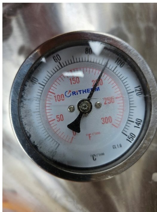
Fotografía 12 — Indicador de temperatura alcanzada en el proceso de extracción, tratamiento hidrodestilación.
