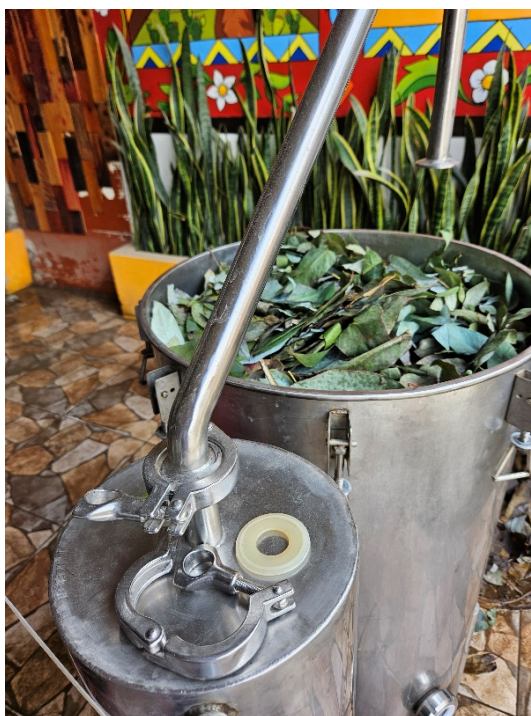
Fotografía 07 — Equipo destilador cargado completamente para iniciar la extracción de aceite esencial por arrastre de vapor
