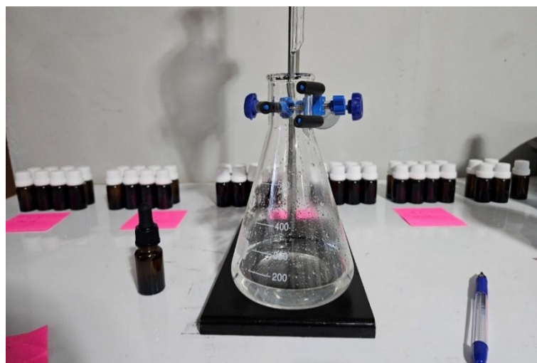
Fotografía 16 — Hidrolato separado del aceite esencial.
