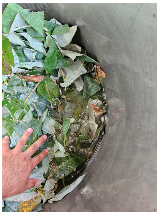
Fotografía 10 — Hojas de eucalipto sumergidas en agua para el tratamiento de hidrodestilación.
