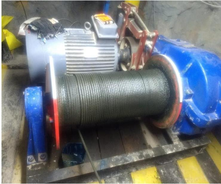
**Figura 28 — Tambora del winche eléctrico modelo WGR3V**
