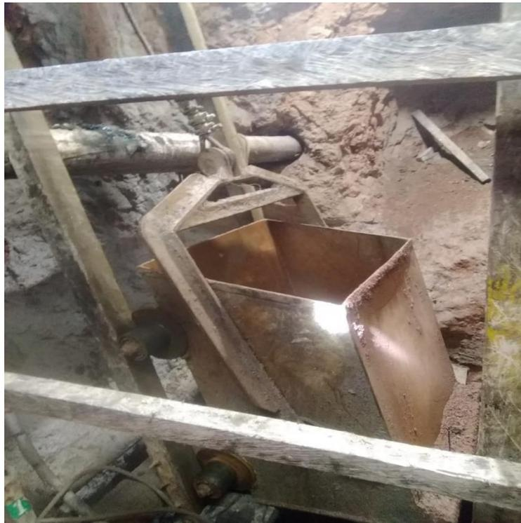
**Figura 30 — Realizando prueba en vacío del Skips**
