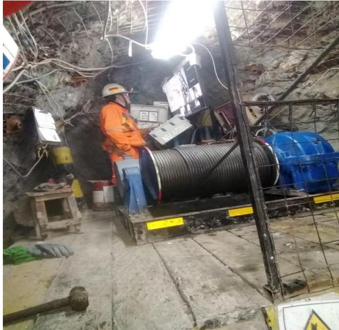
Figura 26 — Operando el sistema de izaje con Skips en el PQ 4580
