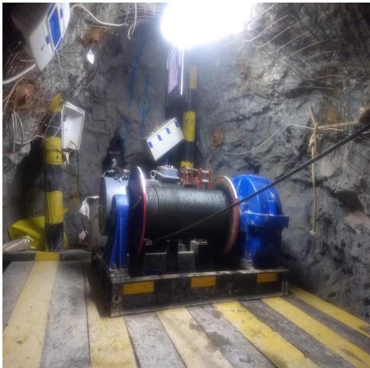
**Figura 29 — Camara del operador implementado con el sistema de comunicación e izaje**
