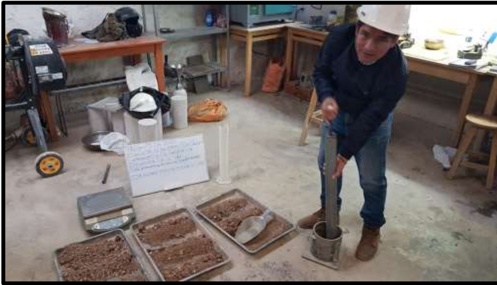
Figura 69 — Ensayo de Proctor Modificado
