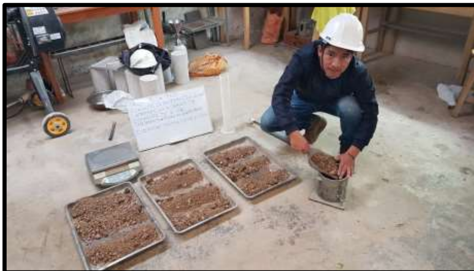
Figura 67 — Ensayo de Densidad máxima seca
