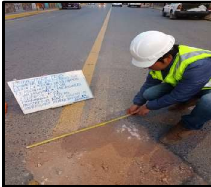
Figura 56 — Medición de las dimensiones de la Calicata
