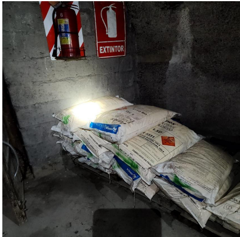
Figura 25 — ANFO utilizado en la voladura
