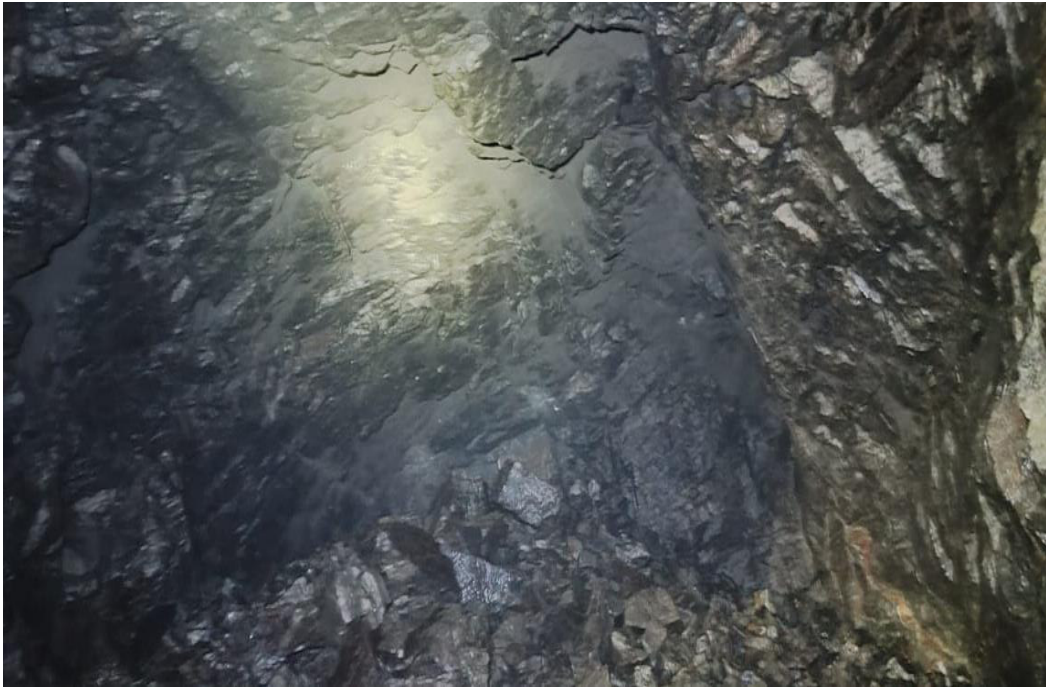
Figura 21 — Resultado de voladura con explosivo Emulsión
