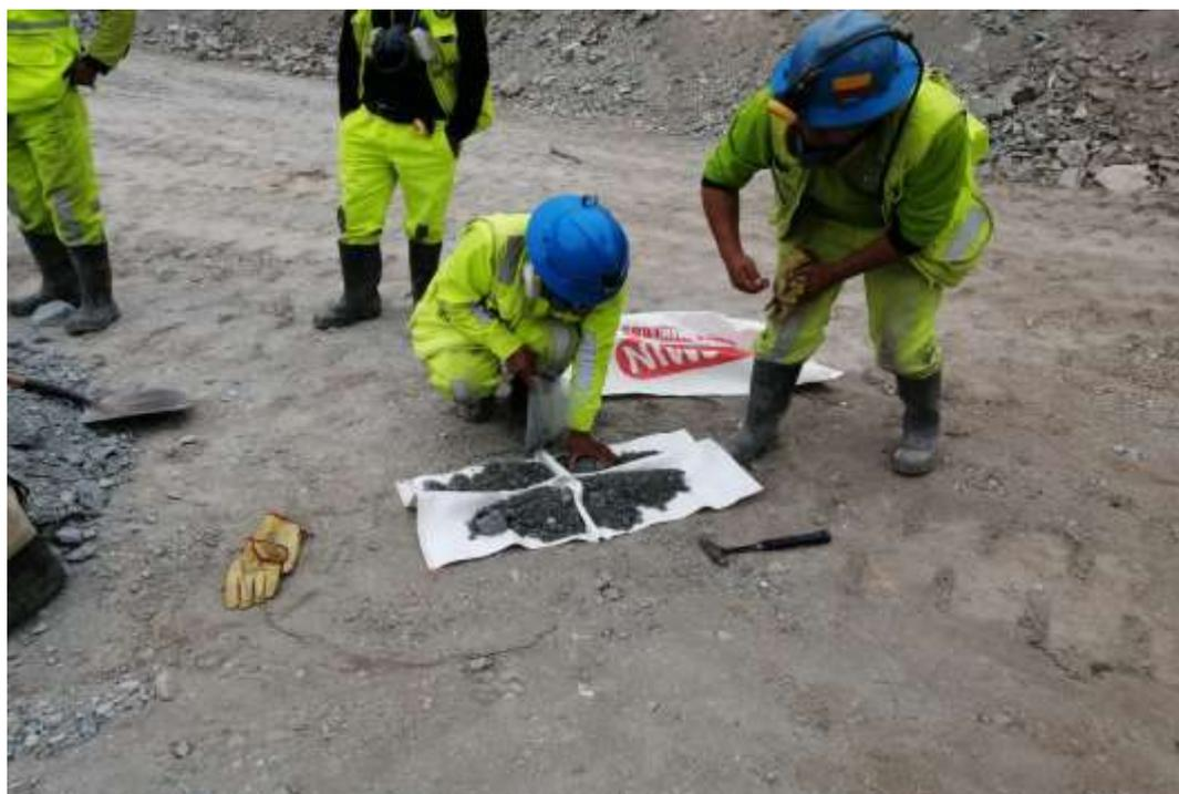
**Figura 18 — Cuarteo de muestra para realizar la estimación de propiedades físicas**
