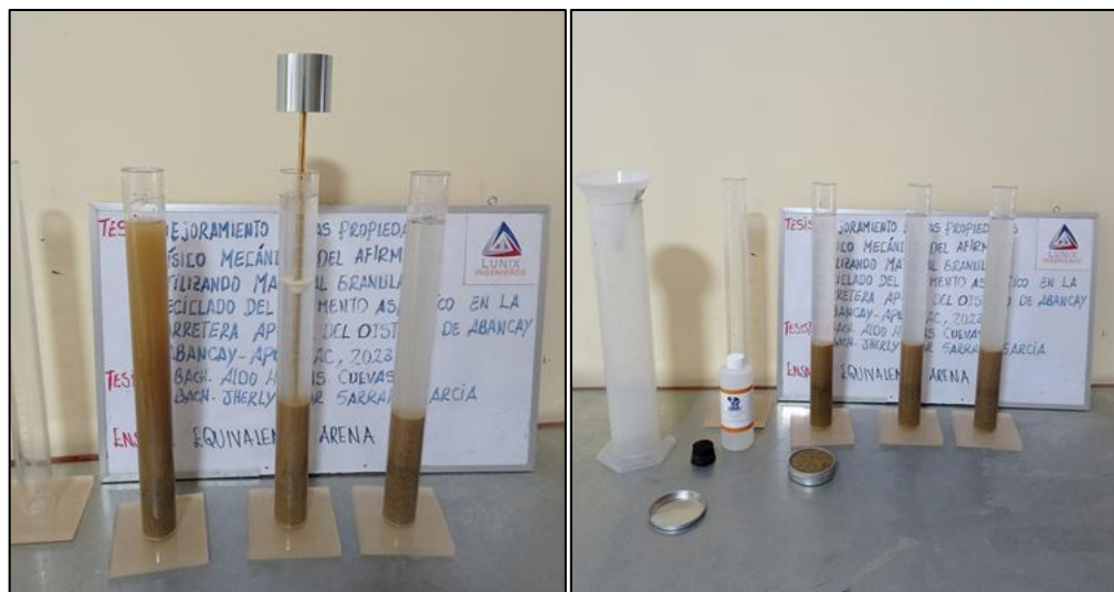
Figura 135 — Ensayo de equivalente de arena
