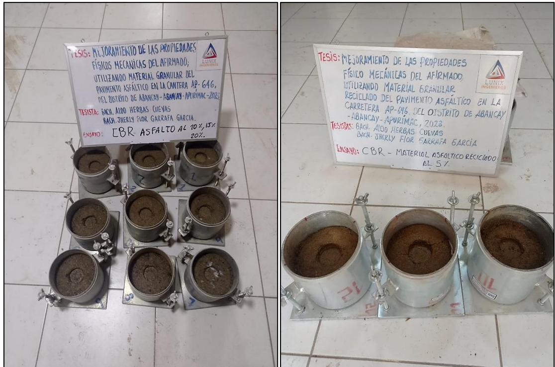
Figura 156 — Culminación de penetración de las muestras con adición de RAP al 5 %, 10 % y 20 %
