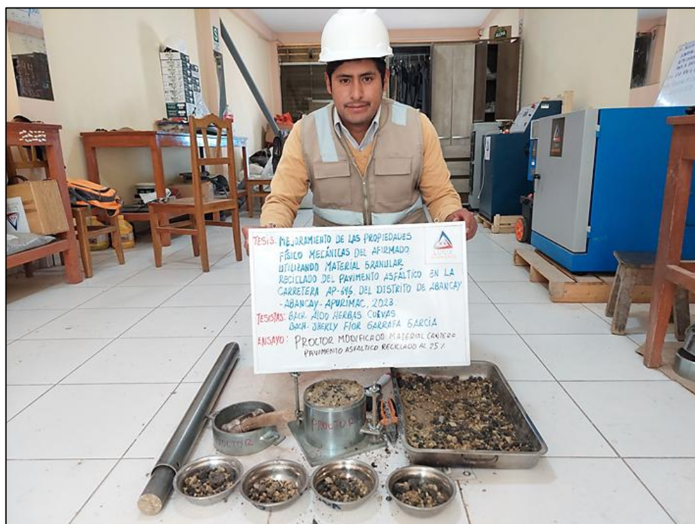
Figura 139 — Proctor modificado del afirmado con adición de RAP al 25 %
