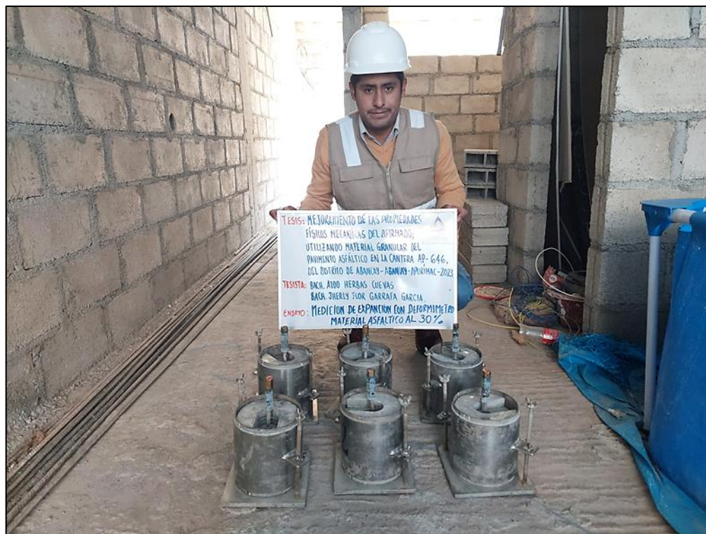
Figura 152 — Preparativos para la inmersión de la muestra con adición de RAP al 30 %
