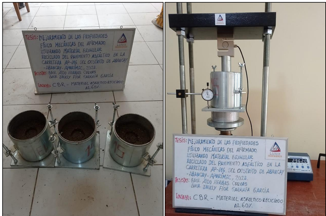
Figura 157 — Penetración de la muestra con adición de RAP al 60 %
