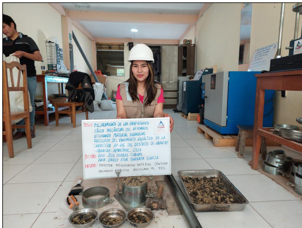
Figura 140 — Proctor modificado del afirmado con adición de RAP al 45 %
