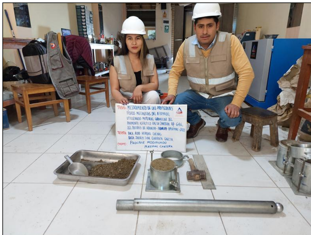
Figura 136 — Proctor modificado del afirmado con adición de RAP al 0 %
