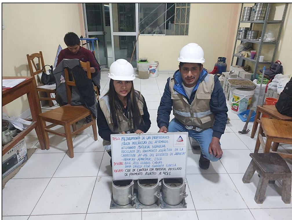
Figura 155 — Culminación de penetración de la muestra con adición de RAP al 45%
