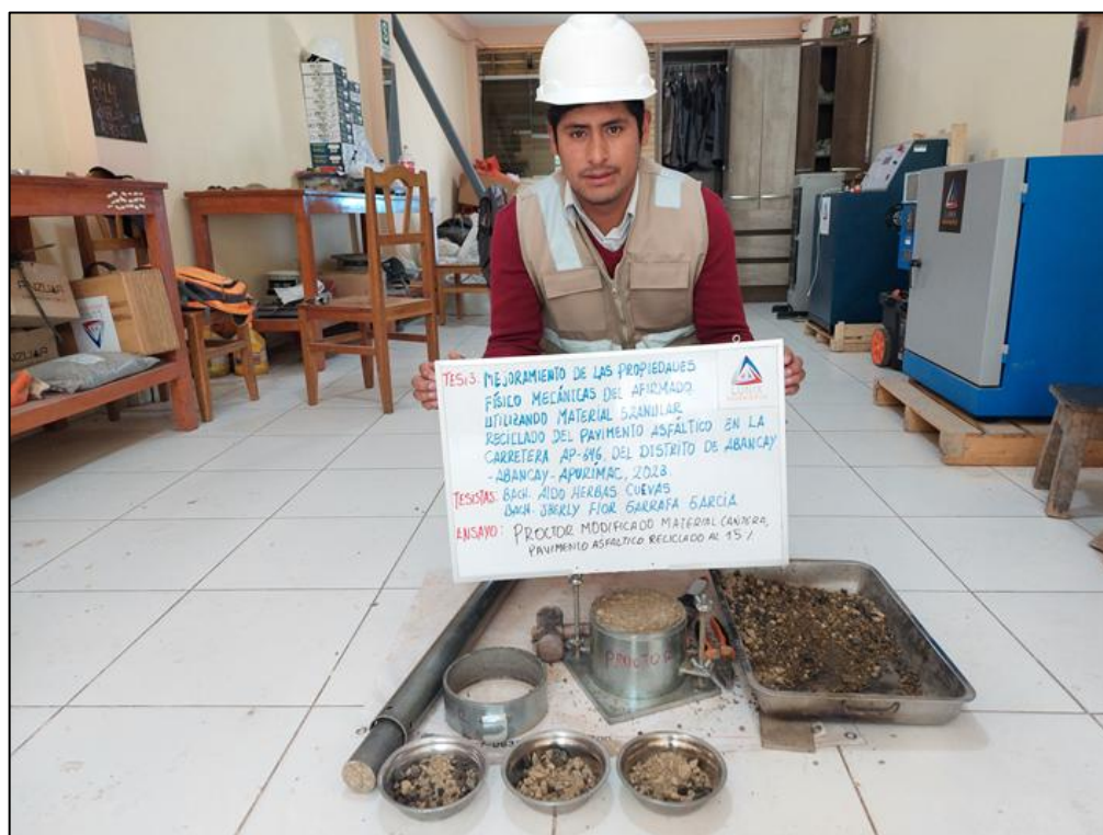
Figura 137 — Proctor modificado del afirmado con adición de RAP al 15 %
