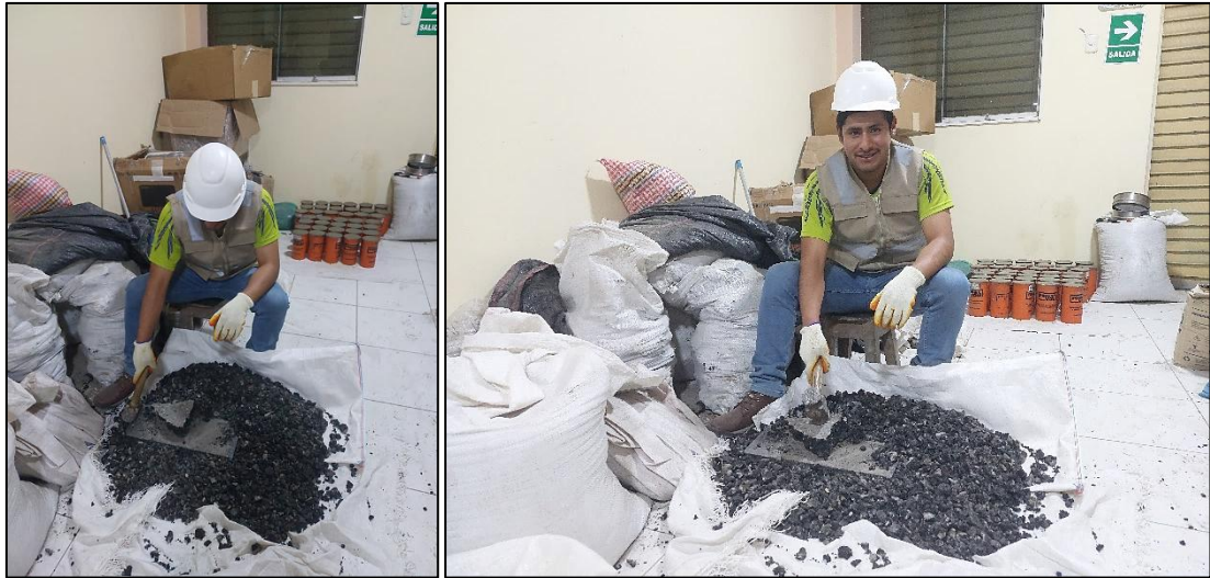
Figura 130 — Trituración y preparación del pavimento asfáltico reciclado
