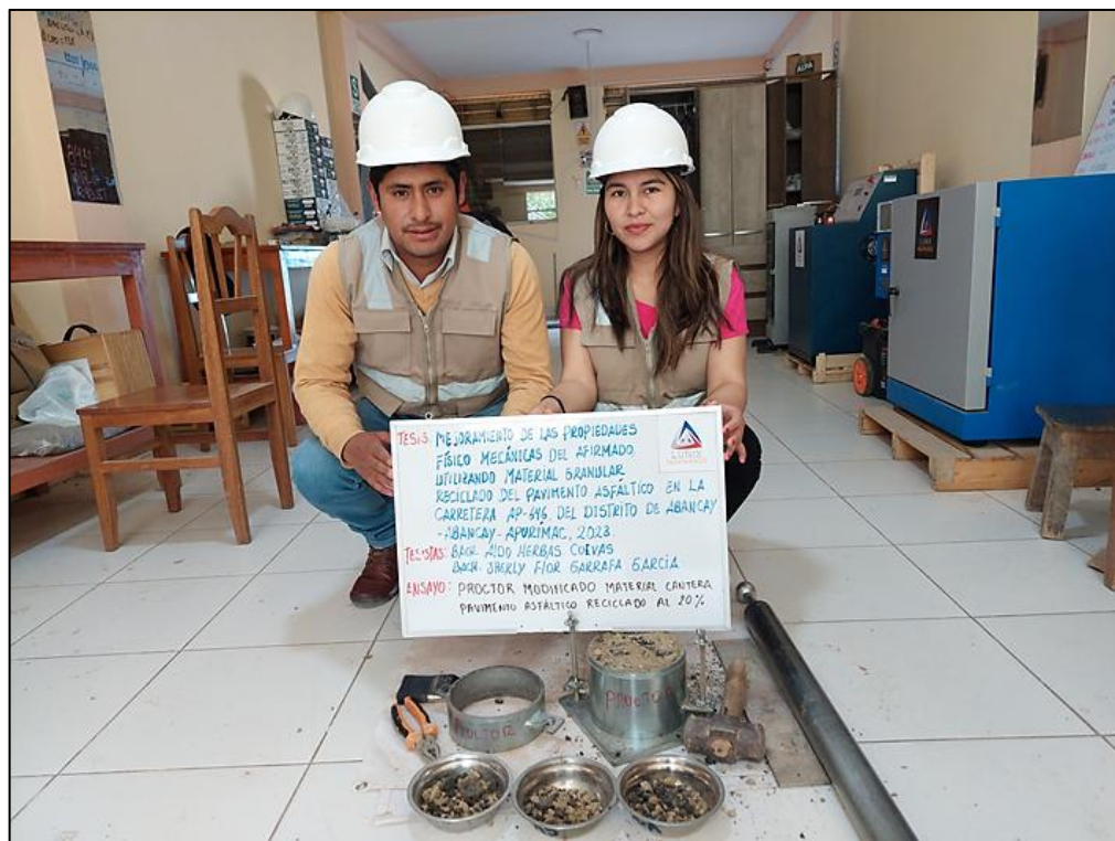
Figura 138 — Proctor modificado del afirmado con adición de RAP al 20 %
