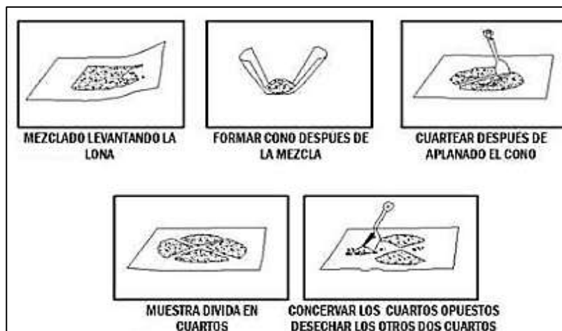
Figura 6 — Cuarteo de muestras sobre una lona
