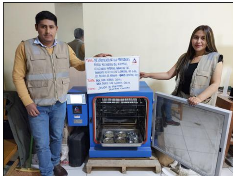
Figura 134 — Secado de muestras en horno.
