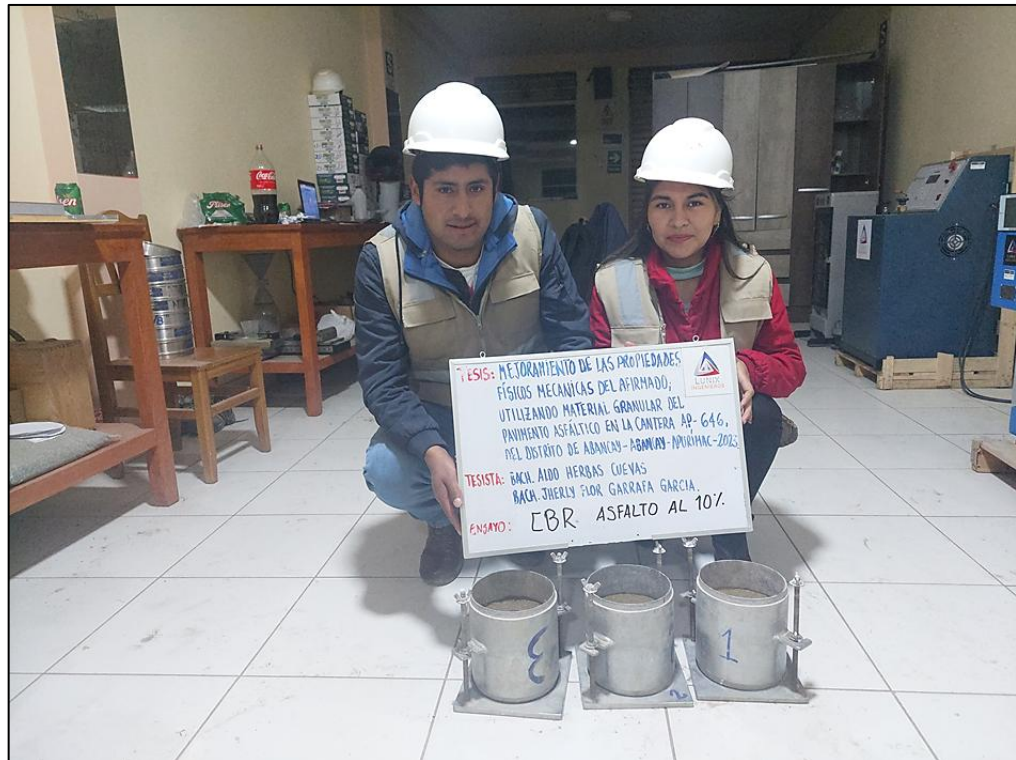
Figura 144 — Compactación de la muestra con adición de RAP al 10 %
