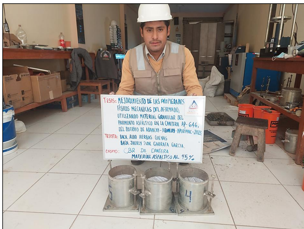
Figura 153 — Compactación de la muestra con adición de RAP al 45 %
