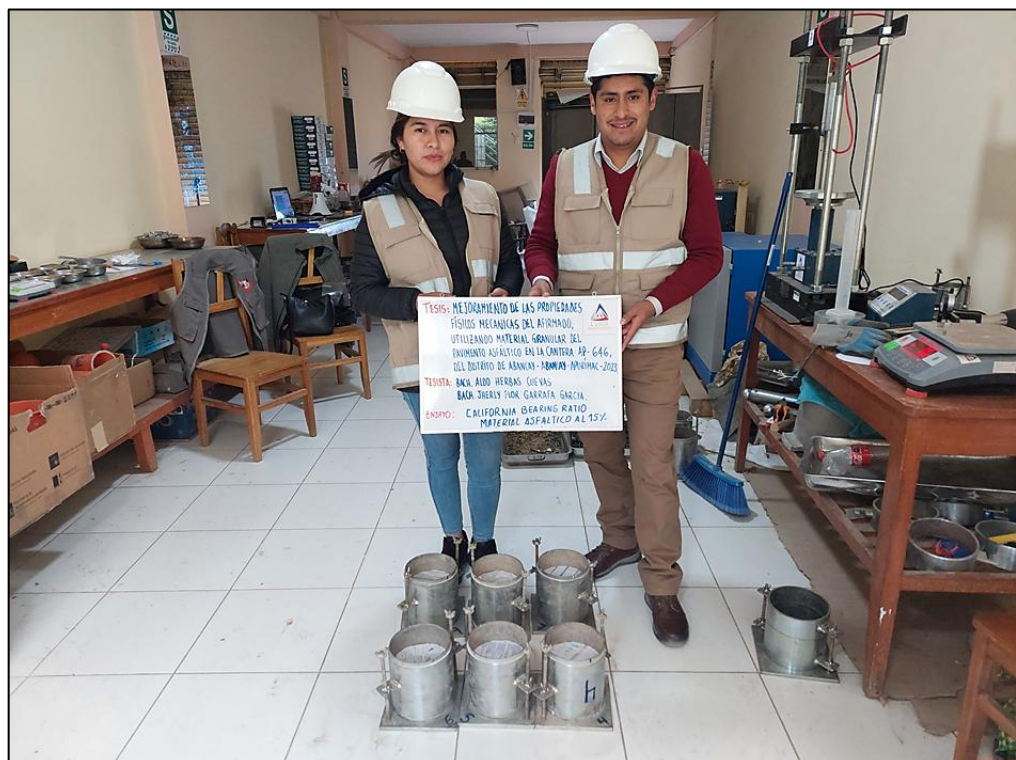
Figura 145 — Compactación de la muestra con adición de RAP al 15 %
