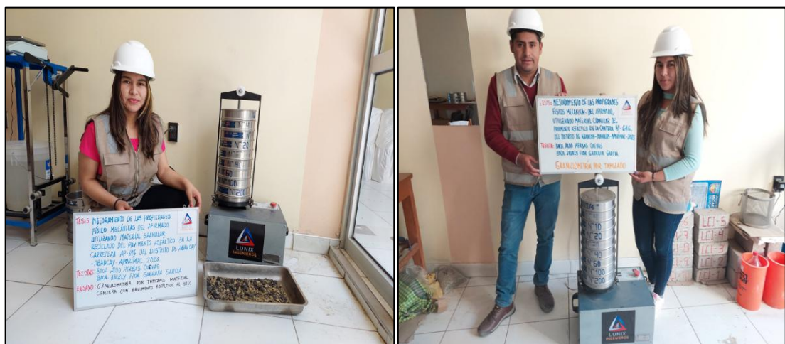
Figura 132 — Análisis granulométrico mediante tamizadora mecánica
