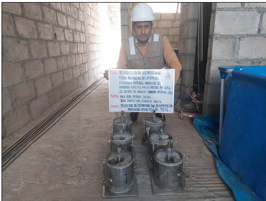
Figura 154 — Preparativos para la inmersión de la muestra con adición de RAP al 45 %
