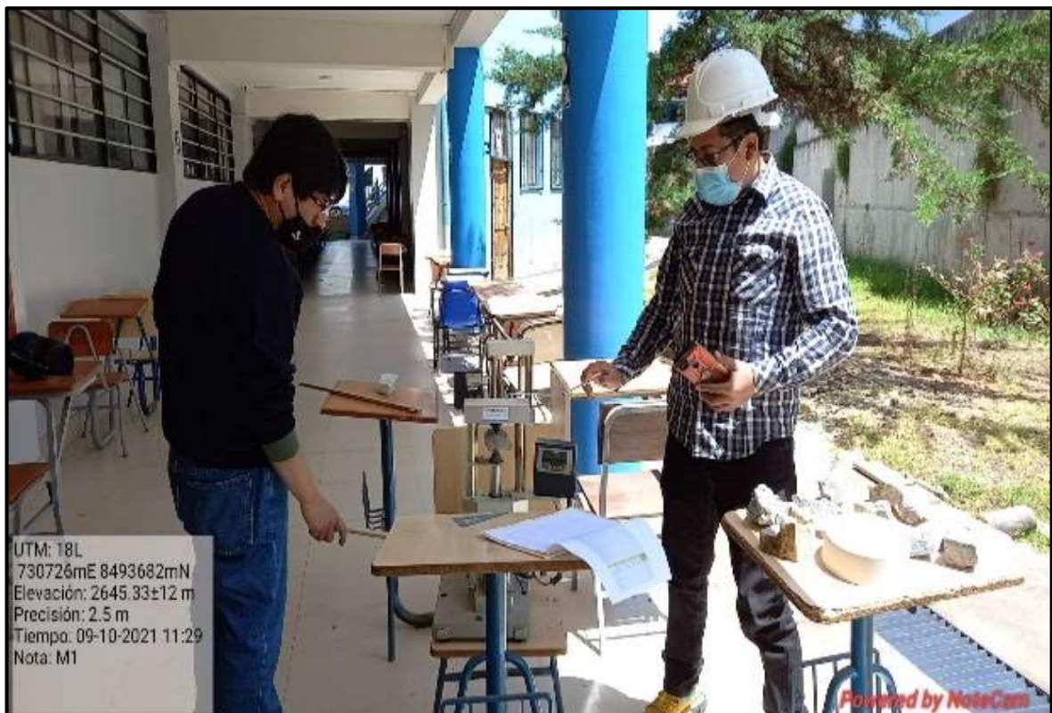
Figura 69 — Realización de ensayos con el uso de equipo de carga puntual
