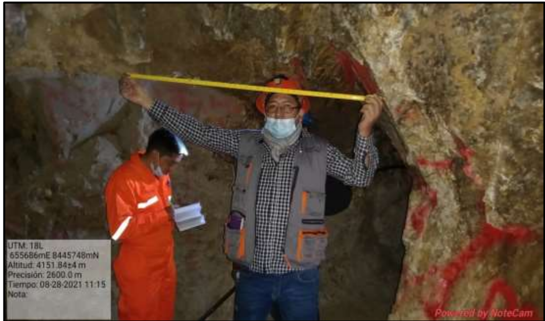
Figura 62 — Medición de la geometría de la sección para la caracterización geomecánica de la galería nivel 4040
