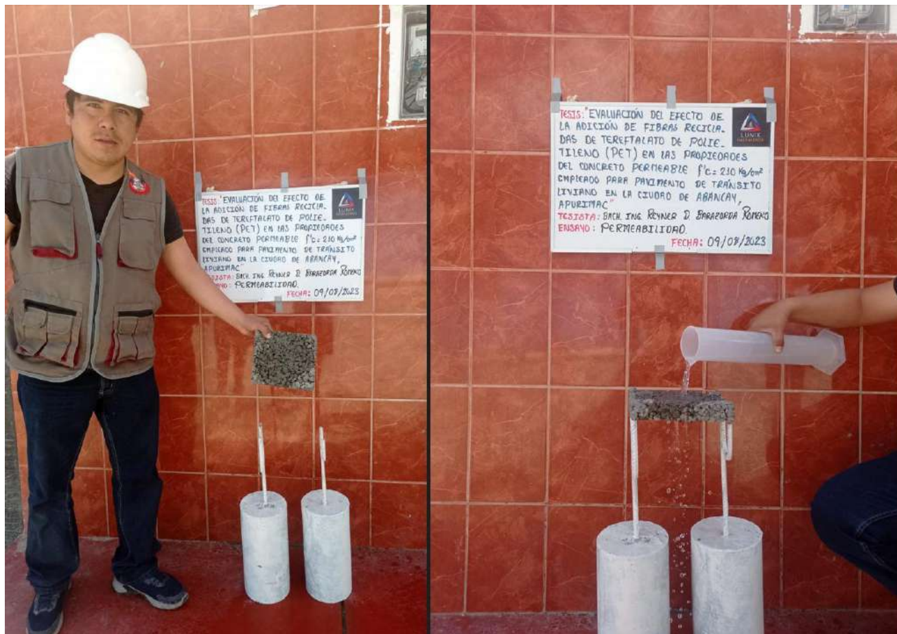
Figura 61 — Ensayo de permeabilidad a un prisma rectangular de concreto permeable
