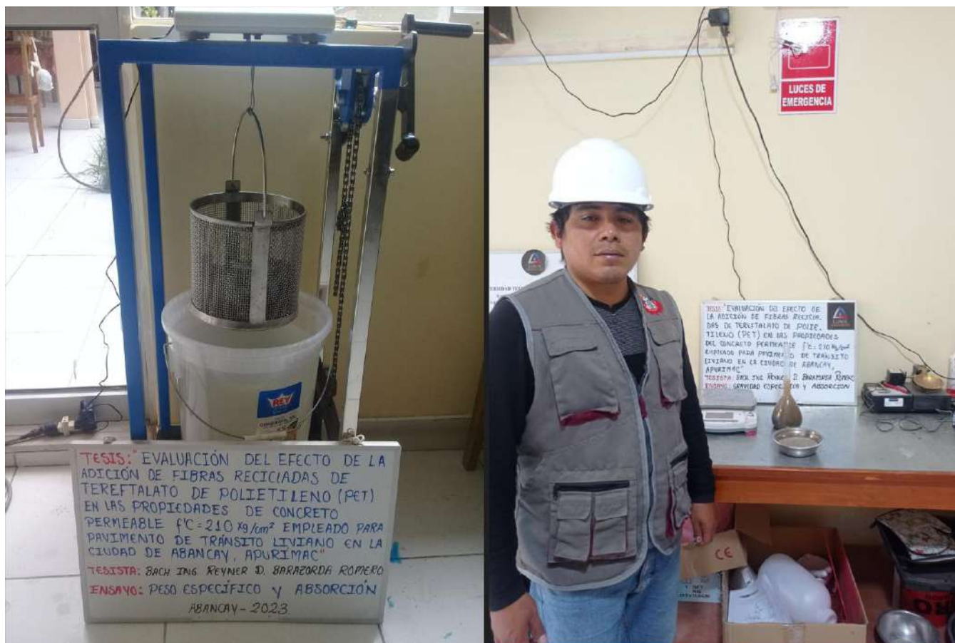
Figura 49 — Peso específico y absorción del agregado grueso; gravedad específica y absorción del agregado fino
