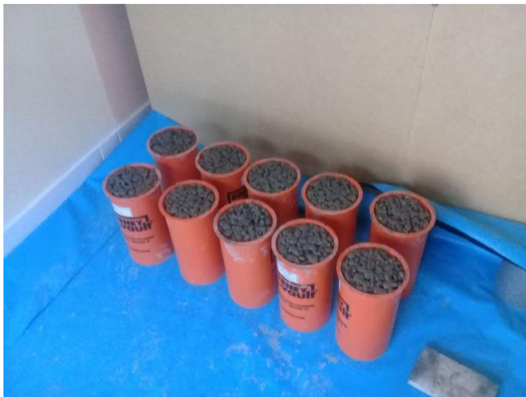
Figura 53 — Elaboración de especímenes de concreto permeable
