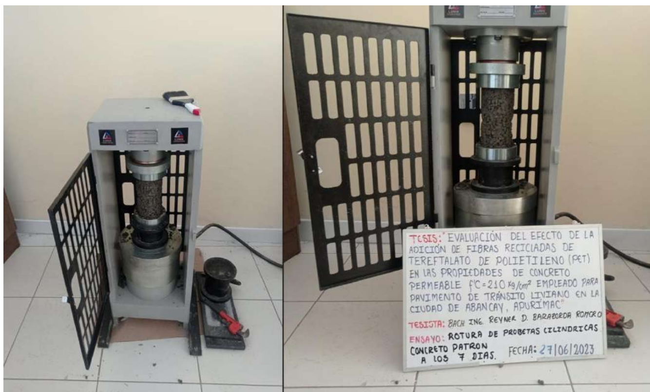
Figura 55 — Rotura de probetas cilíndricas de concreto permeable
