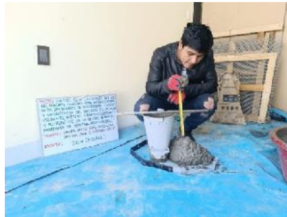
Figura 41 — Prueba de slump
