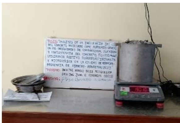
Figura 29 — Ensayo de peso unitario y vacíos de los agregados gruesos y finos
