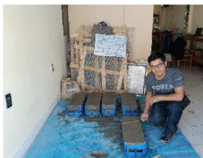
Figura 43 — Elaboración de viguetas de concreto
