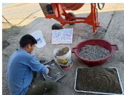
Figura 39 — Dosificación de materiales
