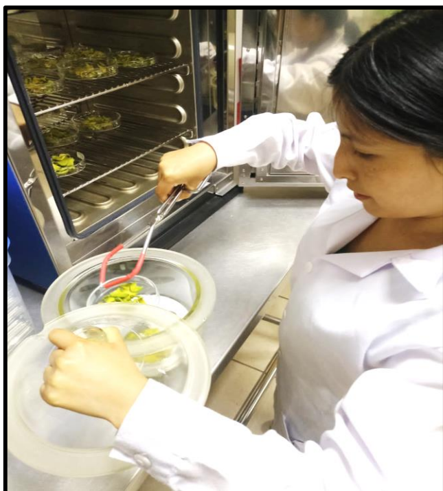
Figura 32 — Traslado de las muestras secas del fruto de la palta “Fuerte” y “Hass” de la estufa a la campana desecadora.
