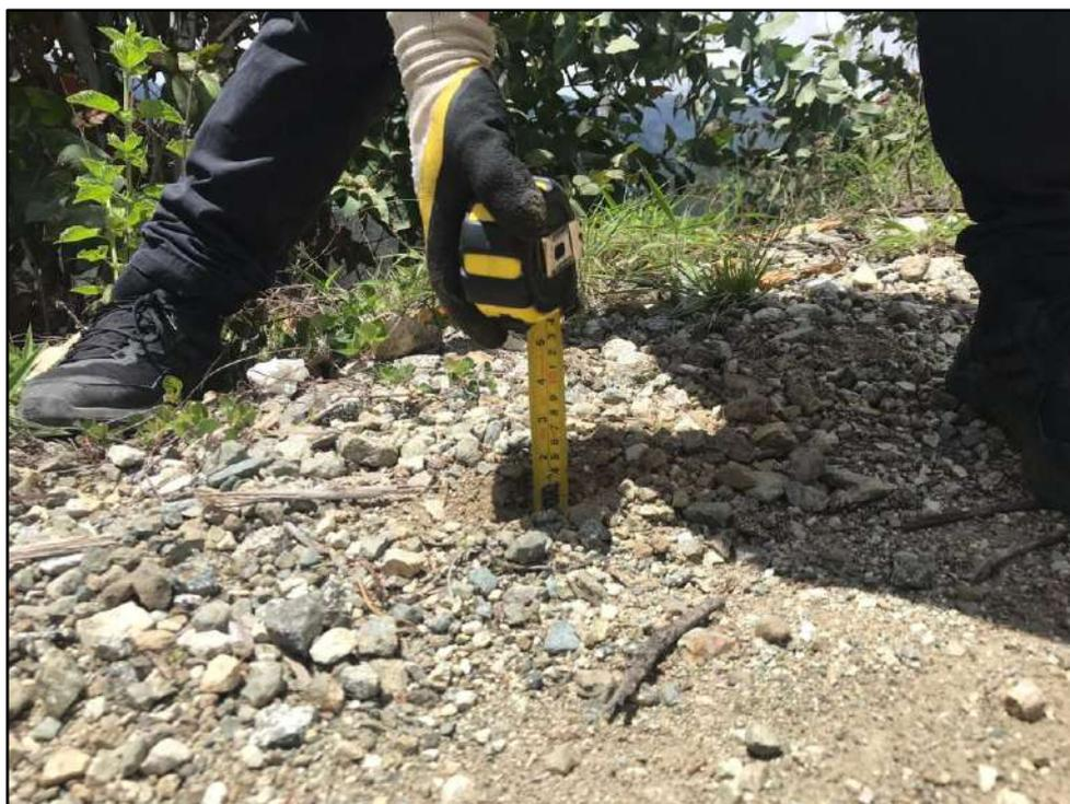
**Figura 83 — Medicion de fallas de agregado suelto para el analisis con la metodologia URCI**
