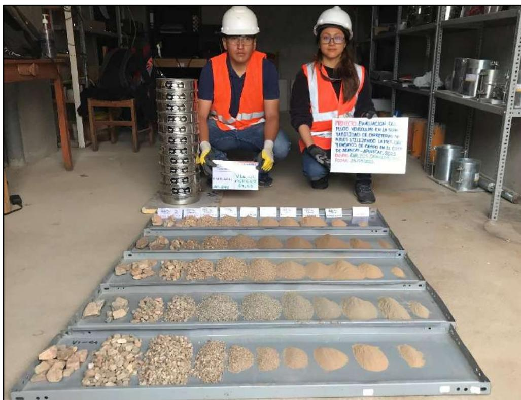
Figura 72 — Resultados del analisis granulometrico de las 5 muestras de la vía 3
