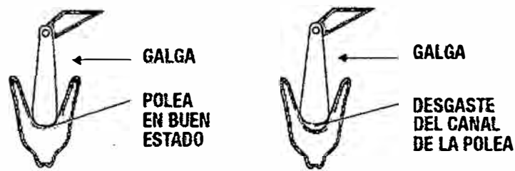
Figura N° 55. Desgaste y ángulo de contacto del cable y polea.
