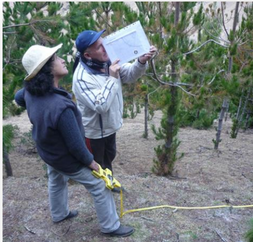
Imagen 08 (e y f): Obtención del ángulo con un clinómetro para hallar la altura del árbol.
