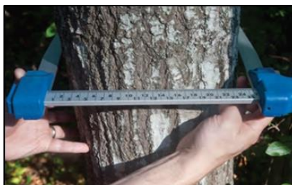
Figura 12: Midiendo el diámetro de un árbol con una forcípula.
